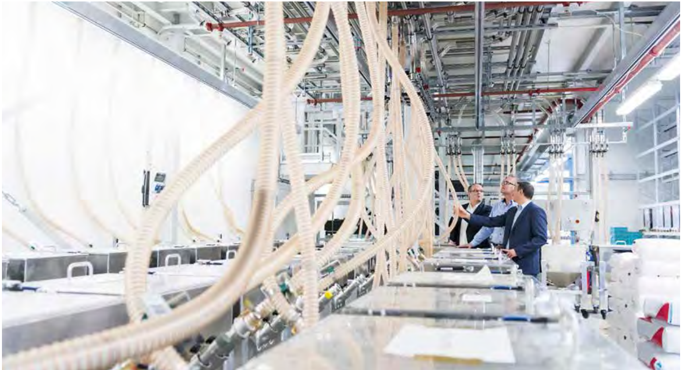
Transluzente Förderschläuche mit abriebverursachenden Medien in der Anwendung
