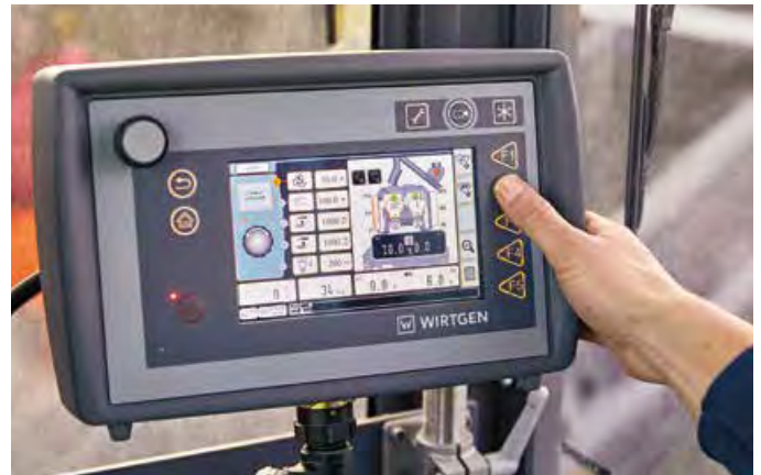
Effiziente Technik: Die Wirtgen Kaltrecycling-Mischanlage arbeitet dank mikroprozessorgeregelter Anlagensteuerung hochpräzise
