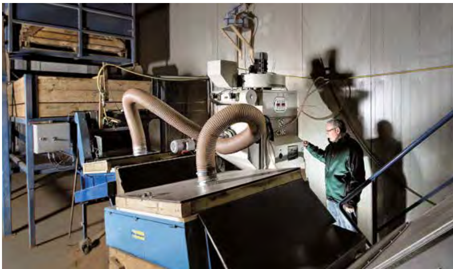
Dass sich die DS6-Anlagen auch für raue Betriebsbedingungen und gröbere Stäube eignen, zeigt ihr Einsatz an Kartoffelreinigungsanlagen (Bild 6) (Alle Bilder: Ruwac Industriesauger GmbH)
