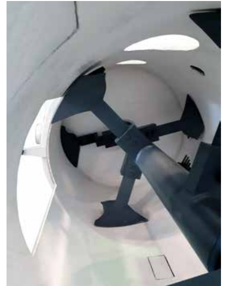
WBH Lithium 3000 mit Keramikauskleidung in der Mischkammer, Welle und Pflugschare aus Edelstahl mit Wolframcarbid-Thermospritzbeschichtung, Messerköpfe in K40 Wolframcarbid
