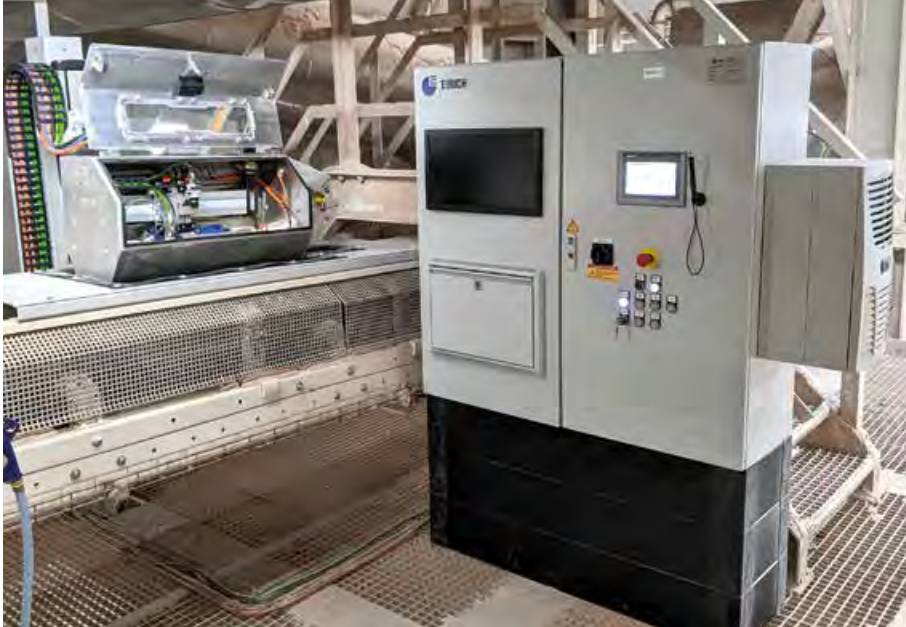
Eindrucksvolles Ergebnis der Kooperation Eirich – Pro시오 Engineering: der „Qualimaster VC1“, modernste Kameratechnik und KI-basierte Analysesoftware zur optischen Qualitätsbeurteilung von Granulaten
