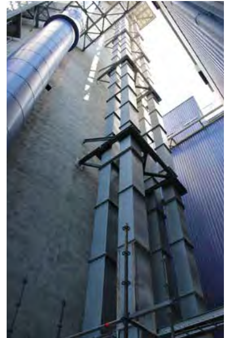
Für den vertikalen Transport pulverförmiger oder kleinstückiger Materialien liefert der Systemanbieter Hochleistungsgurtbecherwerke
