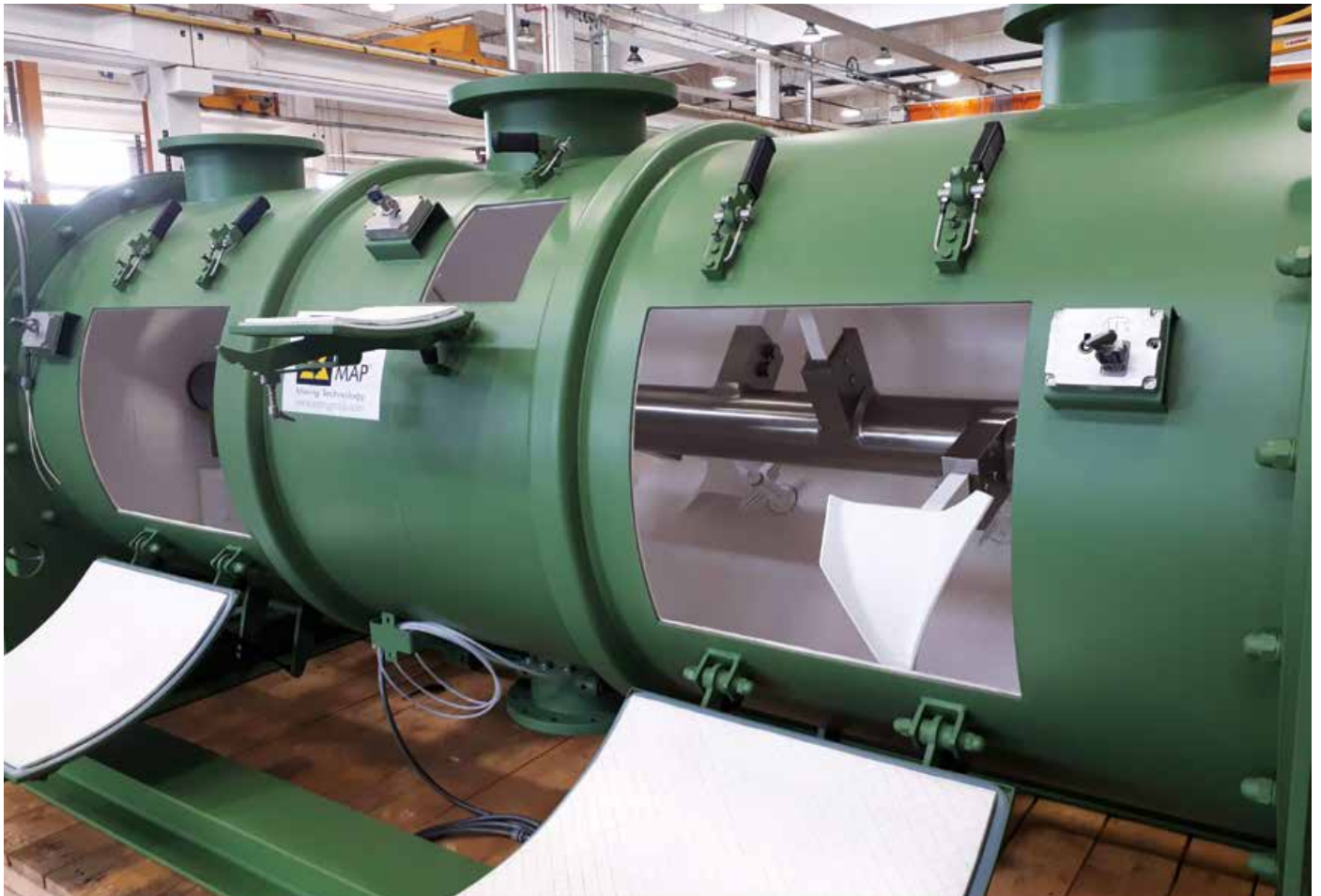
WBH Lithium 3000 mit Keramikauskleidung in der Mischkammer, Welle aus Edelstahl 316L, Pflugschare und Messerköpfe mit Keramik-Aluminiumoxid-Thermospritzbeschichtung
