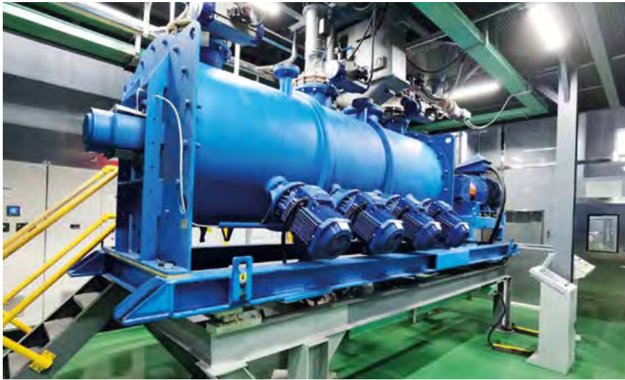
WBH Lithium 3000 für die Produktion von Aktiv-Kathodenmaterial Nickel NCM811
