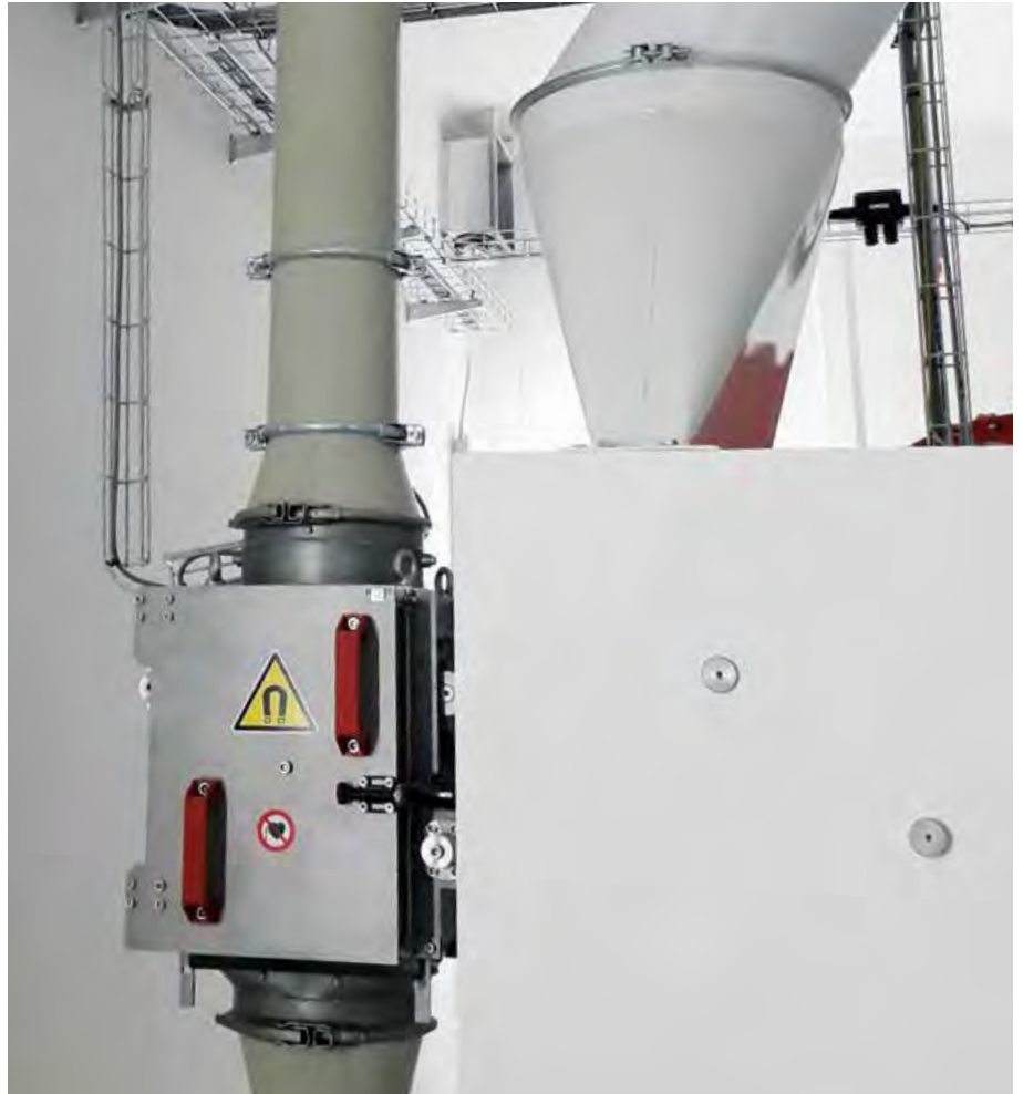
Permanentmagnet schleust Fremdpartikel aus dem Produktionsprozess
