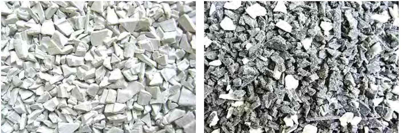
Bild 5: mit dem hamos EKS separiertes Mahlgut aus dem PVC-Fensterrecycling. Sortenreine PVC-Fraktion, links, und abgetrennte Gummi-Fraktion, rechts.
