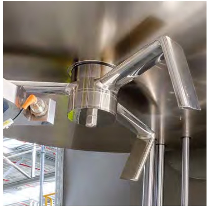
Das tragflügelartige Mischwerkzeug mit Winglets sorgt für ein gutes Ausbilden der Mischtrombe
