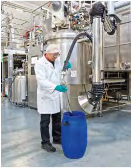
Oben: Hier schaffen die Saugarme der Absauganlage die Voraussetzung für ein staubfreies Eindosieren von pulverförmigen Inhaltsstoffen für Hautpflegeprodukte in die Mischanlagen
