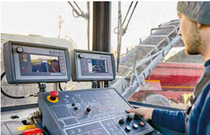
Auf dem Hauptbedienpult der KMA 240(i) hat der Bediener das Materialfließschema, den Maschinenstatus und den gesamten Produktionsablauf jederzeit im Blick
