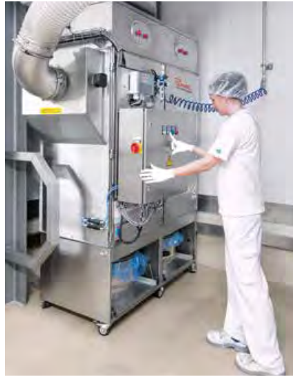
Oben: Hier schaffen die Saugarme der Absauganlage die Voraussetzung für ein staubfreies Eindosieren von pulverförmigen Inhaltsstoffen für Hautpflegeprodukte in die Mischanlagen
