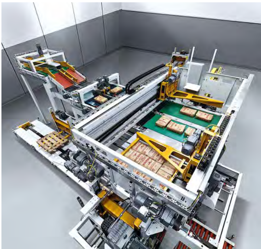
Der Hochleistungslagenpalettierer BEUMER paletpac palettiert pro Stunde bis zu 5.500 Säcke – flexibel, genau und stabil
