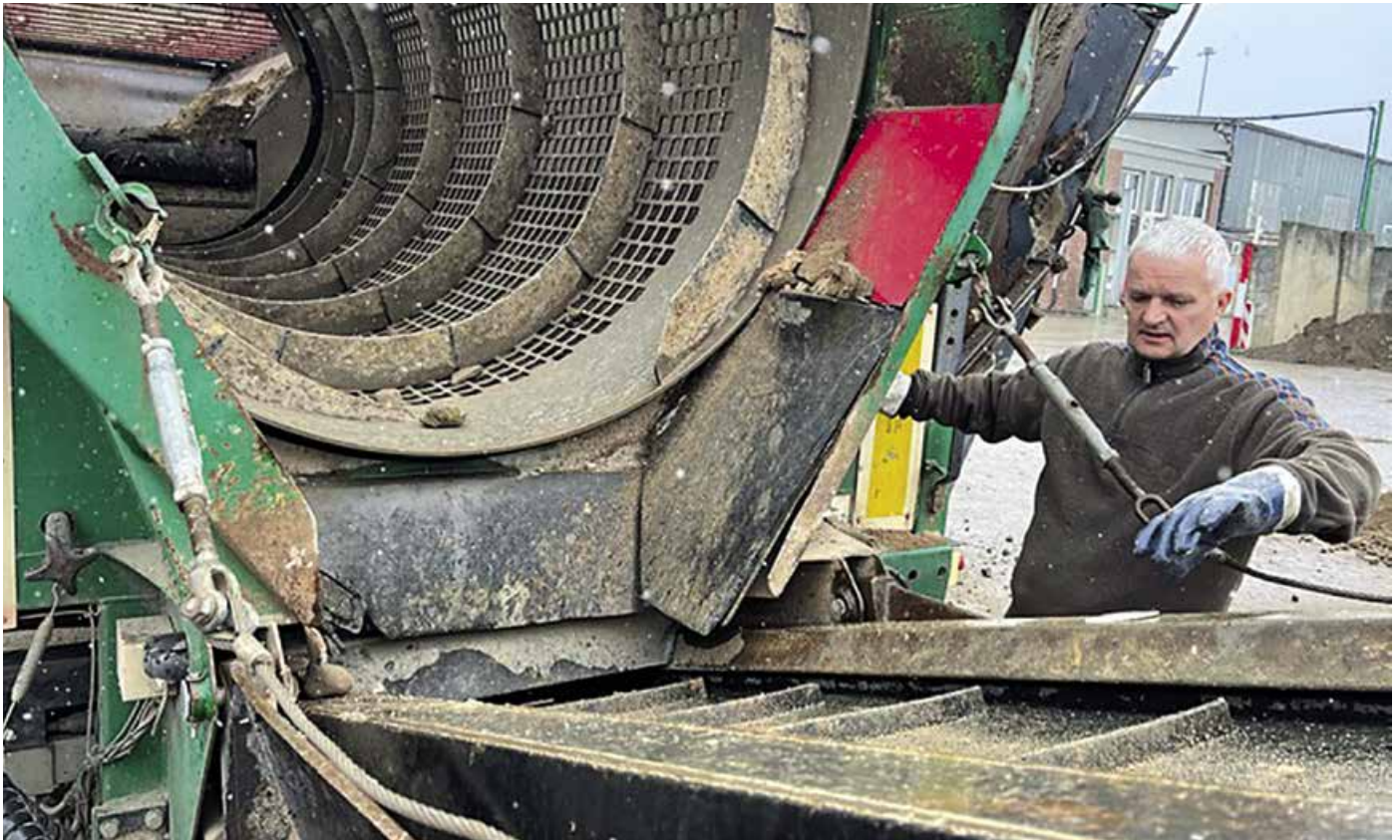
Eine Trommelsiebung in der Betonindustrie hat eine Verschleißbeanspruchung und produziert im Betrieb auch Lärm
