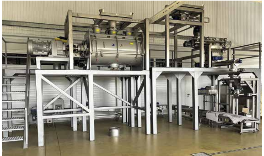
oben: „MODUL-FLEX®“ Misanlage nach Kundenwunsch zusammengestellt
