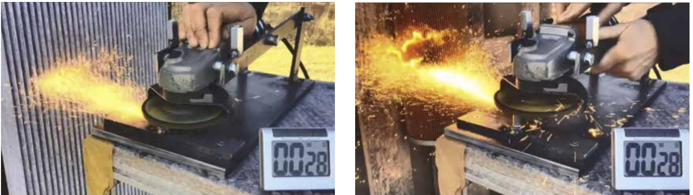
Bild 4: Entzündbarkeit: Herding Sinterlamellenfilter im Vergleich mit Patronenfilter
