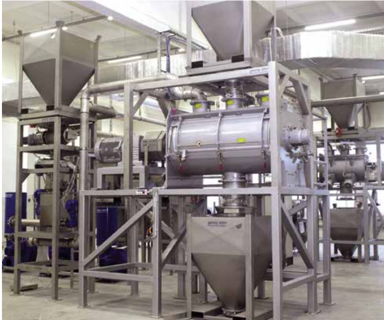
Mischanlage und semiautomatische Abfülllinie
