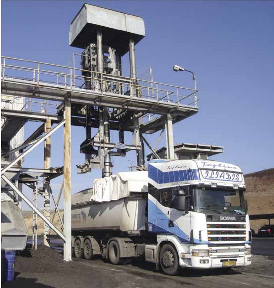
Eine Lkw-Ladung wird beprobt. Die Bohrschnecke taucht in die Materialschüttung ein
