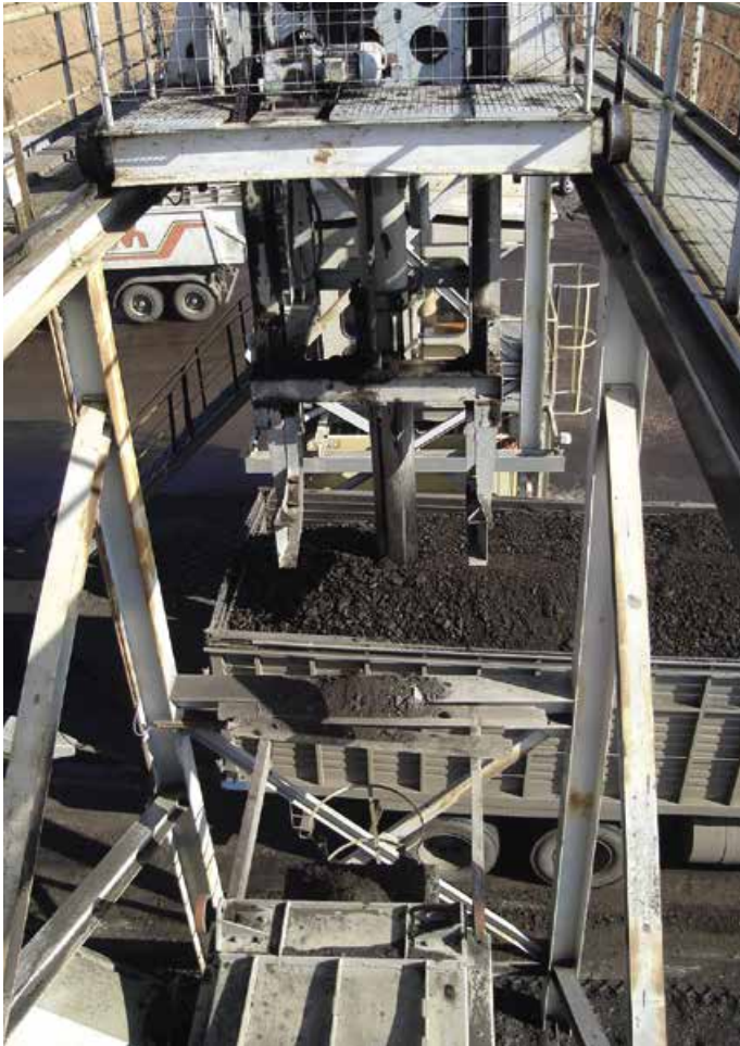
Im Probenaufbereitungsgebäude: Übergabe zwischen Steilförderer und Zerkleinerungsgerät (Stufe 1)
