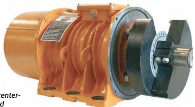
**Bild 8:** Elektrische Rotationsvibratoren sind vergleichbar mit einem Elektromotor an dessen Wellenenden Exzentergewichte angebracht sind
