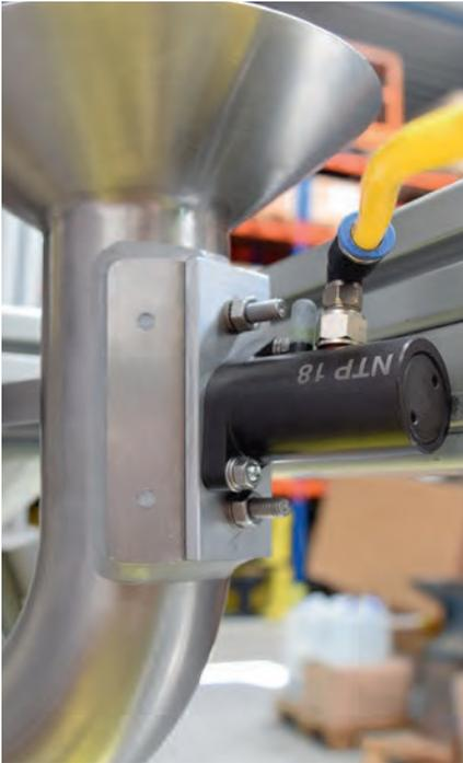
*Pneumatischer Kolbenvibrator inkl. NKK an rundem Trichterauslauf*
