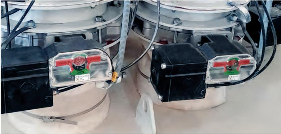
*Drehklappe mit pneumatischem Antrieb*
