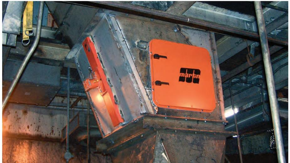
*Bild 6: Ein Kolbenvibrator sollte auf einer Stahlprofilhalterung montiert werden, die auf der Schurreaußenseite an der Stelle angebracht ist, wo der Materialaufbau vorliegt*
