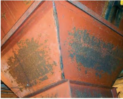
**Bild 3:** Das Einschlagen auf die Bunker- oder Schurrenwandung mit einem Hammer führt zu einer Beschädigung der Wandungsfläche
