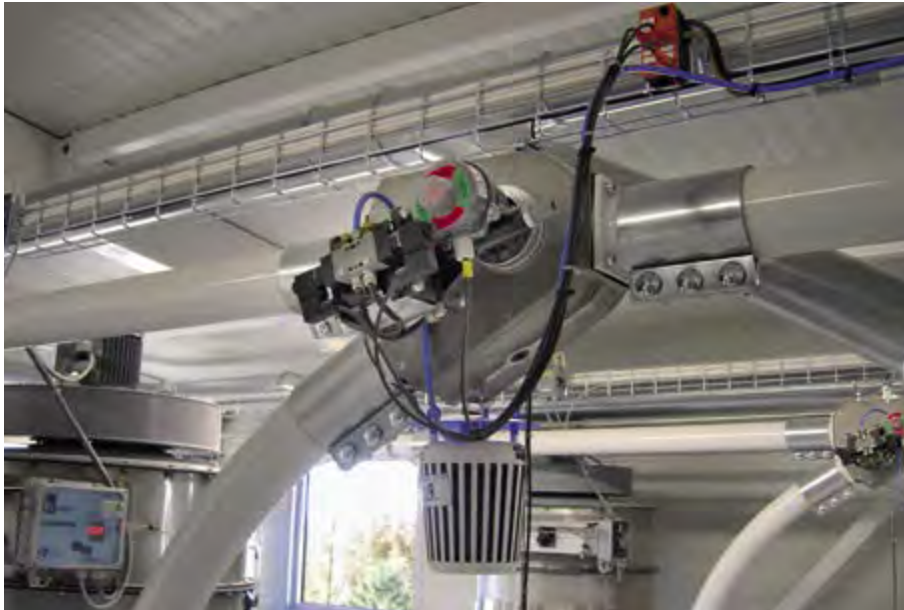
Rohrweiche VAD in der Mehlherstellung
