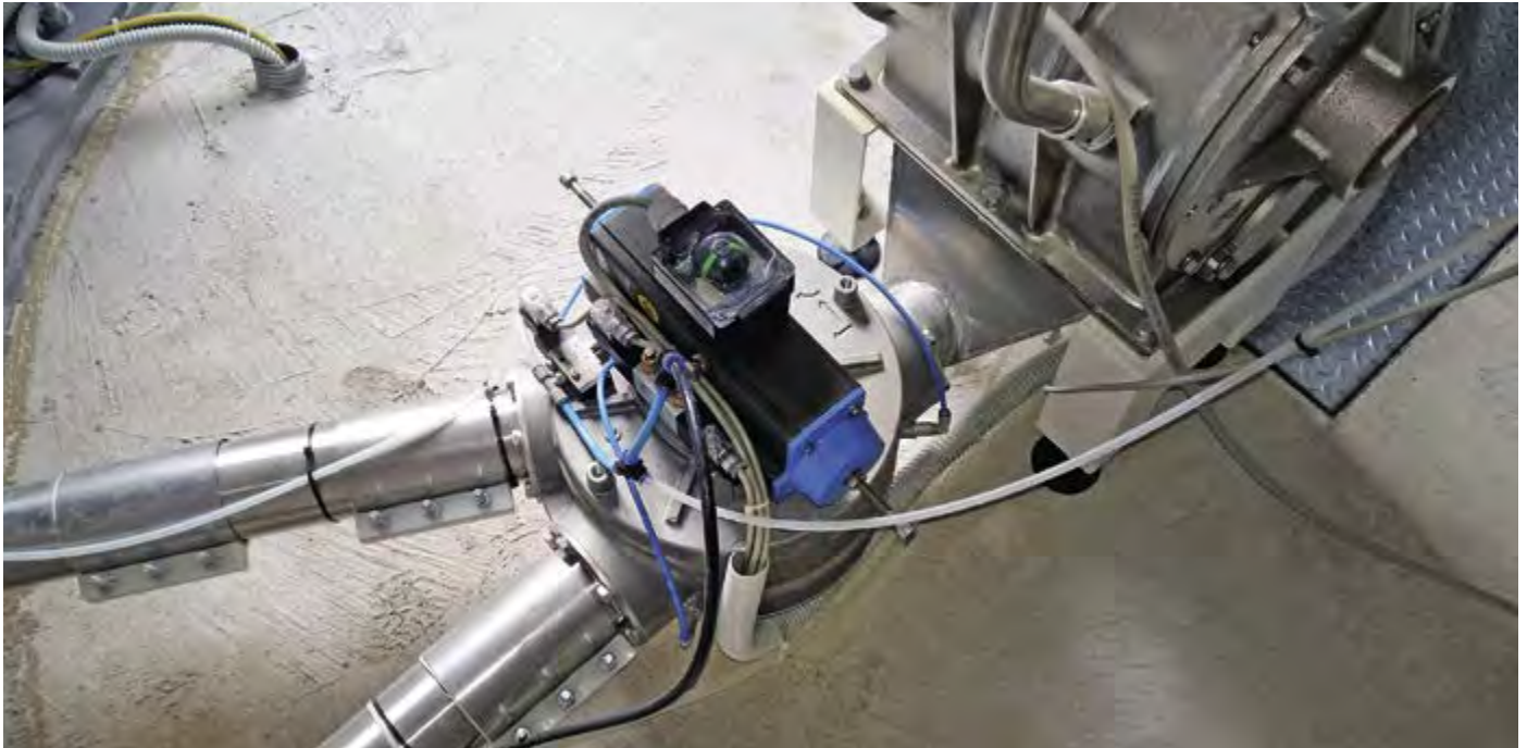
Trommelrohrweiche VAR in der Kunststoffverarbeitung
