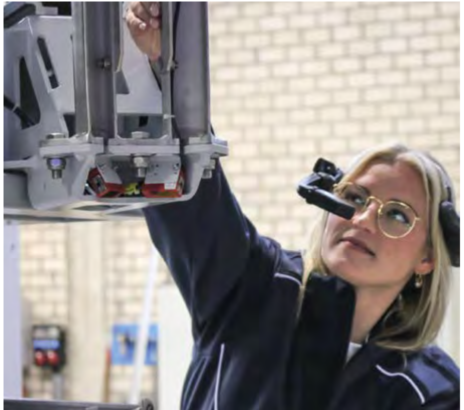
Die Digitalisierung nimmt weiter zu: Mit den Smart Glasses sieht der BEUMER Customer Support das Gleiche wie der Träger vor Ort und kann den Kunden die richtigen Handgriffe direkt vorgeben.
