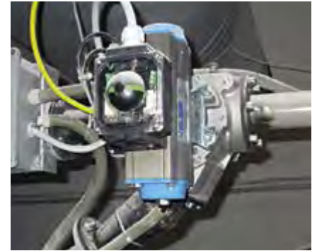
Rohrweiche VAS in der Mehlherstellung
