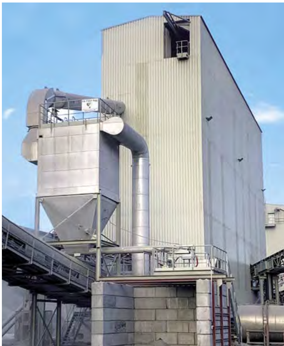
In der Entstaubungsanlage (vorne) werden Staubteilchen aus der Siebtrocknung herausgefiltert und abgeschieden, Bild: FB Filter Bau GmbH
