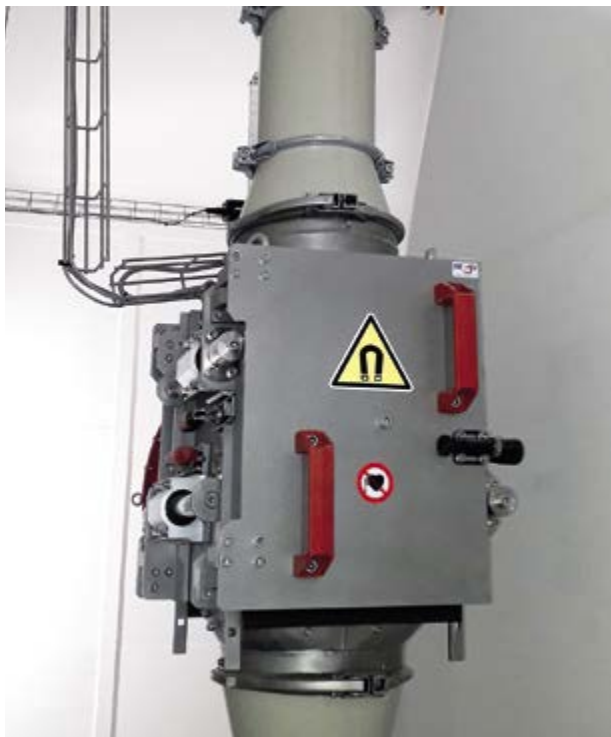
Permanentmagnet schleust Fremdpartikel aus dem Produktionsprozess aus
