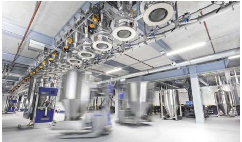
Transport der Container im Daxner Container System DCS: von konventionellen Rollen- und Kettenbahnen über abgehängte Systeme, Portalkranlösungen, laser-gesteuerte fahrerlose Transportsysteme (FTS) bis hin zu mehrdimensionalen Container-Transportsystemen mit integrierter Hubeinrichtung (Regalbediengerät RBG)
