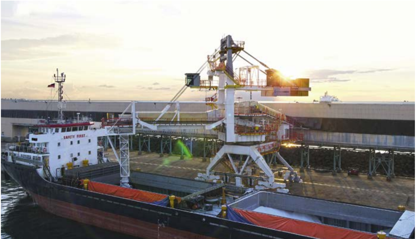
Schiffsbelader sorgen im Hafen für eine schnelle und zuverlässige Beladung der Schiffe mit Schüttgut – etwa Harnstoffdünger
