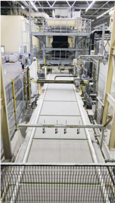
Gipsfaserplatten bestehen im Wesentlichen aus Cellulosefasern und Naturgips
