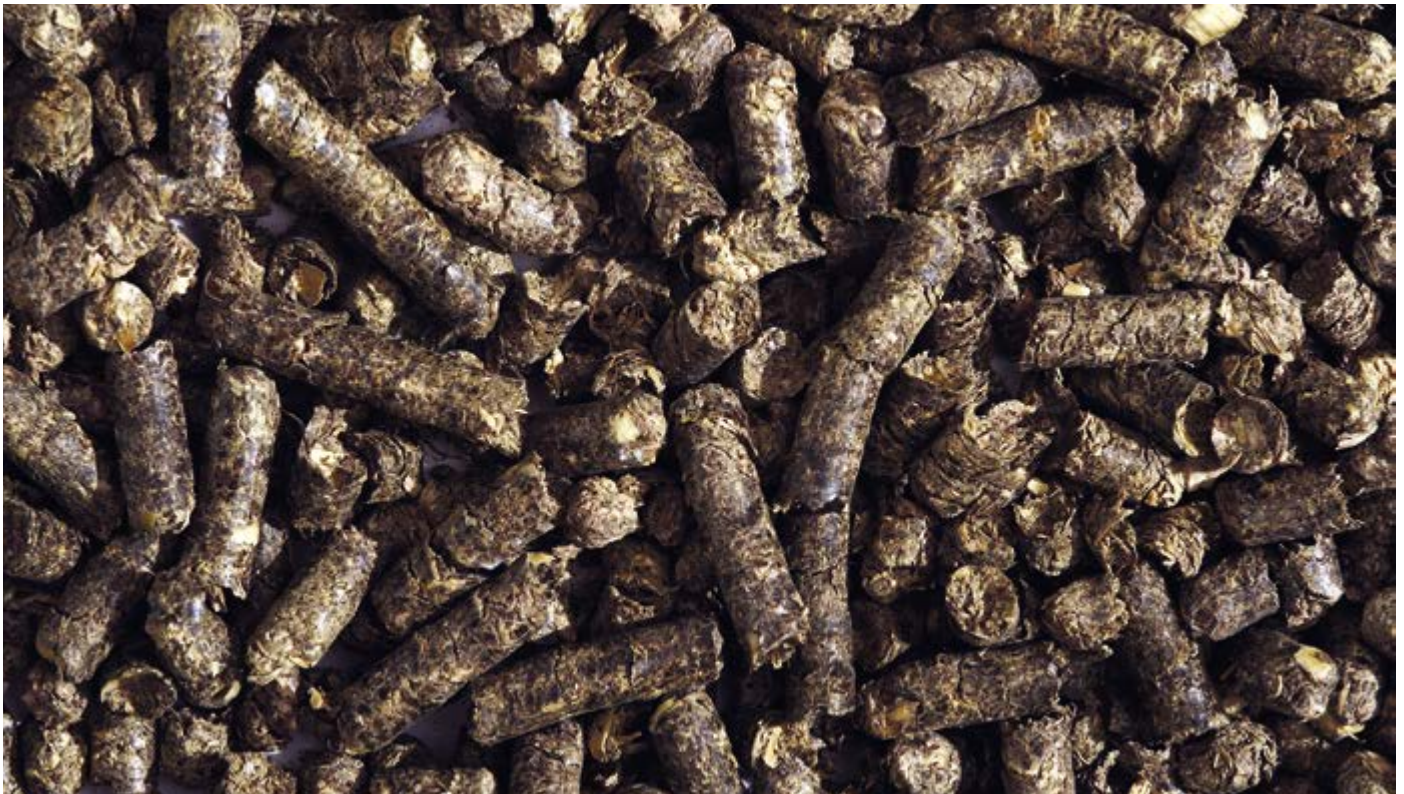
Klärschlamm pellets für die Industrie
