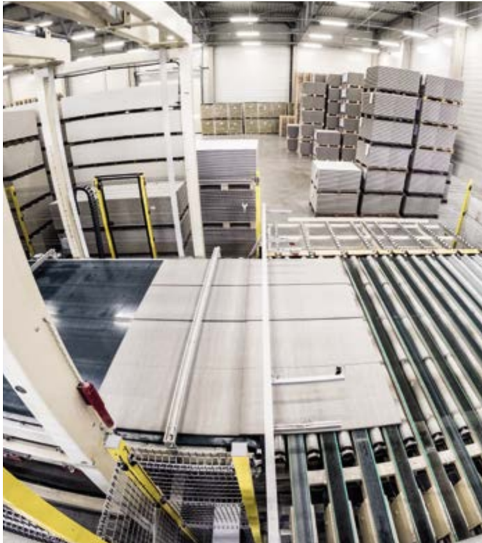
Die Gipsfaserplatten kommen nach dem Abbinden zum Trocknen in die Ofenstraße
