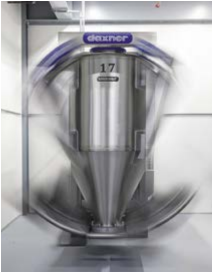
Container-Mischer für das Mischen einer Charge von Komponenten im Container (© Fotos: Daxner GmbH)
