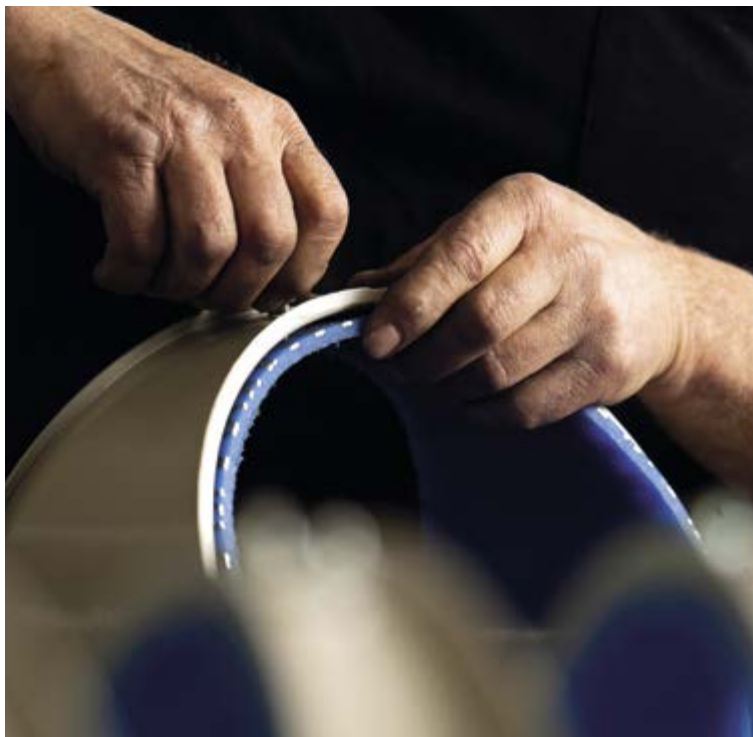
Der Verschleißschutz im Rohr kann geschraubt oder geklebt werden
