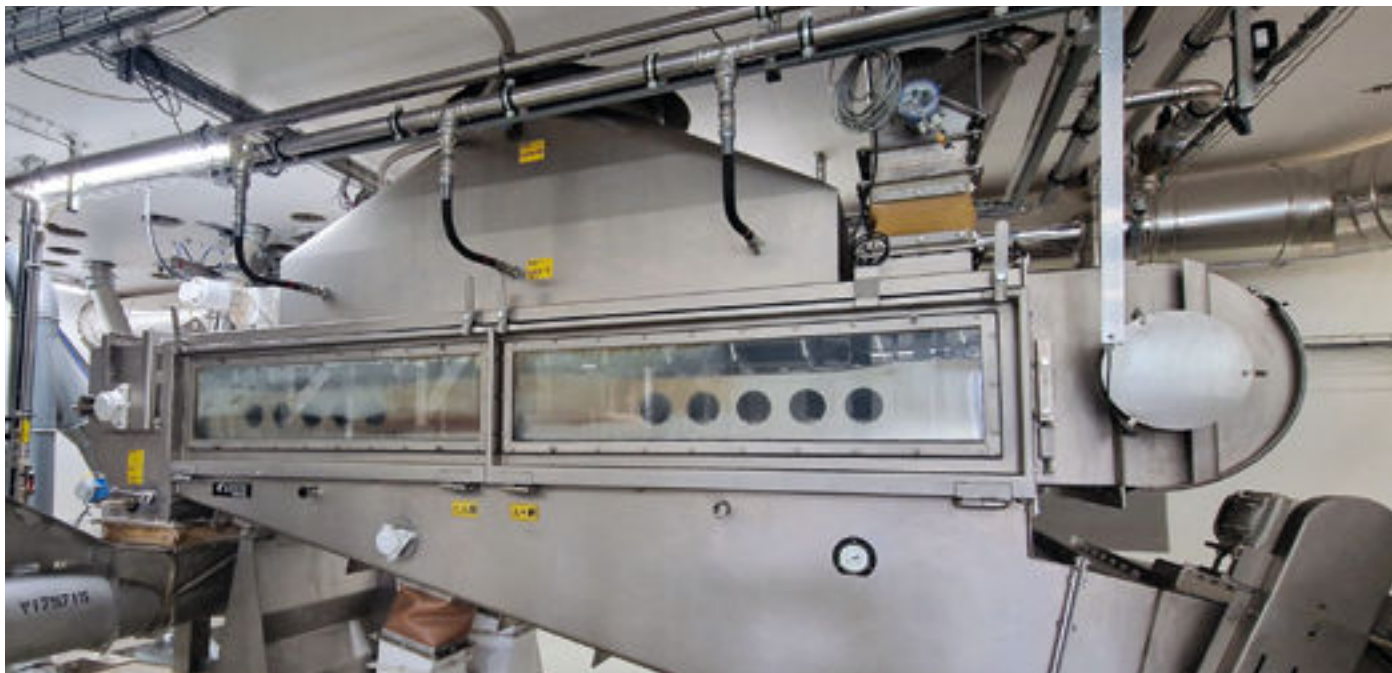
Vorröster mit Absaugung – bei sehr hohen Temperaturen werden hier zum Beispiel Getreideflocken getrocknet
