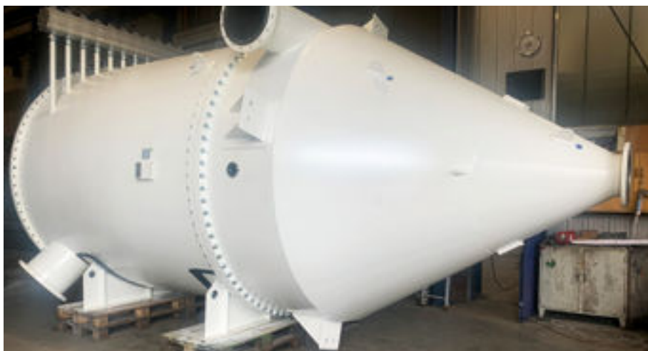
Infastaub-Schlauchfilter in druckstoßfester Bauweise für vollen Explosionsdruck
