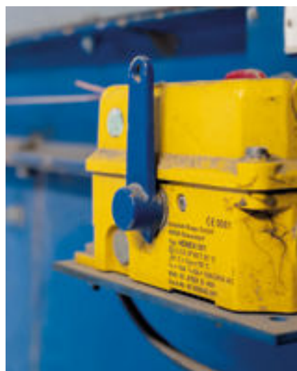
Einer von mehreren Seilzugnotschaltern von Kiepe Electric bei E.ON. Unabhängig davon, wie oft die Reißleine beim Betrieb des Förderbands überhaupt schon gezogen werden musste, sind die Schalter auch nach über einem Jahrzehnt funktions-tüchtig.
