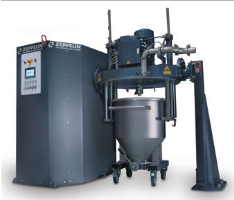
Ausgestattet mit ATEX-Zertifizierung, geliefert mit überwachter Erdung – die Containermischer von Zeppelin sind den Anforderungen staubexplosiver Stoffe gewachsen
