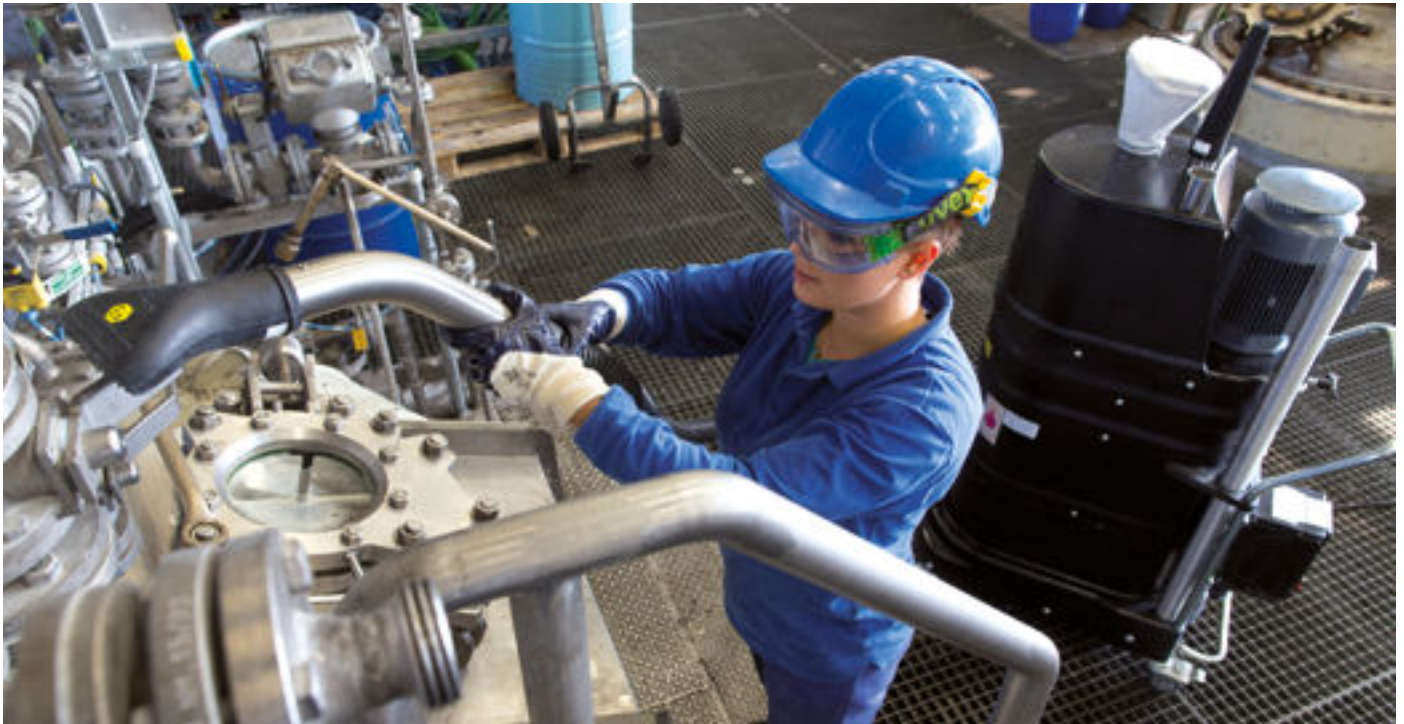
Bild 1: In einigen Anwendungsfällen insbesondere in der Chemieindustrie wird von Saugern ein kombinierter Gas- und Staubexplosionsschutz gefordert
