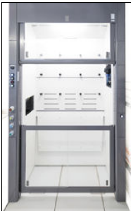
Begehbarer Abzug in Ex-Schutz-Ausführung
