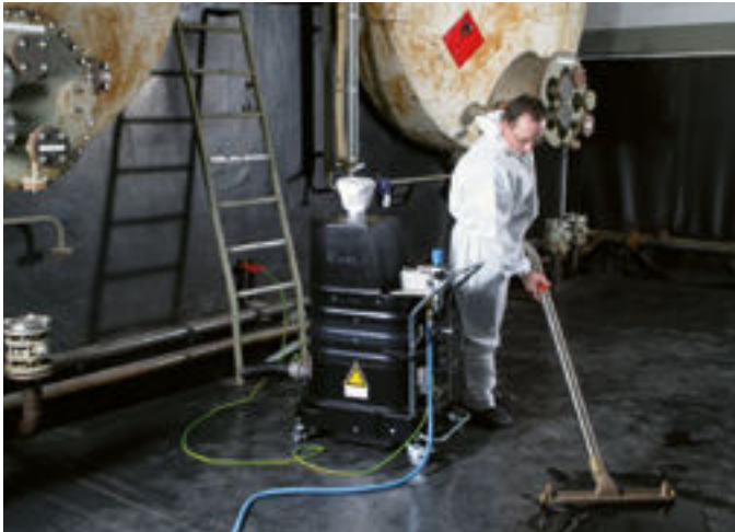
Bild 4: Die permanente Erdung ist ein weiteres Sicherheitsmerkmal von Ex-Saugern
