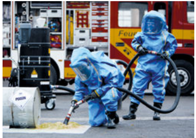
Bild 5: Ex-Sauger können auch z. B. als „Gefahrgutsauger“ für das Aufsaugen von toxischen Stäuben ertüchtigt werden
