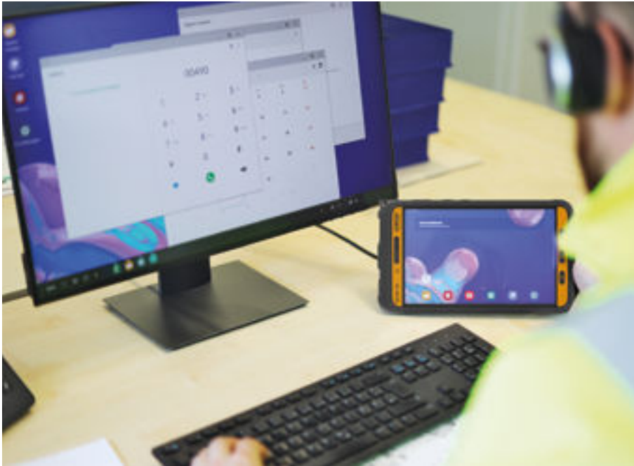
Mithilfe der Desktop-Funktion können Nutzer ihr Tablet oder Smartphone an einen großen Bildschirm und eine Tastatur anschließen und es als Desktop-Variante nutzen. So wird aus dem mobilen Device für den Feldeinsatz schnell und einfach ein Gerät für das Büro oder Homeoffice. (Foto: ECOM Instruments)
