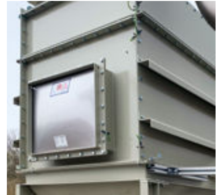
Entlastung über Berstscheiben eines Infaustaub-Taschenfilters
