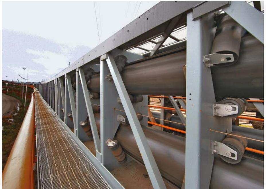
*Das System wird innerhalb einer geschlossenen Galeriestruktur installiert, um die Wartung während der Wintermonate zu erleichtern*
