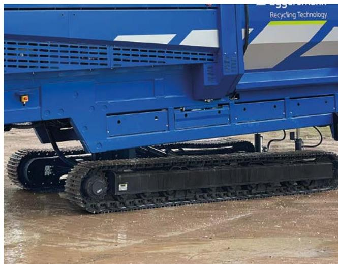
*Das neue Kettenfahrwerk mit Dreisteg-Stahlbodenplatten und Gefällekompensierung von bis zu 7 % sorgt für zusätzliche Sicherheit und Flexibilität*
