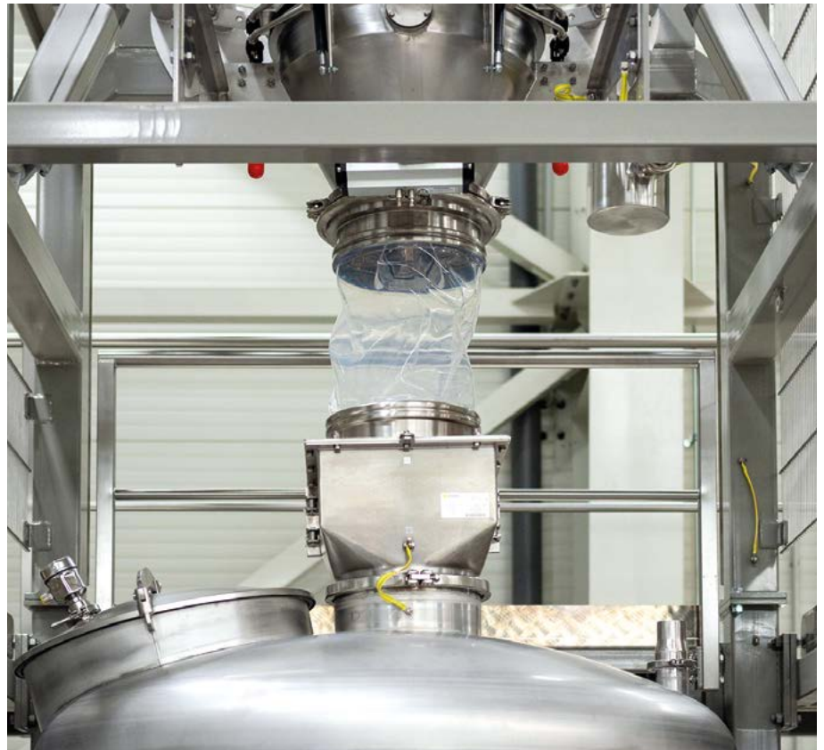
Big Bag-Entleerung mit Anschlussystem für ein leichtes, ergonomisches und vor allem sicheres Austragen von Pulvern
