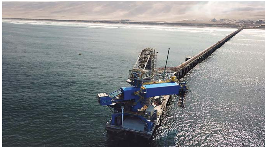
Das Kupfererz gelangt über eine Förderanlage vom Festland zum Schiffsbelader
