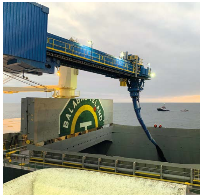
Über ein schwenkbares Teleskoprohr gleitet das Material nach unten in den Laderaum
