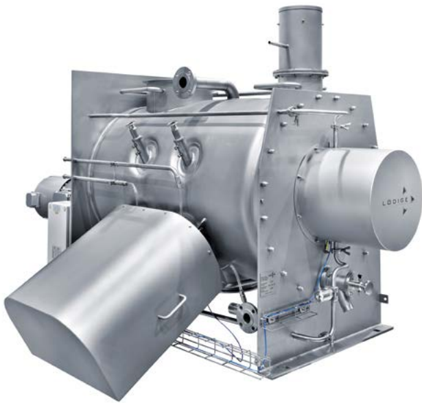
Lödige Pflugschar-Mischer Typ FKM 600D mit Heizmantel zum Temperieren des Produkts im Hygienic Design (Washing-in-place) (Quelle: Lödige)
