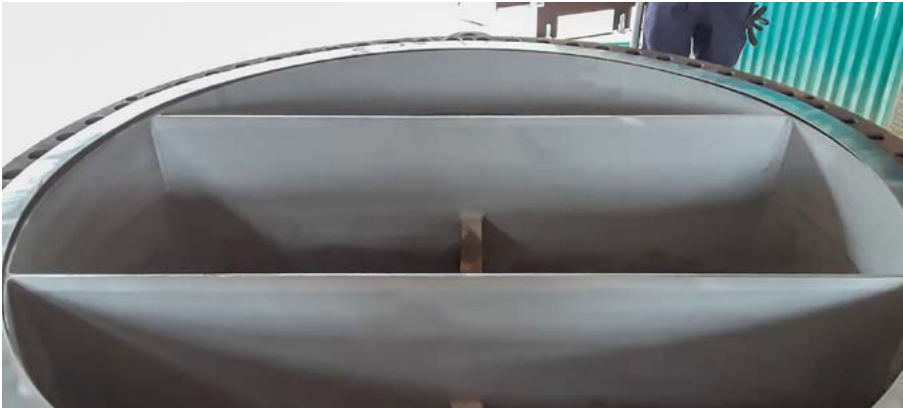
Castolin XuperoniClad auf rohrförmigem Wärmetauscher in chemischem Werk aufgebracht
