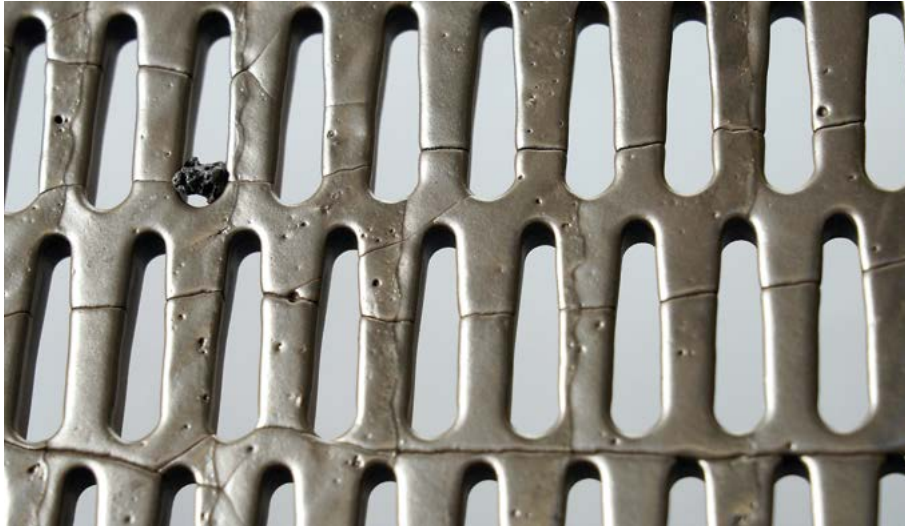
Siebe mit verbessertem Verschleißverhalten verlängern die Produktionsleistung und optimieren die Lebensdauer
