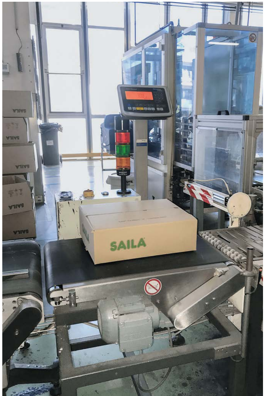
Das Wäge- und Auswahlsystem Essentus® sorgt dafür, dass alle Schachteln die richtige Anzahl an Süßwarenpackungen enthalten
