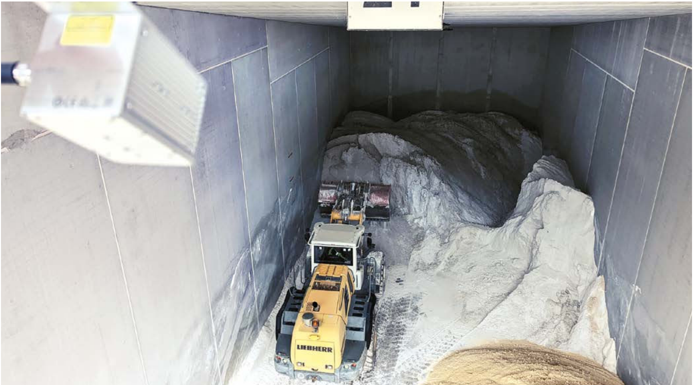
Owl Eye wacht über die Schüttgutbestände eines überdachten Außenlagers
