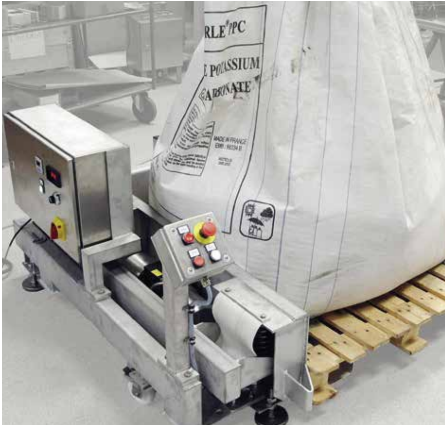
Die Ware verteilt sich durch das Rütteln optimal im Big Bag
