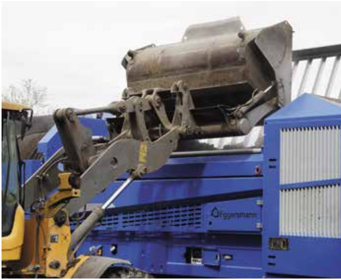
Der 25% größere Aufgabebunker macht die Materialaufgabe noch einfacher
