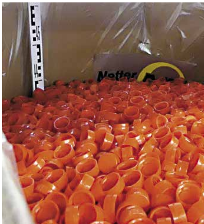
Durch das Schütteln lassen sich 20% mehr Verschlüsse verpacken
