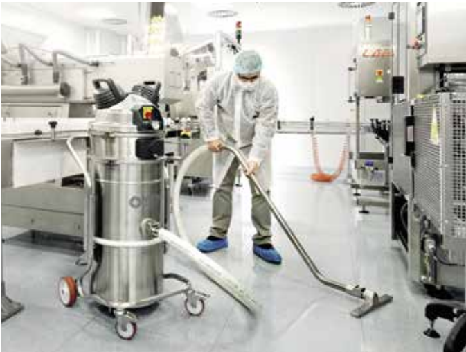
Der 37 Liter fassende Edelstahlbehälter nimmt nasse, trockene oder ätzende Substanzen auf
