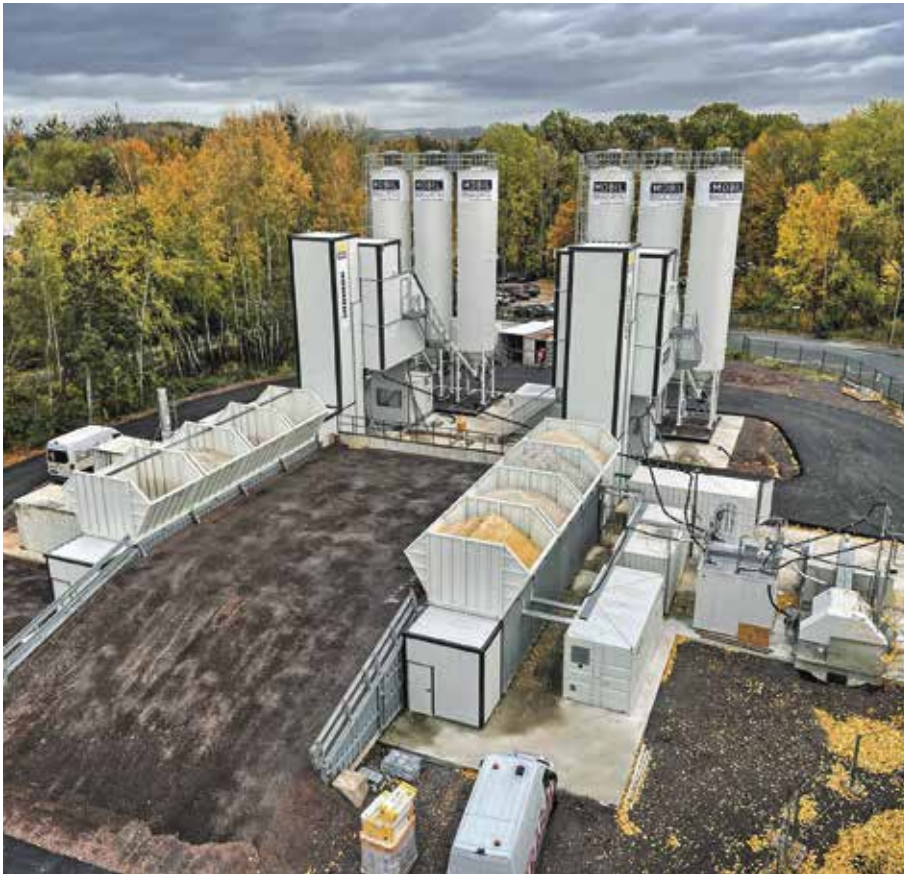
Die Doppel-Betonmischanlage von Liebherr ist flexibel und kann ohne weiteres von einer Baustelle zur nächsten umgesetzt werden
