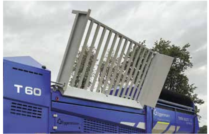
Durch das QuickChange System ist künftig eine besonders schnelle und einfache Montage des Steingitters gewährleistet
