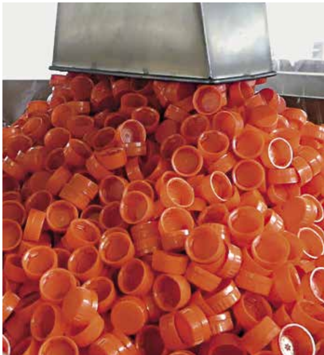
Schüttkegel von Kunststoffverschlüssen am Auslaufstutzen der Füllstation
