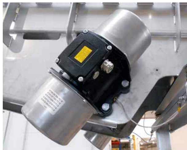
ATEX-konforme Vibrationstechnik ist entsprechend konstruiert und geprüft
