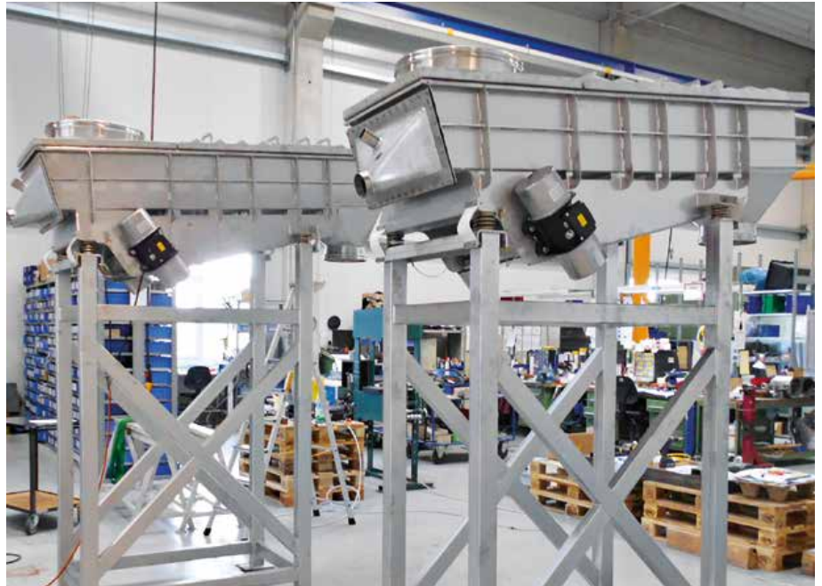
Zwei maßgeschneiderte Edelstahlrinnen für ATEX Zone 2
