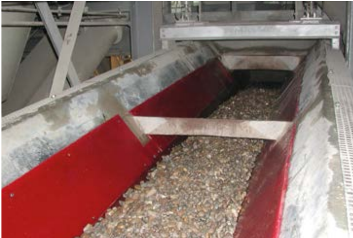
Die Materialführung für Förderbänder schützt die Seitenführung der Bänder und gewährleistet einen gleichmäßigen Materialfluss
