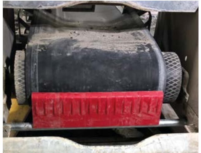
Der Kopfabstreifer bietet eine gurtschonende Förderbandreinigung und eine hohe Lebensdauer des Förderbands
