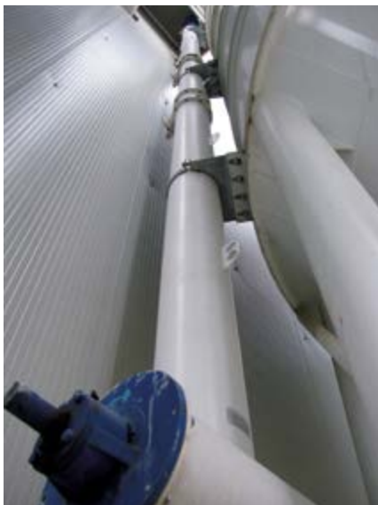
Vertikales Schneckensystem für die Senkrechtförderung von Pulvern
