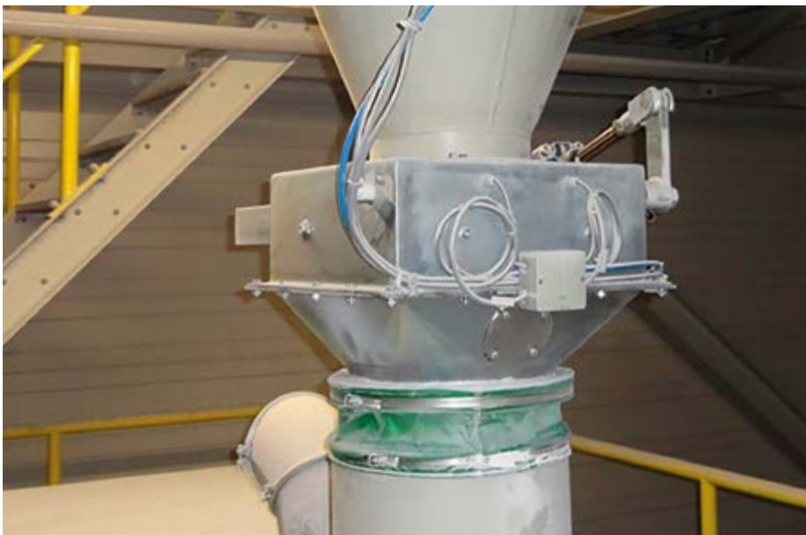
Freifluss-Klappenverschluss mit DN 250 (KV250E) in der Glasindustrie
