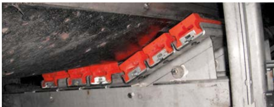
Martins Prallschutzwiege absorbiert die Kraft von fallendem Material und Objekten
