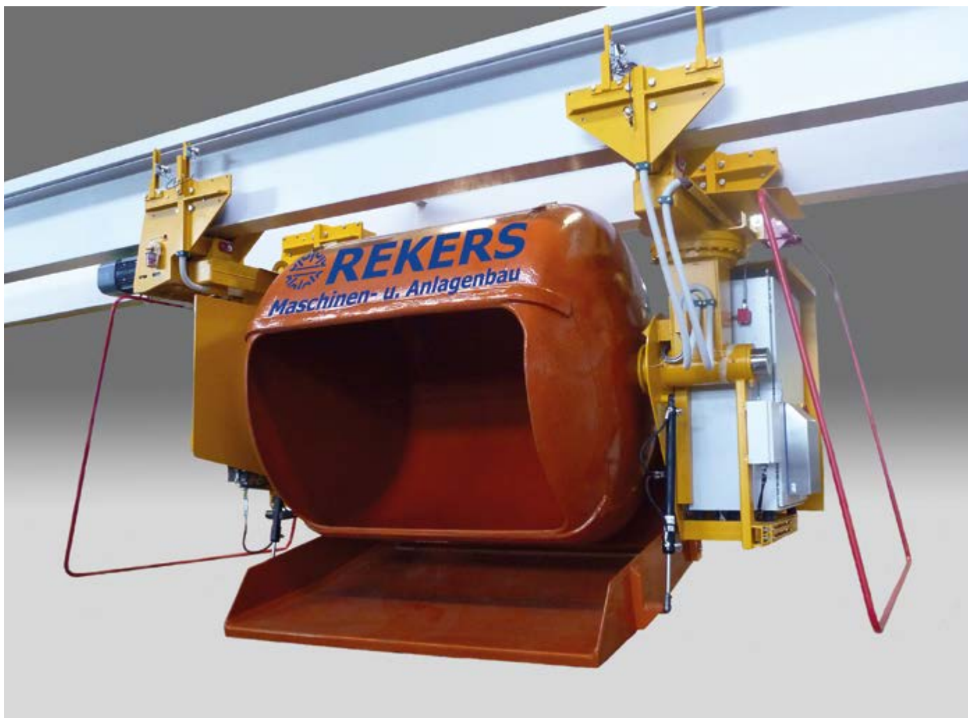
Rekers Drehkübel und Schurre beschichtet mit Kobaflex V80
