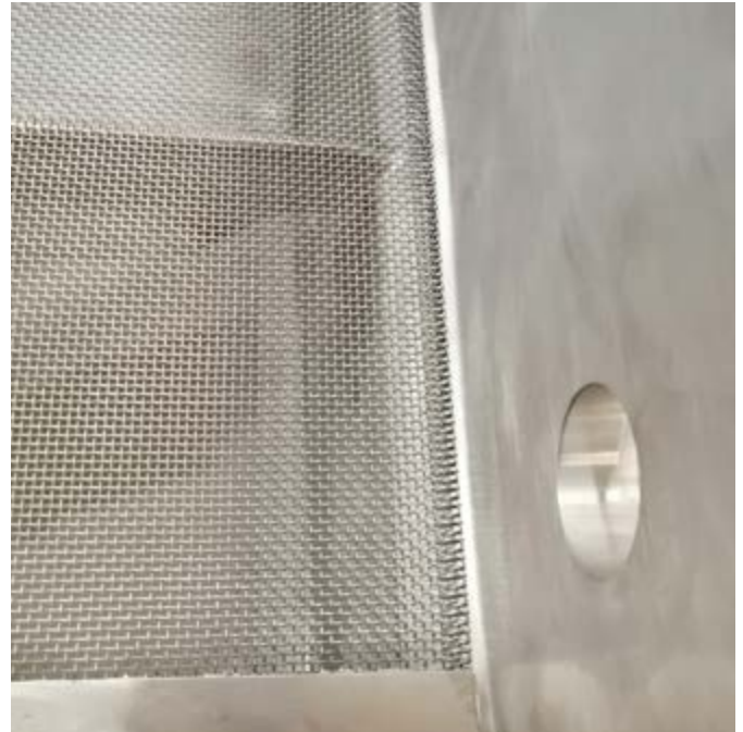
Detailansicht der glatten Innenseite der Siebmaschine mit dem dichtungsfreien Sieb und der sauberen Montage der CIP-Düsenhülse
