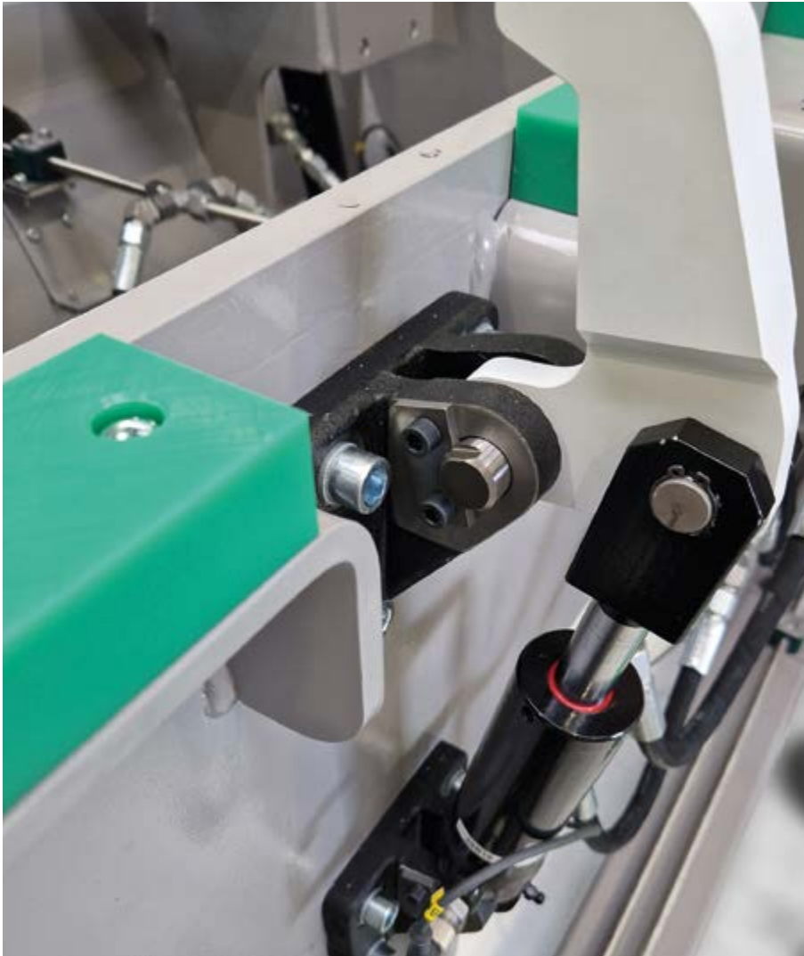
Hydraulische Spannarme fixieren die Formen auf dem Tisch
