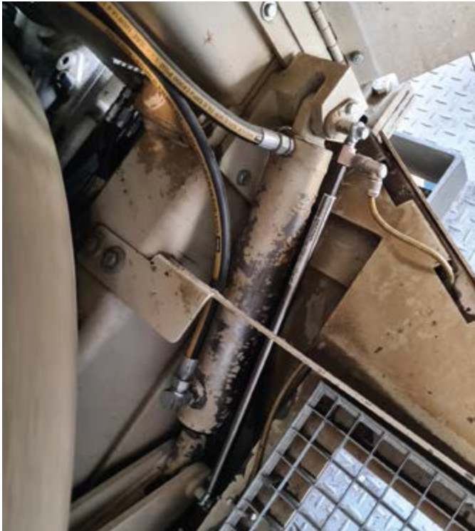
Der analoge TWIIST-Sensor LS-A regelt die Hydraulik an der Auslassklappe eines Betonmischers (Bild: GEFRAN)
