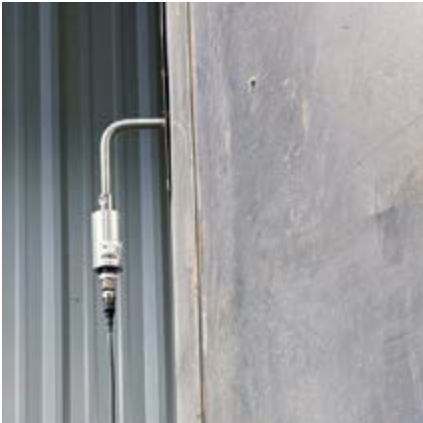
Abbildung 2: Ultraschallkonverter am Sprühtrockner
