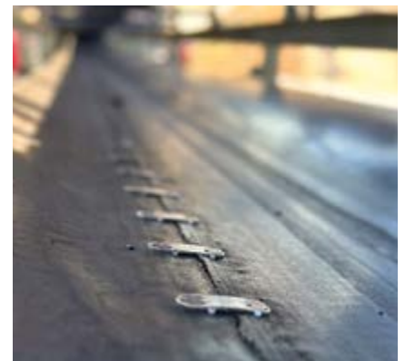
Mit dem Rip Repair Set ist die Rissreparatur schnell erledigt
