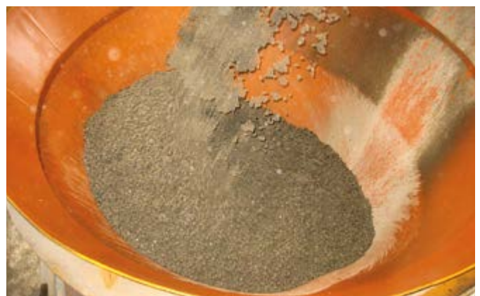
Beton-Tagessilo, beschichtet mit Kobaflex V80
