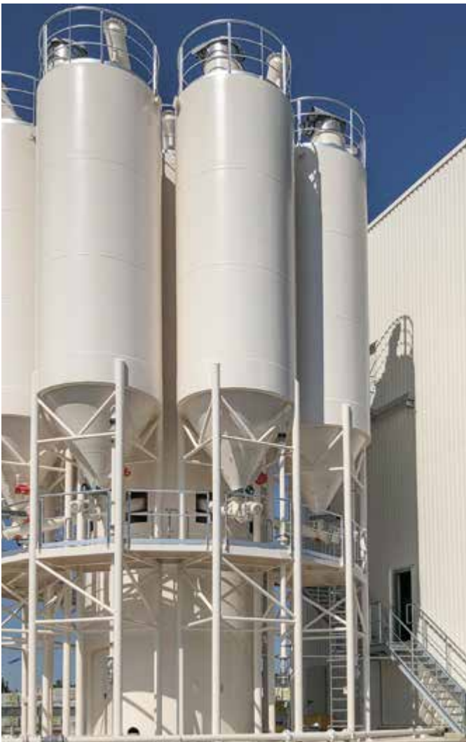
Die Silomodulanlage von OAS lässt sich flexibel auch nachträglich an bestehende Produktionsanlagen anbauen
