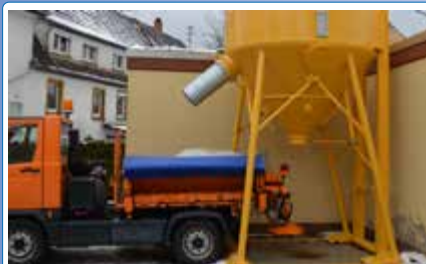
• Silo für den Winterdienst
