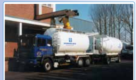
• Silos unter LKW Befüllstation
