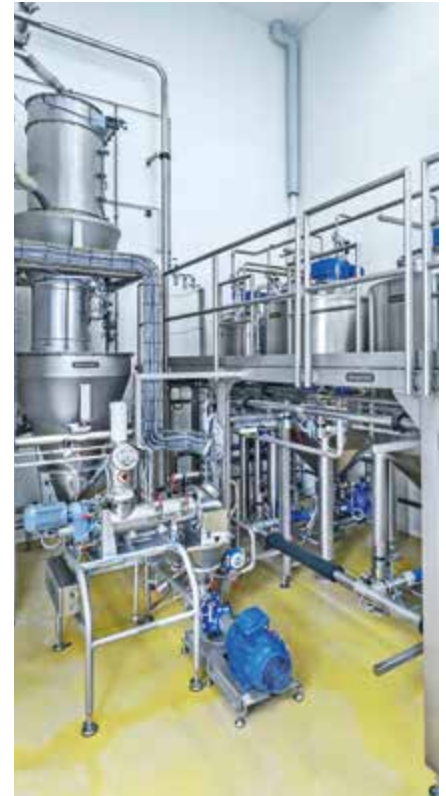
Kontinuierlicher Anteiger daxDou zur Herstellung von Vorteigen
