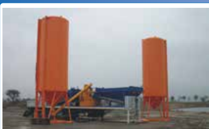
• Silos für Mischanlagen
