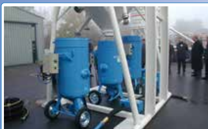
• Silos für Sandstrahlanlagen
