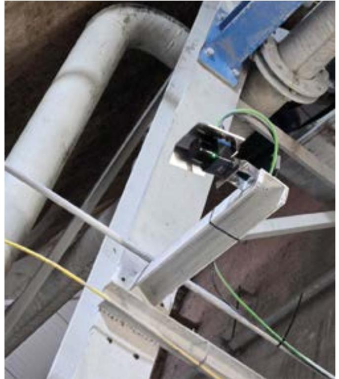
*Owl Eye LiDAR-Sensor zum Erfassen von Schüttgut*
