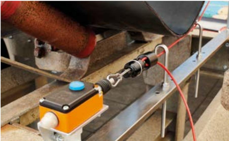
*Das neue Bandrissüberwachungssystem erkennt frühzeitig einen Riss im Fördergurt und minimiert damit Folgeschäden*
