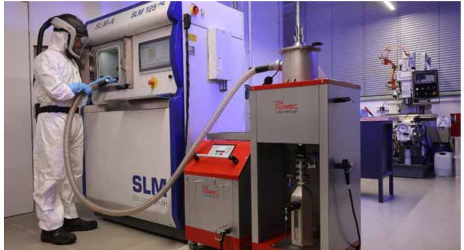
*Der Test bei Rapidobject beweist: Mit dem neuen Trocken-Vorabscheider R26 (rechts) lassen sich mehr als 90 % des Metallpulvers wiederverwenden*
