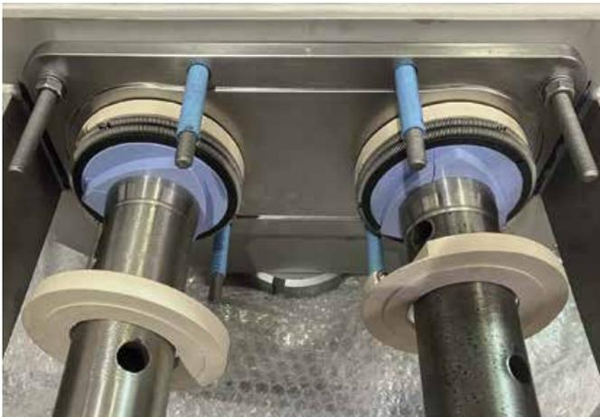
Abb. 7: Doppeldichtung vereinfacht die Montage, den Wechsel und die Reinigung der Dichtung um ein Vielfaches
