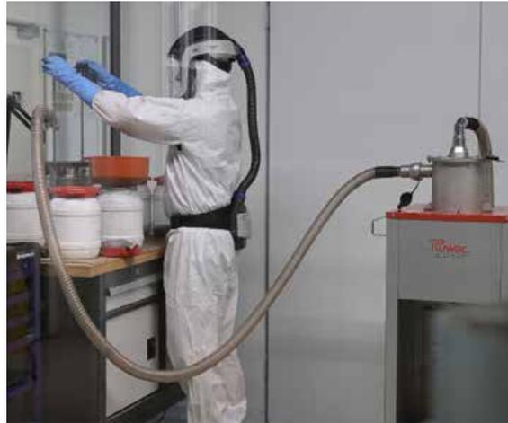
*Das vorabgeschiedene Material wird trocken gesammelt und kann gesiebt und der Wiederverwertung zugeführt werden*
