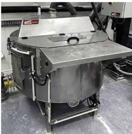
Con-Tec, ein erfahrener Hersteller von Förderschnecken und langjähriger Partner renommierter Unternehmen der Schüttgutindustrie, hat bei einem Kunden in Aubagne eine neu entwickelte Entpack- und Dosierstation für stark verdichtete Materialien installiert. Die Anlage wurde als schlüsselfertige Lösung konzipiert und umgesetzt. Die Anlage bricht kompaktierte oder blockierte Produkte in Säcken auf und bereitet sie für die Weiterverarbeitung vor, beispielsweise für den mecha-
