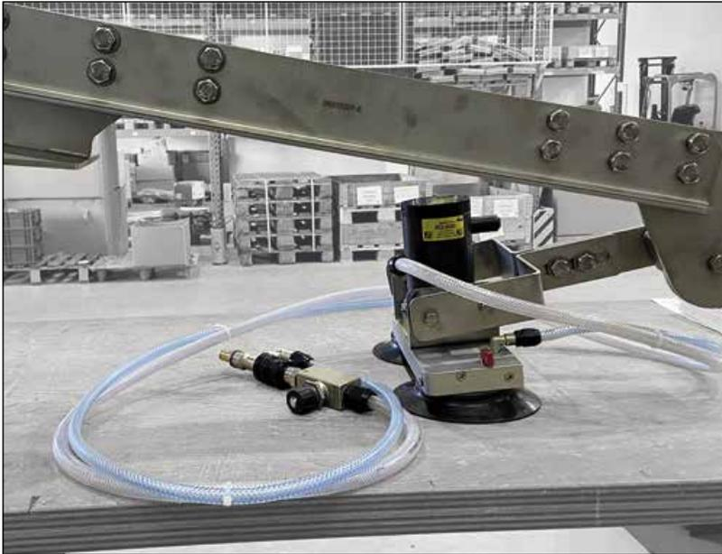
*Auch bei wechselnden Einsatzorten eignet sich eine Vakuumhalterung – hier mobile VAC mit PKL 1000*
