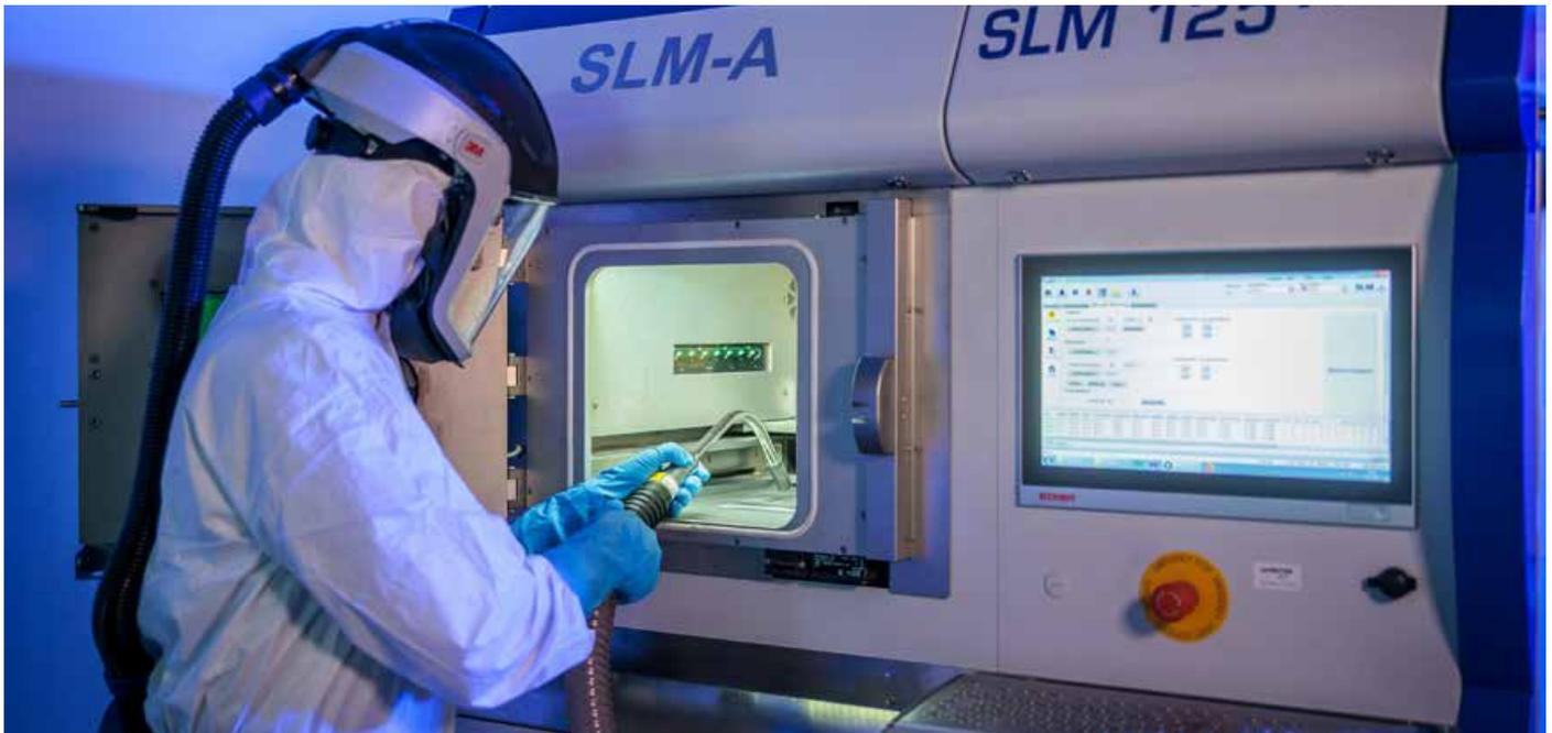
Die Trocken-Vorabscheidung ermöglicht den Verzicht aufs manuelle Entpulvern beim Selektiven Lasersintern (SLM)
