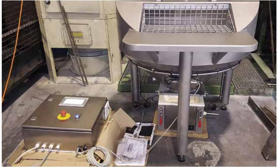
**Bag-Dump-Station auf Wägezellen mit zugehörigem Schaltschrank während der Inbetriebnahme in der Fabrik**
