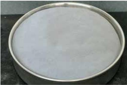
*Ausgangsmaterial für den Metall-3D-Druck: Eine hochwertige Metalllegierung in Pulverform*
