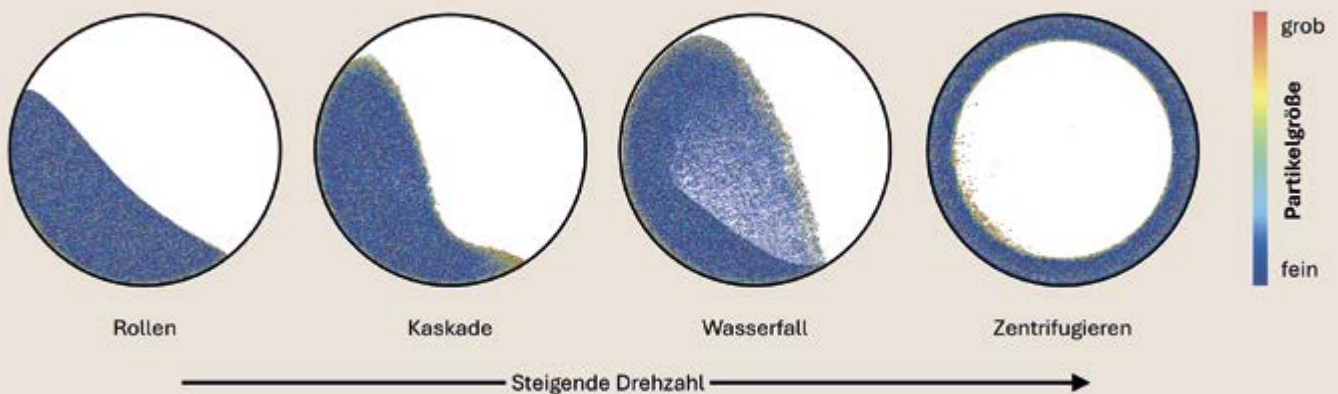
Abbildung 1: Unterschiedliche Fließregime des dynamischen Schüttwinkelversuchs unter Verwendung eines trockenen Zementmaterials (Färbung nach Partikelgröße)
