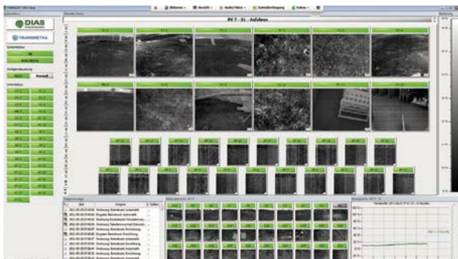
Die Software ermöglicht eine Hotspot-Detektion in Echtzeit
