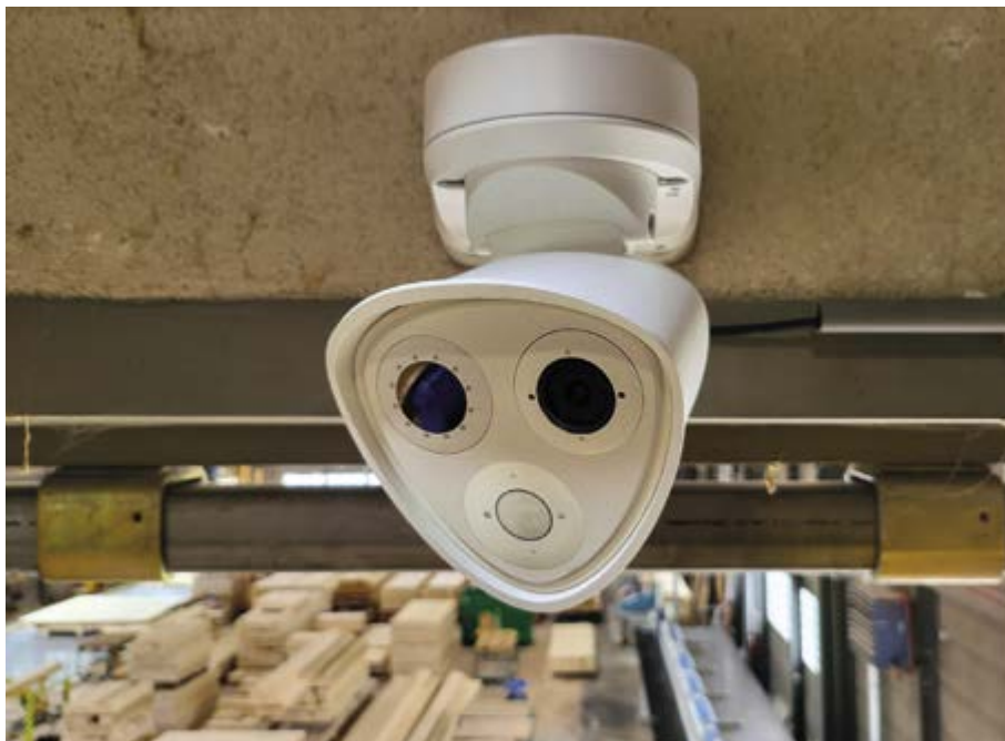
Brandschutz in der Holzindustrie mittels IR-Kamera
