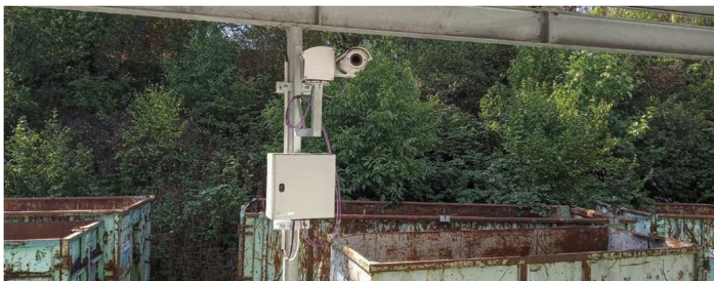
Wetterschutzgehäuse mit Heizung und hartbeschichtetem Infrarot-Fenster
