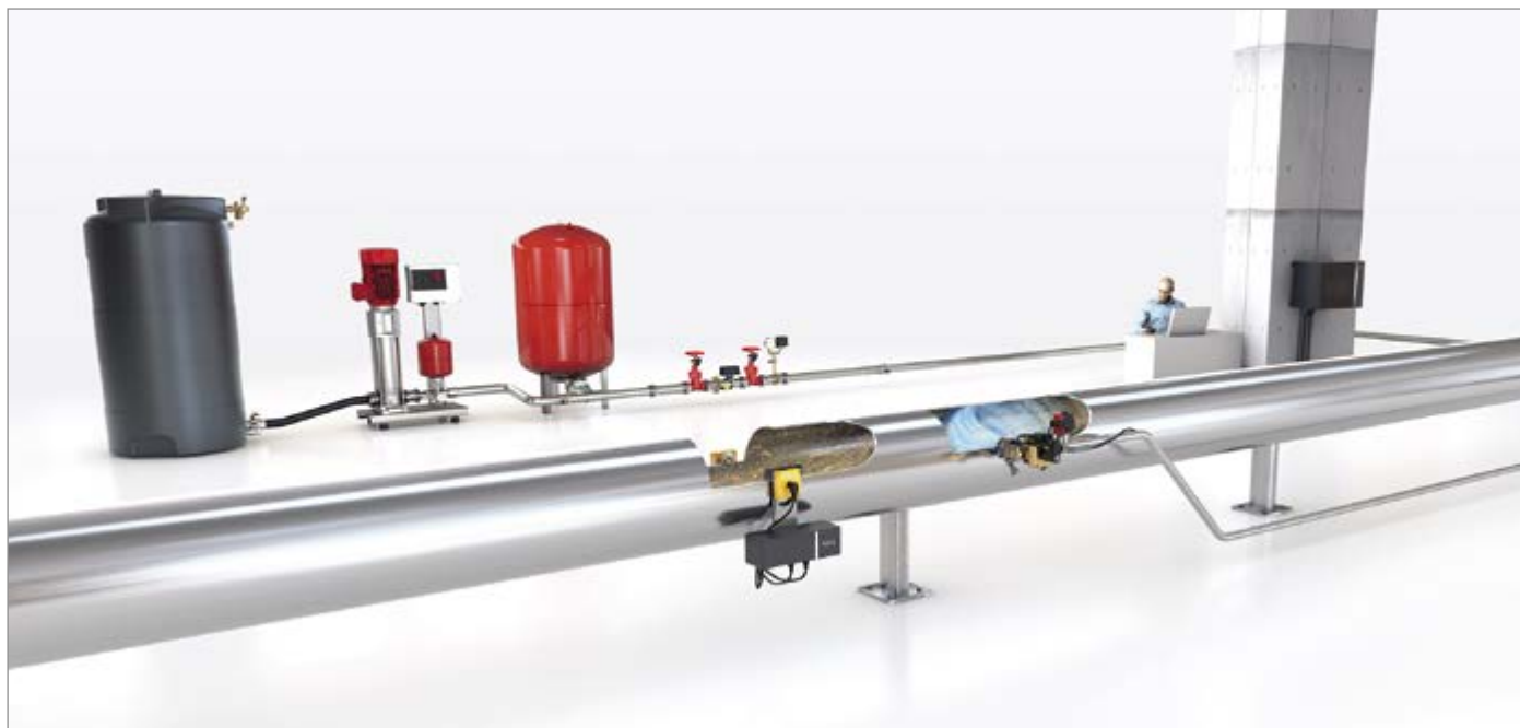
Funktionsprinzip des Brandschutzkonzepts GreCon PROTECTOR
