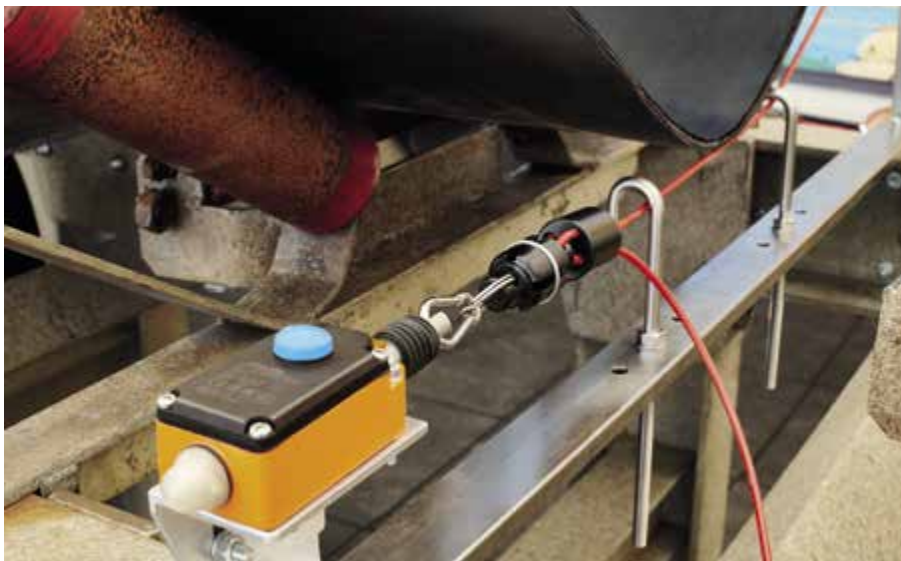
Das neue Bandrissüberwachungssystem erkennt frühzeitig einen Riss im Fördergurt und minimiert damit Folgeschäden
