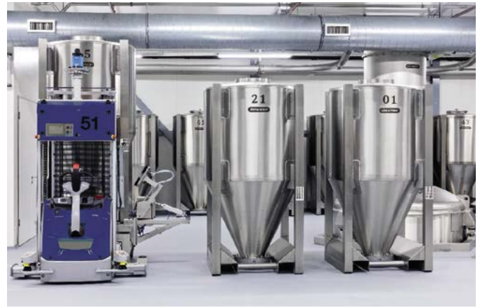
Automatischer Containertransport mittels Fahrerlosem Transport System (FTS)
