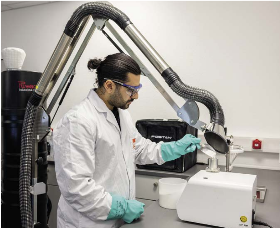
Bild 1: Feinarbeit in der Produktanalyse: Die Projektierung beginnt mit einer Analyse der Eigenschaften des Pulvers oder Granulates, das gewogen oder dosiert werden soll (Bilder: Ruwac Industriesauger GmbH)
