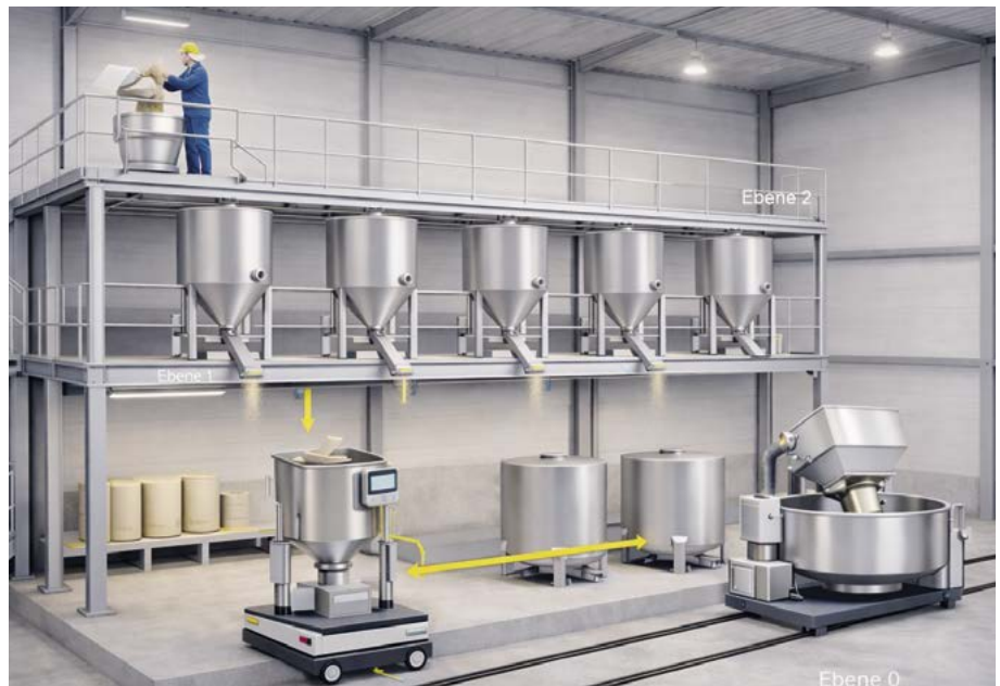
Manuelle Sackentleerung mit nachgeschalteter Pufferung, Dosierung und automatisierter Entleerung in einen Mischer
