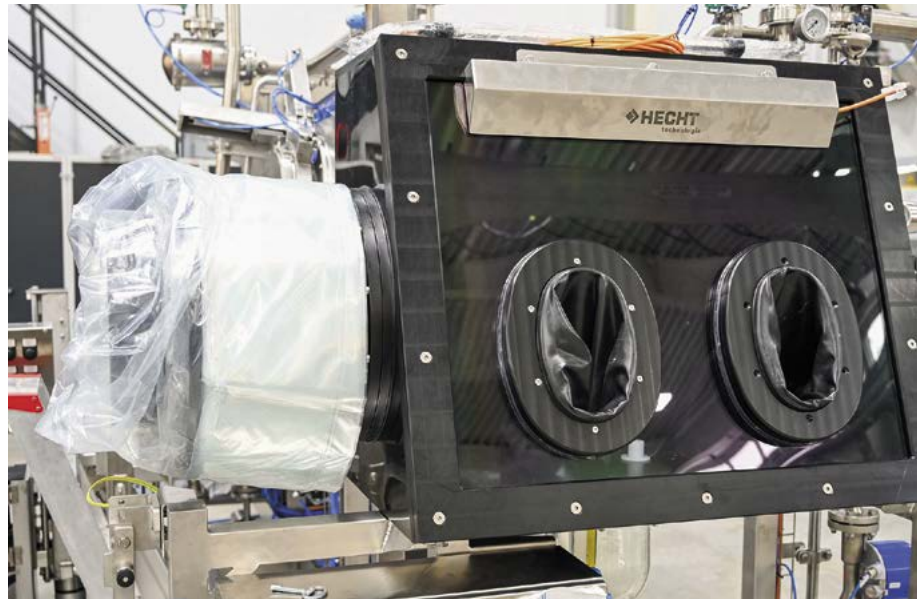
Glovebox für empfindliche oder toxische Feststoffe mit geschlossener Schutzatmosphäre
