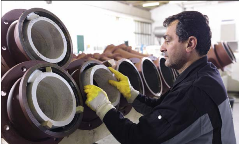
Auskleidung von Rohren und Rohrbögen mit verschleißfestem Werkstoff
