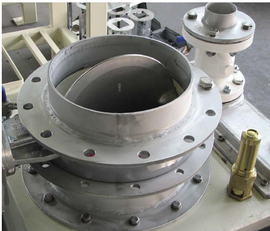
Mit VeloGuard werden Verschleißteile wie die Produkteinlaufklappe dauerhaft automatisch überprüft, um ungeplante Stillstände zu verhindern
