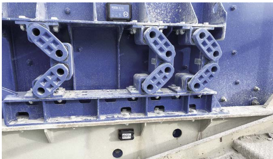
ROSTA-Elemente an der Siebanlage
