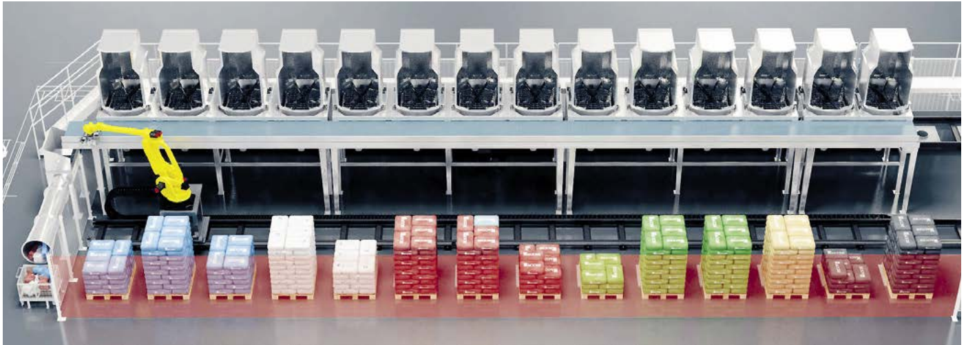
Die Säcke werden automatisch gehandhabt, geöffnet und in die vorgesehenen Stationen entleert, anschließend verwogen und dosiert in einen Container gefüllt. Die Leersäcke werden automatisch verdichtet und entsorgt.
