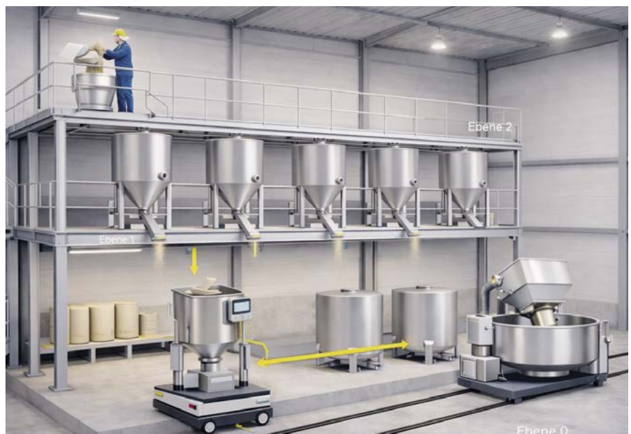
Manuelle Sackentleerung mit nachgeschalteter Pufferung, Dosierung und automatisierter Entleerung in einen Mischer
