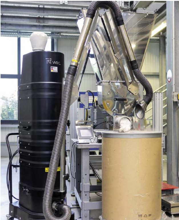
Bild 2: Im Technikum werden auch größere Mengen des Kundenproduktes gehandhabt. Beim Um- und Abfüllen verhindert der Absaugarm, das Pulver und Stäube in die Umgebung gelangen.
