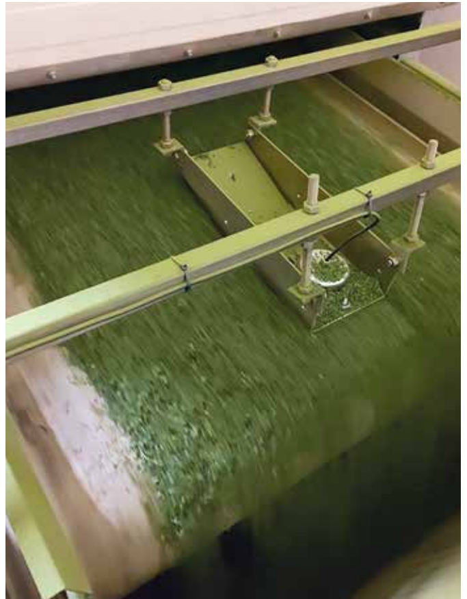
Sensor mit Gleitschuhschlitten auf Förderband
