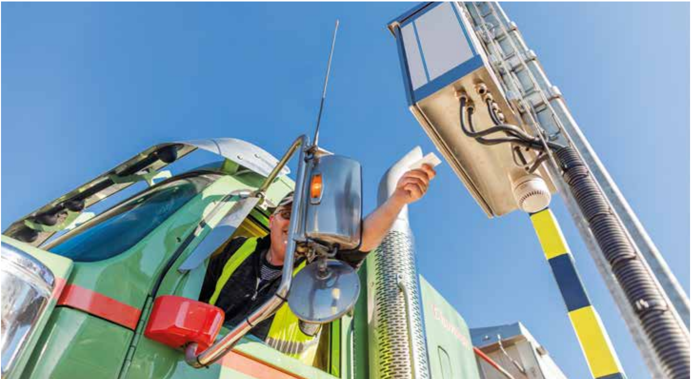
Automatisierter Check-in über Fahrer-Selbstbedienterminal bei der Einfahrt (© PFREUNDT GmbH)
