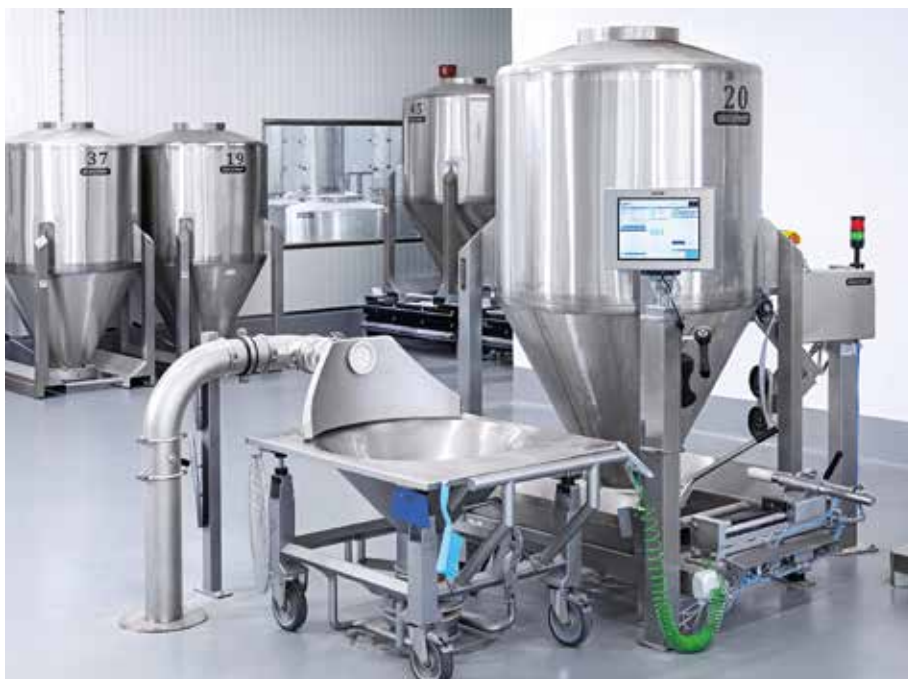
Container-Entleersystem mit automatischem Klappenöffner, mobile Sackaufgabestation
