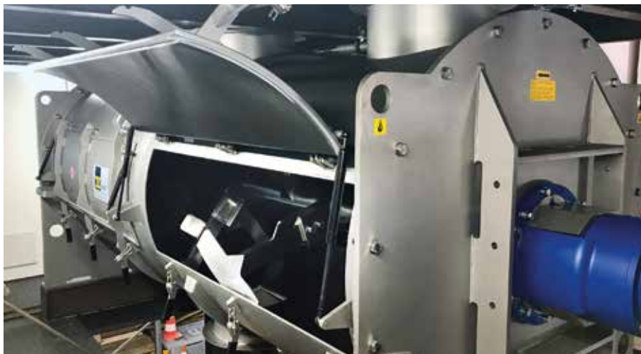
Die Chargenmischer WBH ermöglichen dank der großzügig dimensionierten Inspektionstüren die einfache und sichere Kontrolle und Reinigung der Mischkammer und der Werkzeuge
