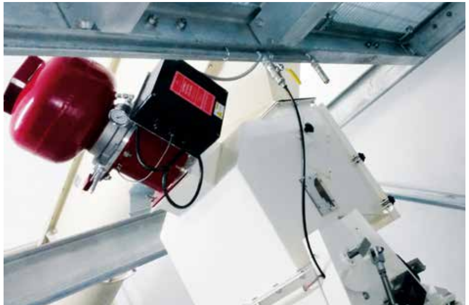
Das System kann in jeder beliebigen Lage eingebaut werden und eignet sich auch für ungünstige Platzverhältnisse
