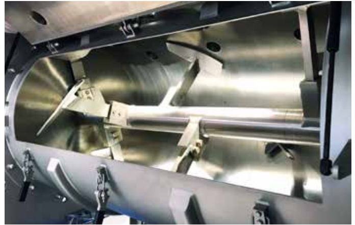
Gerade bei Geräten mit rotierenden Teilen, wie dem Chargenmischers WBH, ist auf ATEX zertifizierte Ausführung zu achten, um Funkenbildung zu vermeiden
