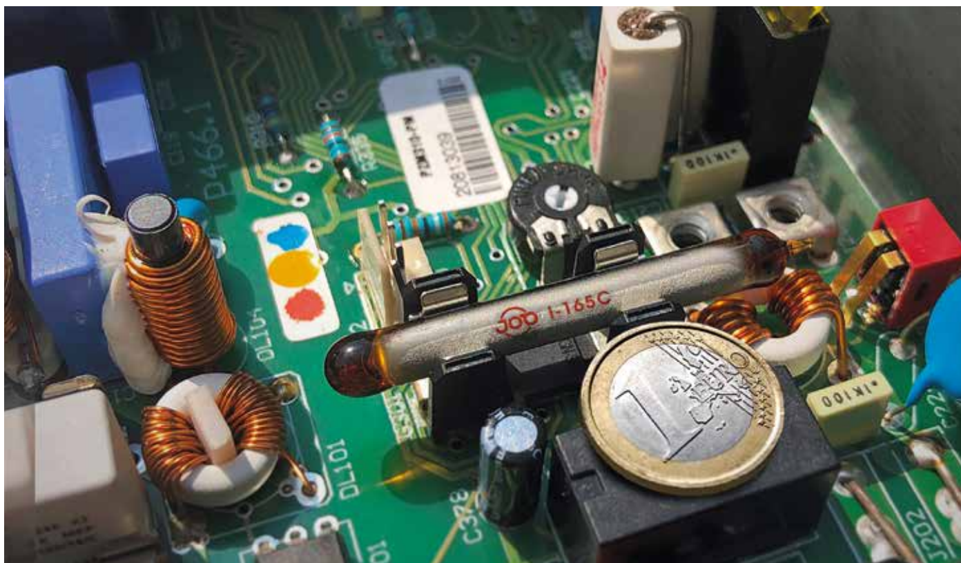
Der kleinste Feuerlöscher der Welt (E-Bulb), eine feuerlöschende Sicherung auf einer elektronischen Leiterplatte (Bildrechte: JOB Gruppe)
