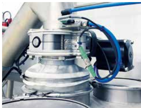
Absperrorgane, wie die Drehklappe VFP, verbinden und trennen unterschiedliche Bereiche der Anlage und müssen daher entsprechend der ATEX Anforderungen zertifiziert sein
