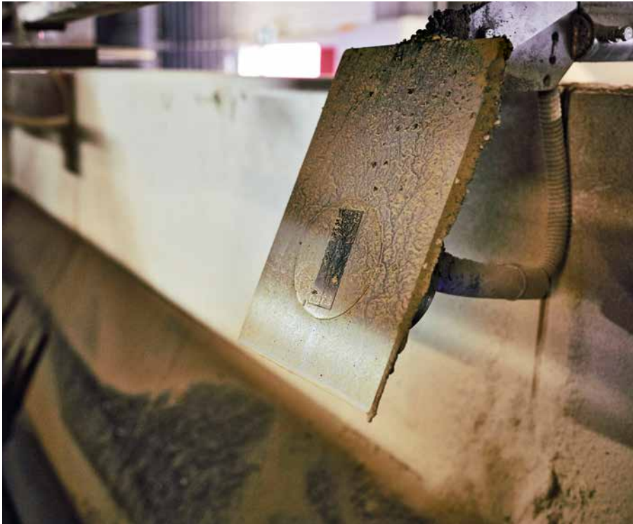
Solitrend sorgt für schnelle und zuverlässige Messungen der Feuchte direkt im Schüttgutstrom
