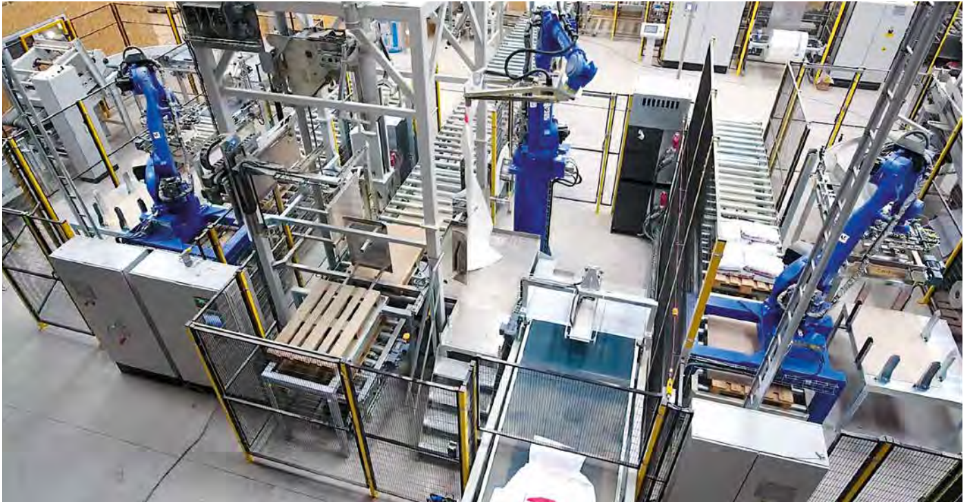
Vollautomatisches Bigbag Füllsystem für Sand und Trockenmörtel
