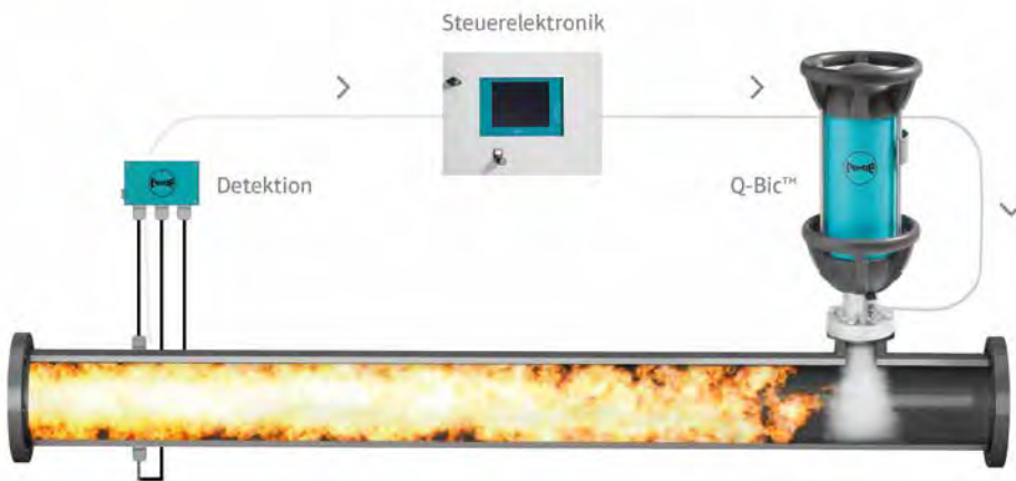
Schematische Darstellung der Funktion einer Löschmittelsperre
