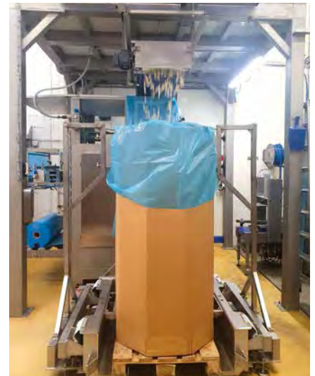
Höhere Füllmenge, niedrigere Transportkosten durch clevere Vibrationstechnik
