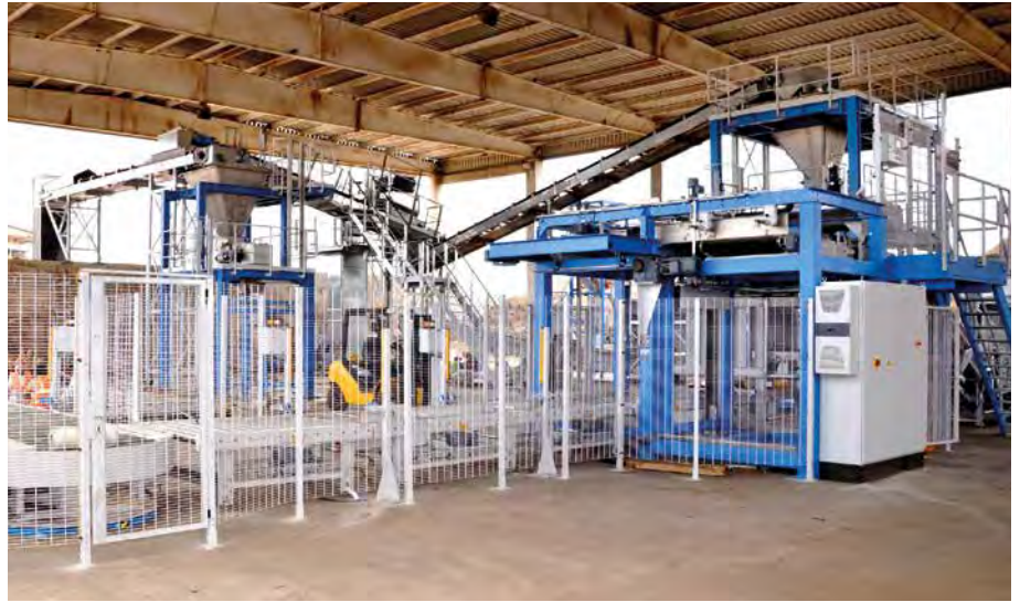
Gesamte Verpackungs- und Palettieranlage in Farbe Blau auf Kundenwunsch
