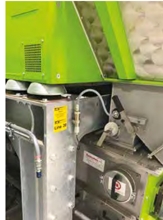
Funken und Glutnest- detektion im Austrag der Presse mit Löschung
