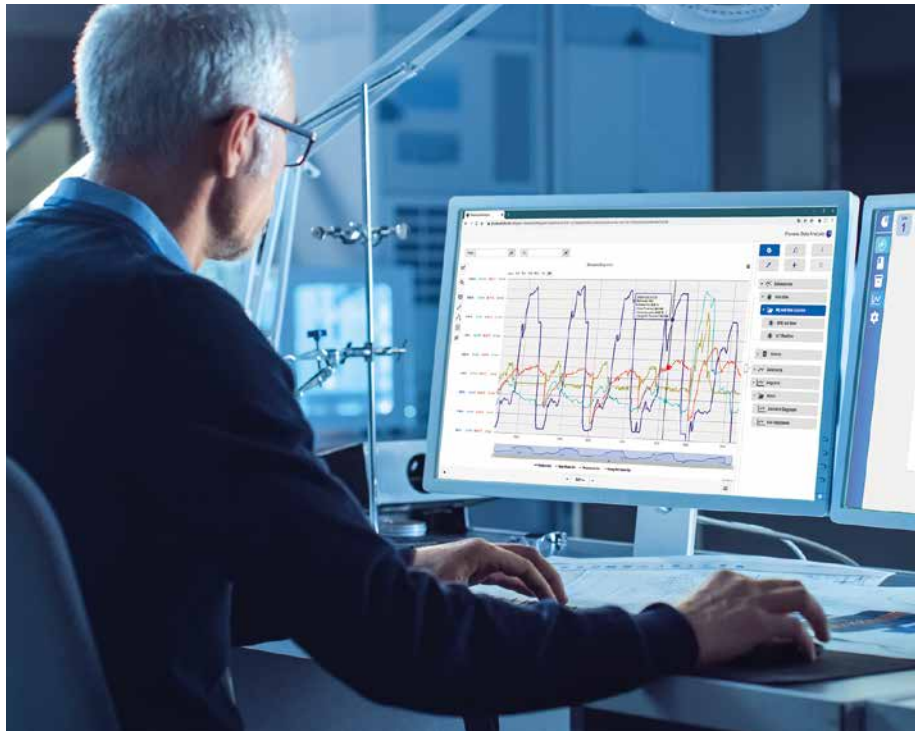
Die EIRICH ProView Software visualisiert und analysiert die Daten, die aus Proben des Mischguts mittels QualiMaster gewonnen wurden. So lassen sich verfahrenstechnische Prozesse überwachen und steuern.
