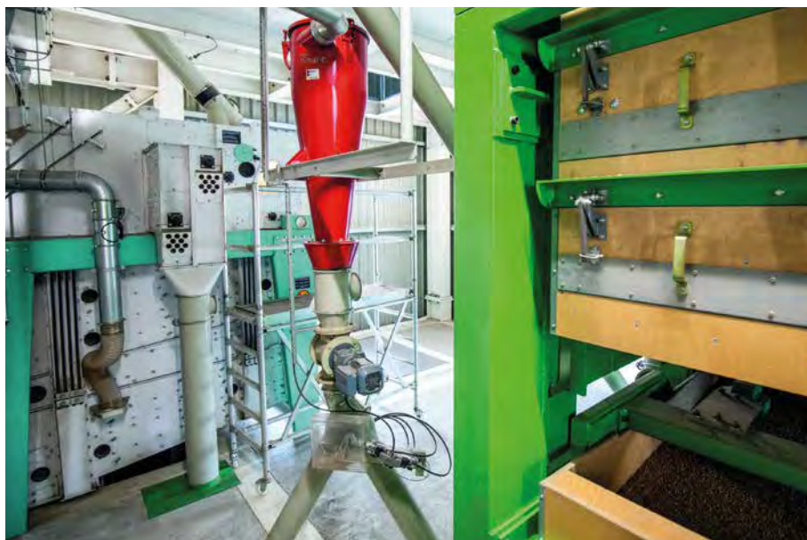
Der Zyklonabscheider mit Weiche (links) erlaubt die Rückführung von „Gutmaterial“ in die Anlage. Rechts ein Ausschnitt der Saatgutaufbereitungsanlage.
