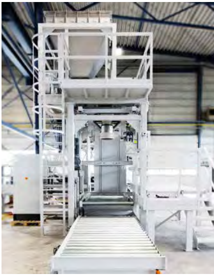
Big-Bag-Füllstation mit PE-Auskleidung
