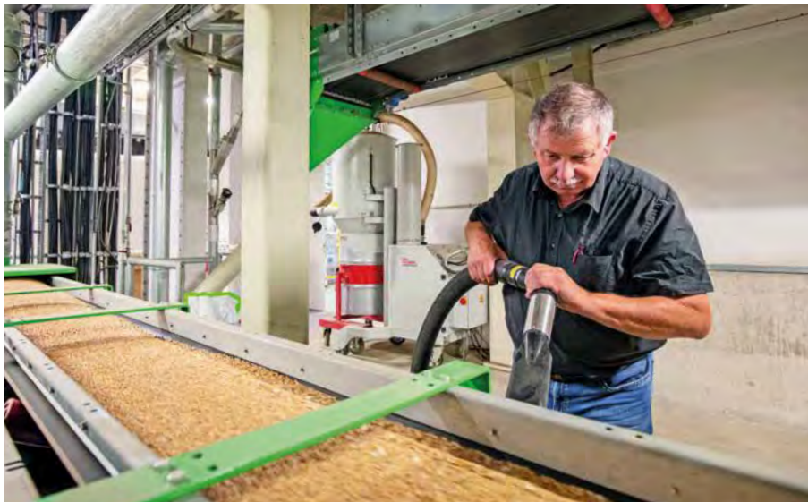
Blick auf das Fördersystem der Saatgutaufbereitung. Im Hintergrund: die zentrale Absauganlage.
