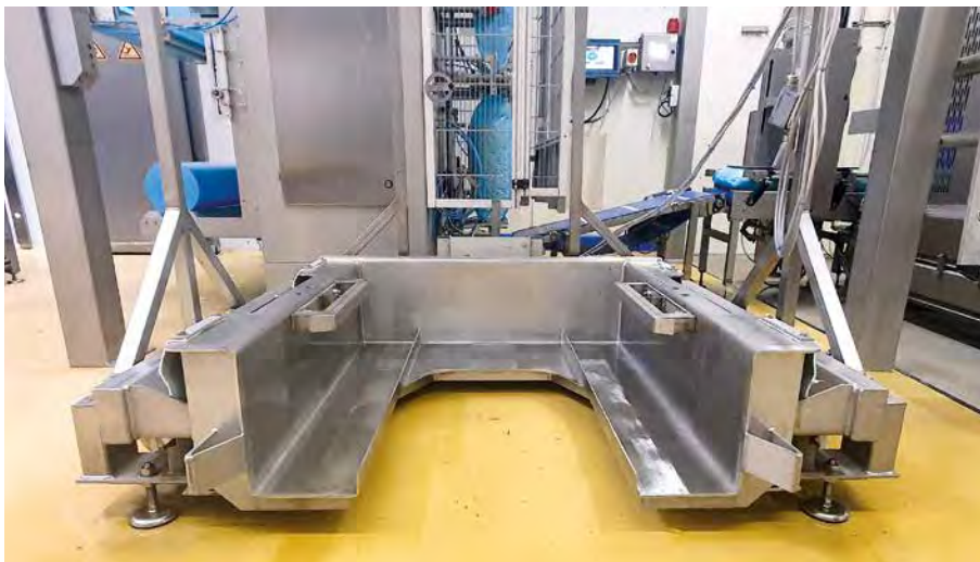
Der Vibrationsflachtisch ist ebenerdig befahr- und beladbar
