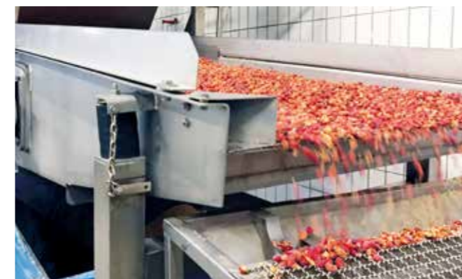
Auf der Vibrations-Siebrinne von NetterVibration werden Kerne und Frucht der Hagebutte mittels Rütteln getrennt
