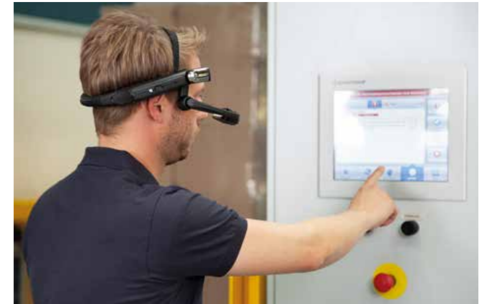
Die BEUMER Smart Glasses kann sich der Servicetechniker des Kunden aufsetzen und erhält alle wichtigen Informationen in das Livebild der Gerätekamera eingebildet
