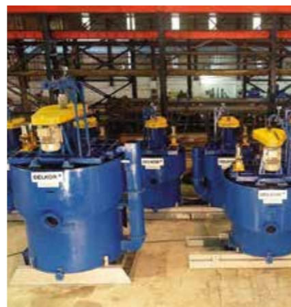
DELKOR BQR-Flotationszellen mit MAXGen-Mechanismus für die Flourit-Anwendung
