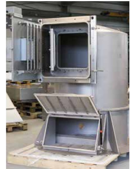
Es ist gelungen, die Filterschlitzplatte „schwenkbar“ zu gestalten. Hierdurch erhält man nach dem Öffnen ein großes Mannloch. Damit wird der Filterraum einfacher zugänglich und reinigbar.
