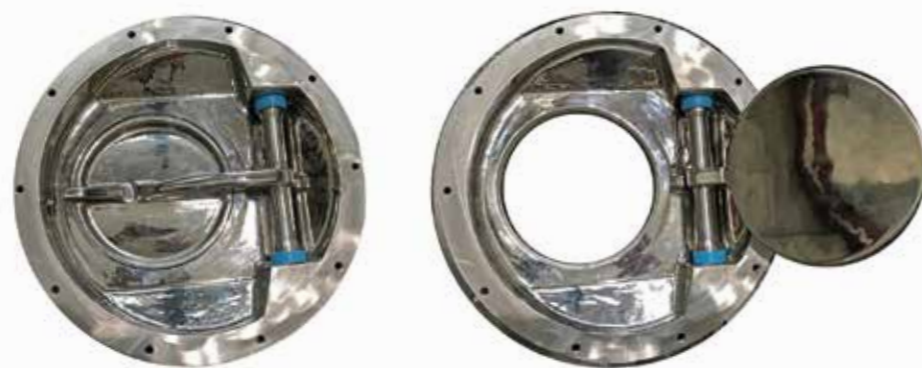
Ansicht des Ventils von unten in offener und geschlossener Position
