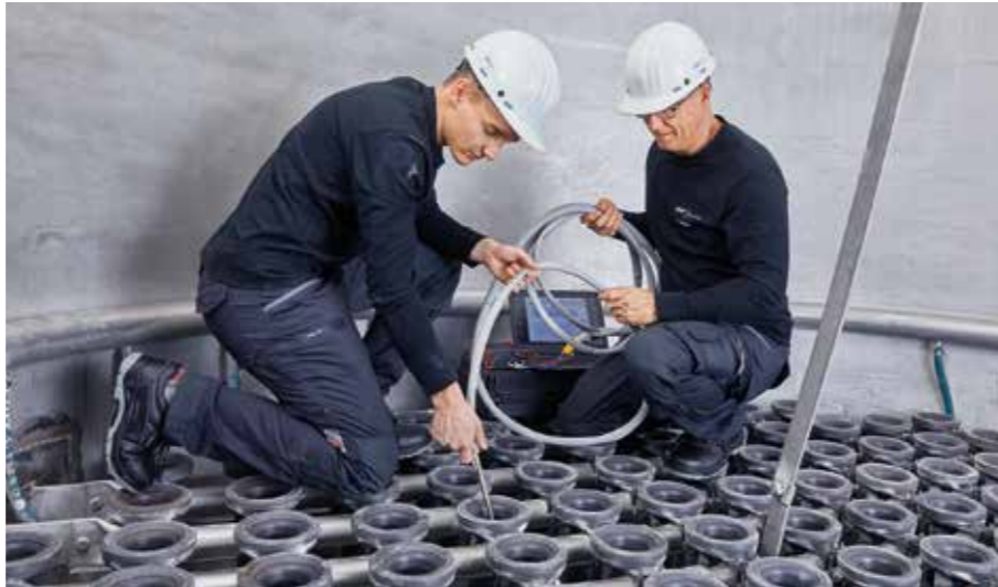
Die speziell für die Filteranlagenoptimierung entwickelten Messsonden sind nahezu in jeder Druckstoß abgereinigten Filteranlage mit senkrecht eingebauten Filterschläuchen einsetzbar
