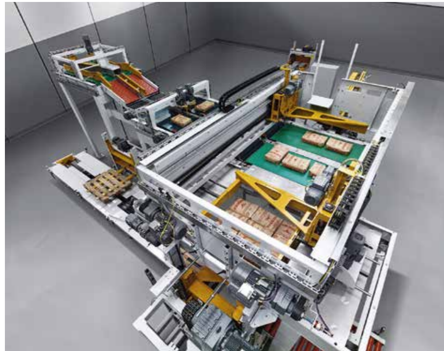
Die Umstellung von 50- auf 25-Kilogramm-Säcke wird in einigen Ländern kommen. Die Palettierer wie der BEUMER paletpac müssen bei den Kunden darauf angepasst werden.
