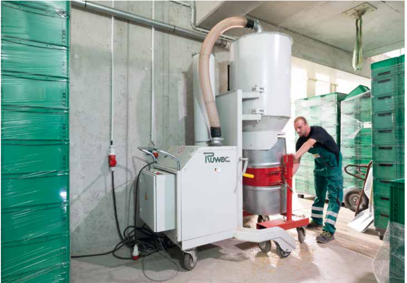
Die höhenverstellbare Abscheideeinheit und die kippbare Transportvorrichtung ermöglichen eine einfache und schnelle Entleerung des 200 Liter-Sauggutbehälters (Bild: Ruwac Industriesauger GmbH)
