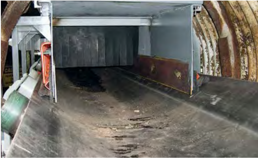
Bild 4: Die Verschleißauskleidung verbessert die Abdichtung, ohne im effektiven Beladungsbereich einen Rückstau hervorzurufen
