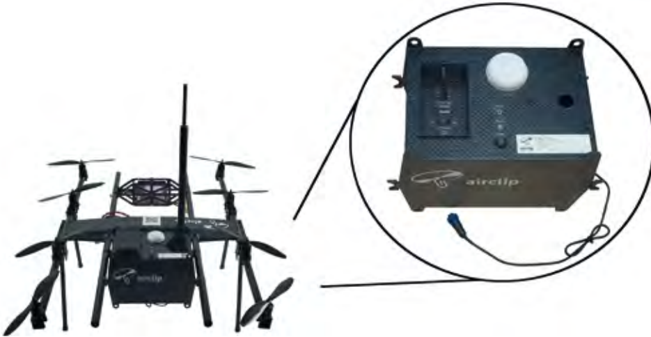
Links: Der Flugroboter HORUS, die Trägereinheit, mit integriertem Fidas® Fly 100-Echtzeit- Staubmonitor. Zusammen: der Fidas® Fly 200. Rechts: Detailansicht des Fidas® Fly 100-Echtzeit- Staubmonitors, ein leichtes Feinstaub-Aerosolspektrometer.
