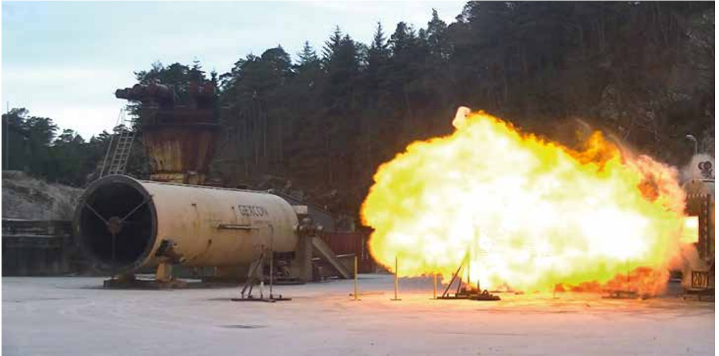
Staub, geschlossene Behälter und eine hinreichende Menge an Sauerstoff: Voraussetzungen für eine Staubexplosion bei der Verarbeitung von Schüttgut
