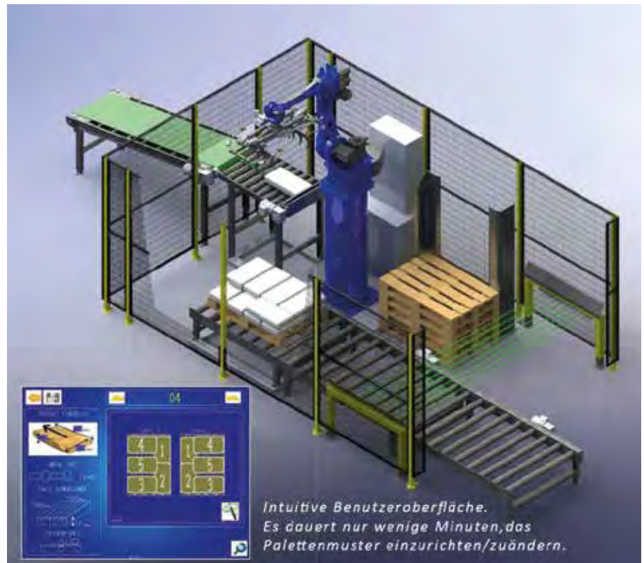
Die PanPac-Lösung zur Roboterpalettierung im Querschnitt
