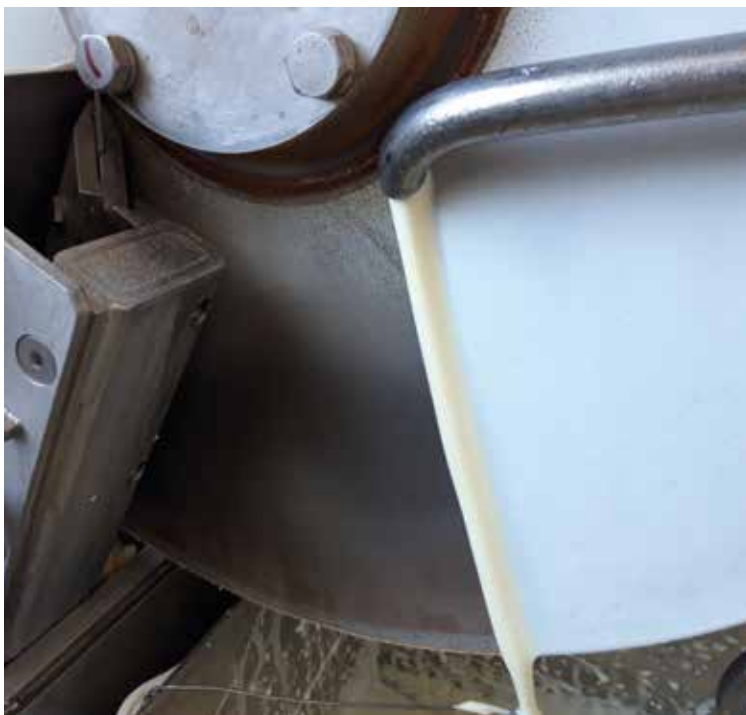
Bild 1 und 2: Trocknung von Milchkonzentrat mit dem CDry 501 lab
