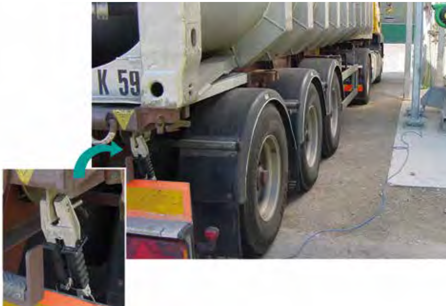
Erdungsüberwachung mit LKW-Erkennung mittels FARADO
