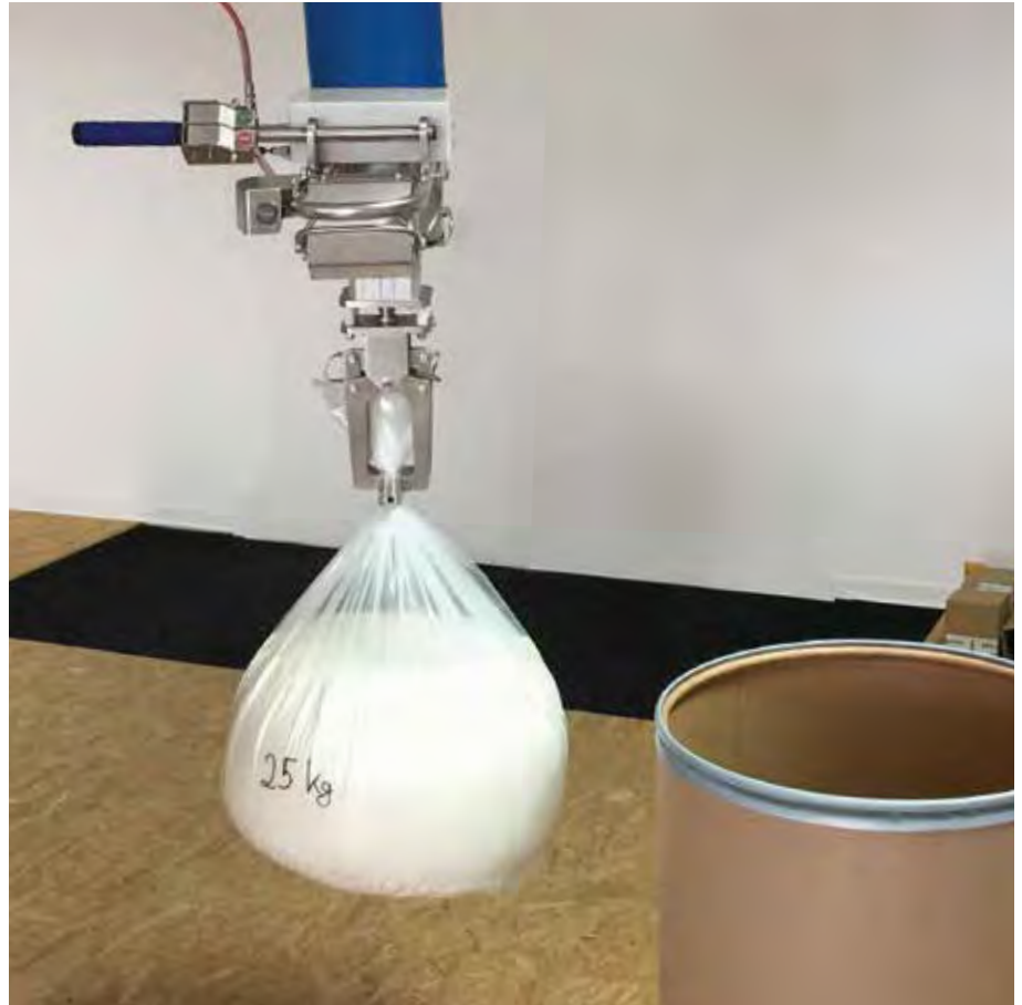
ezzFLOWpneumatic beim Handeln von Pulver in einem Karton (Copyright: Best Handling Technology)
