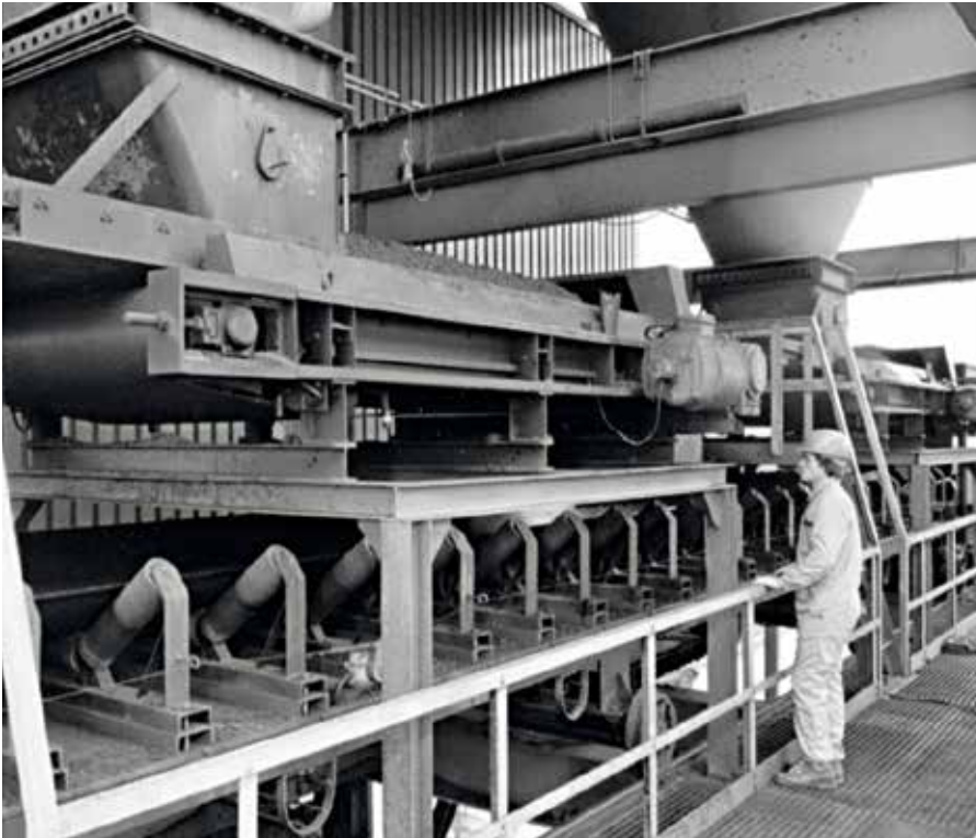
Bild 2: Gurtförderer als Austraggerät [1]
