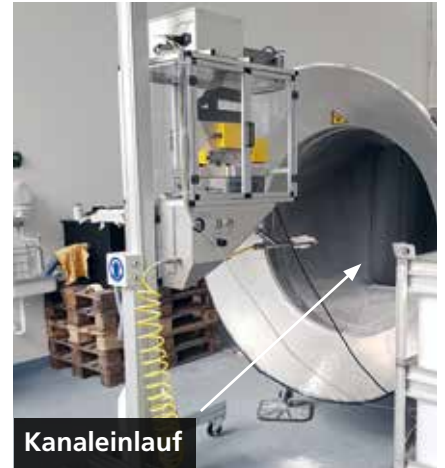
Bild 2: Foto des Druckluft-Dispergierers zur Staubaufgabe am Kanaleinlauf (Durchmesser: 1 m)
