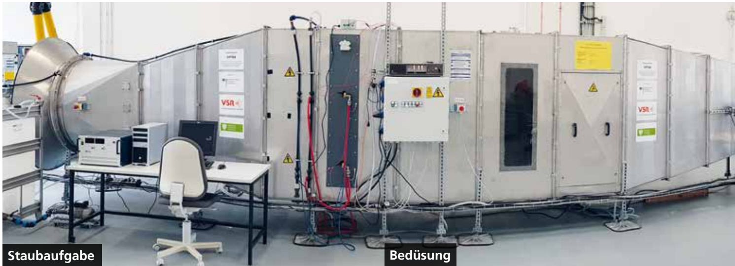
Bild 1: Foto des Windkanals mit Markierung der Orte von Staubaufgabe, Bedüsung und Messung (Gesamtlänge: 17 m)
