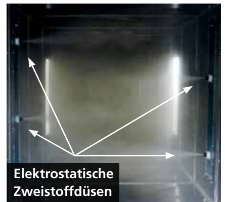
Bild 3 (links): Foto aus dem Querschnitt der Bedüsung (Querschnittsfläche: 2,84 \text{ m}^2 )
