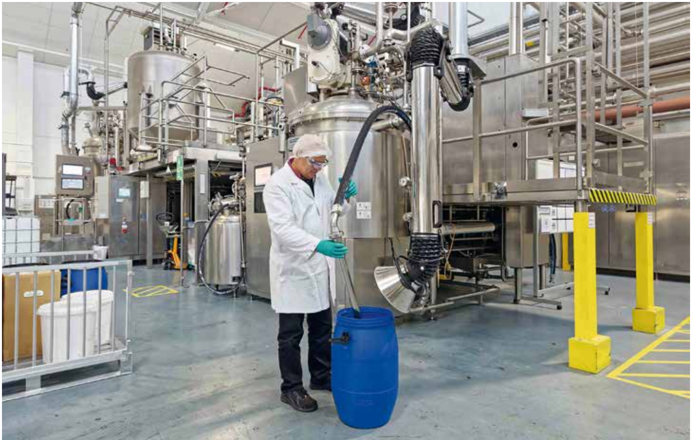
Die Saugarme der Tandem-Absauganlage schaffen die Voraussetzung für ein staubfreies Eindosieren von pulverförmigen Inhaltsstoffen in die Mischanlagen (Bild: Ruwac Industriesauger GmbH)
