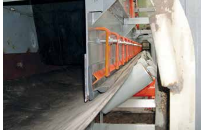
Bild 2: Verschleißauskleidungen sollten in einer geraden Linie eingebaut werden, die sich in Richtung des Austritts am Übergabepunkt allmählich aufweitet
