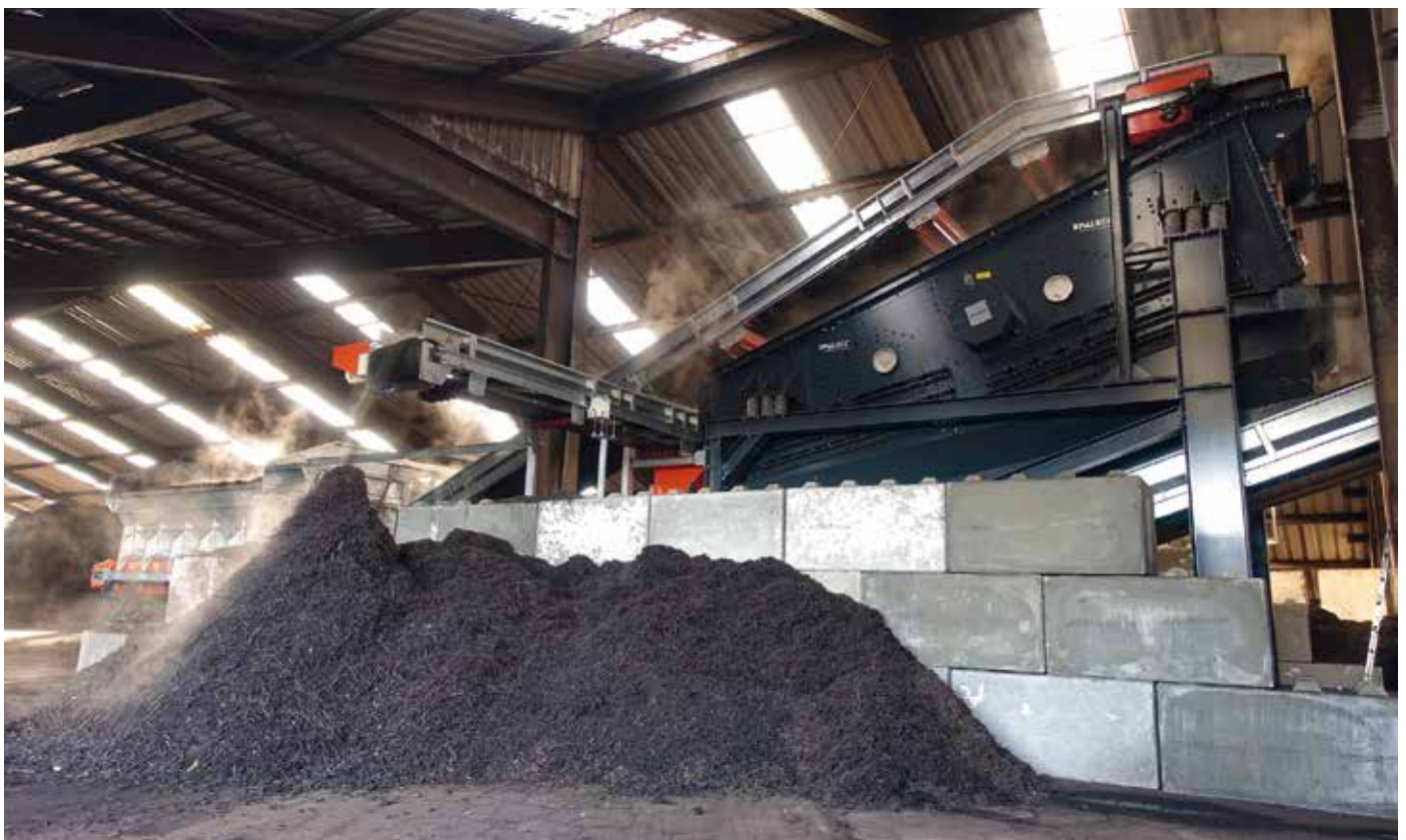
Das Spaleck 3D COMBI Kompostsieb mit Ober- und Unterdeck und innovativer Spannwellentechnik
