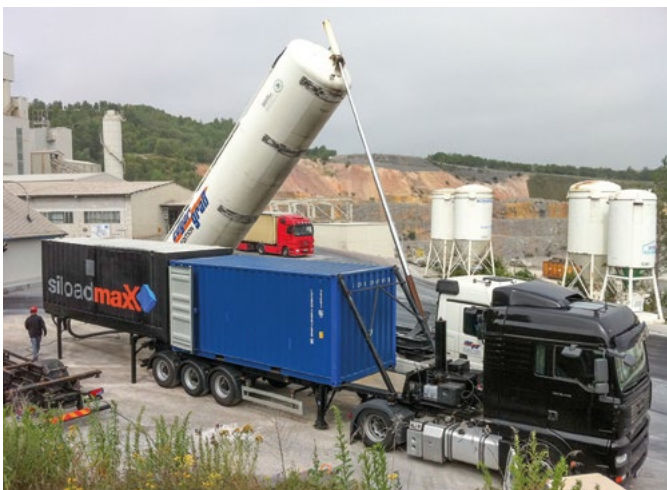
Containerbeladung mit dem Siloadmaxx-System. In diesem Fall kommt das Schüttgut aus einem Silo-LKW.
