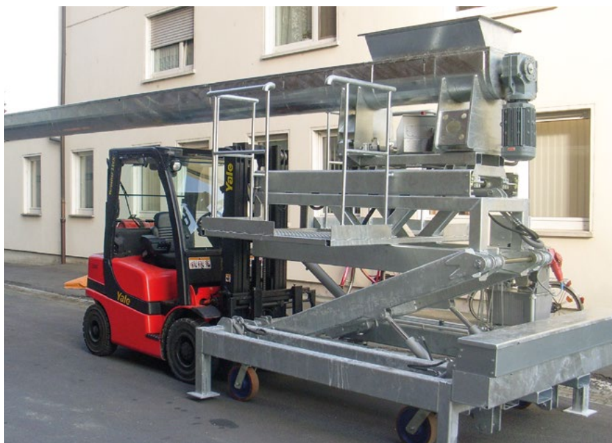
Abb. 1: Beladeschnecke zur losen Beschickung von Fahrzeugen und Containern
