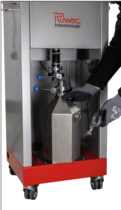
Bild 2: Der Sammelbehälter des Trocken-Vorabscheiders lässt sich einfach wechseln (Bilder: Ruwac Industriesauger GmbH)
