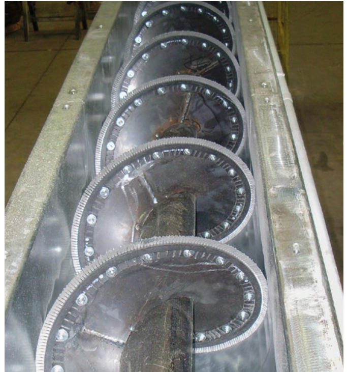
Abb. 2: Schneckengewinde mit Bürsten für den schonenden Transport und für die Reinigung
