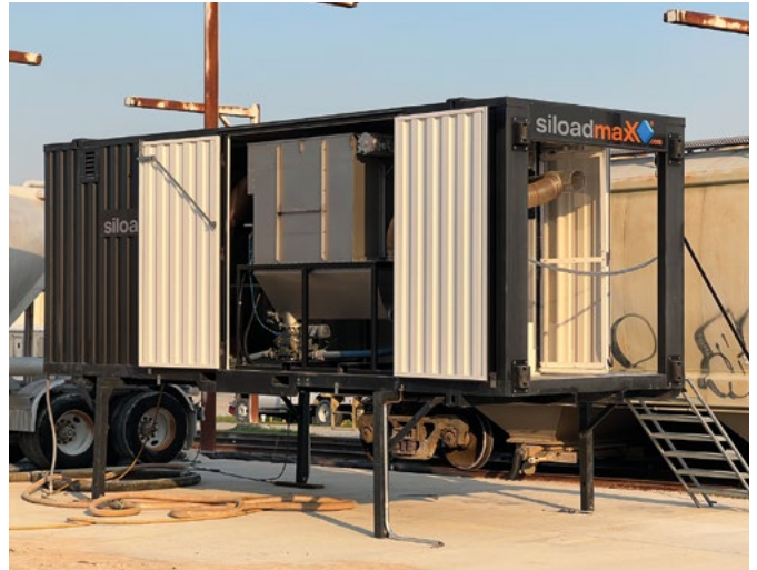
Siloadmaxx-Maschine mit integriertem Filter-System
