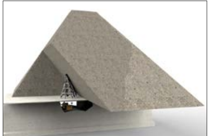
Schwertdüsen im Kalksteinlager
