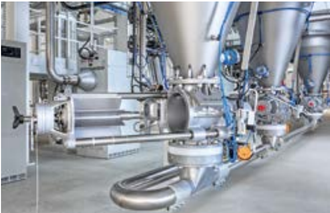
Zellenradschleuse in Schnellreinigungsausführung
