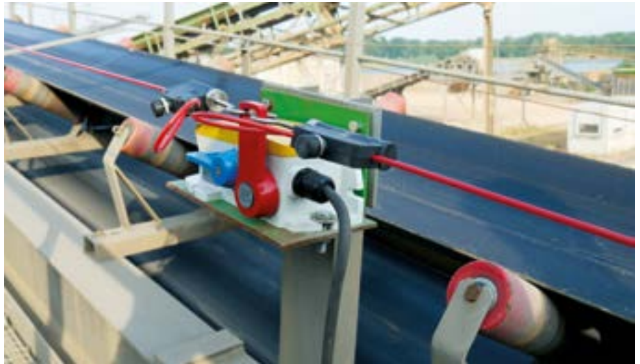
Im „Heavy-duty“-Einsatz: der Seilzug-Notschalter ZS 92 S
