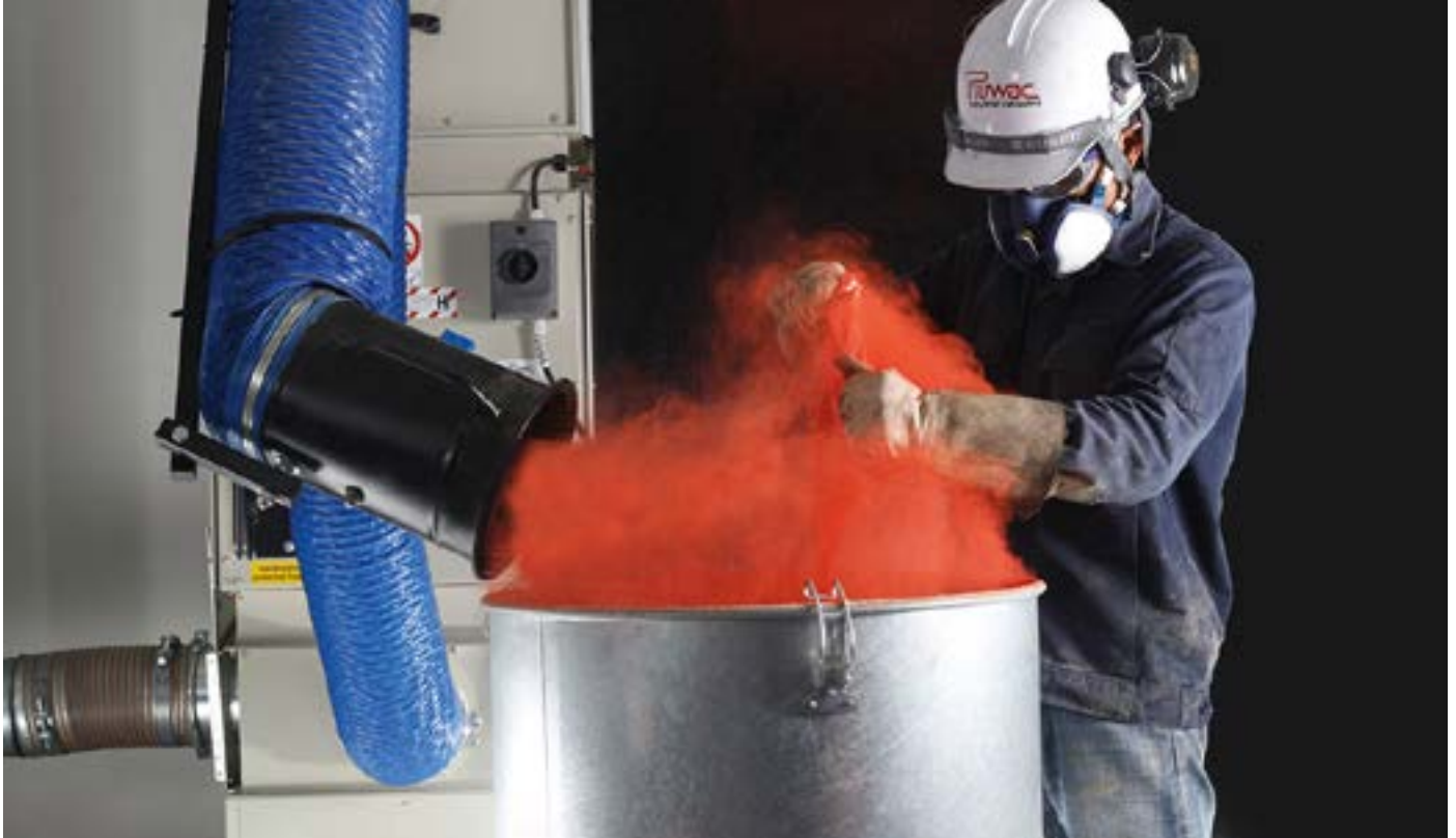
Entstauber saugen Schwebstaub direkt an der Entstehungsstelle ab
