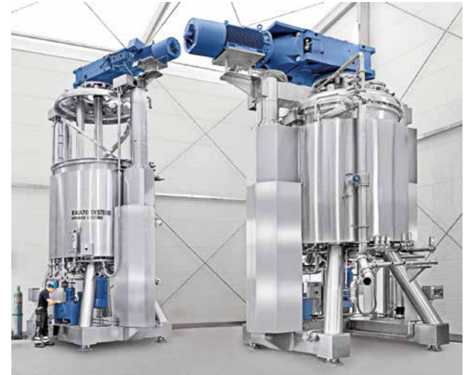
In der weltgrößten Anlage zur chargenweisen Zahncreme-Produktion, entwickelt von der süddeutschen EKATO SYSTEMS GmbH, werden gewaltige Rührwerke durch NORD-Industriegetriebemotoren im Blockgehäuse bewegt
