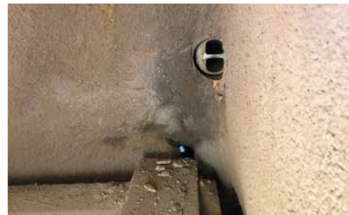
Die Einsteckdüse von Agrichema ermöglicht eine unkomplizierte und schnelle Montage von außen
