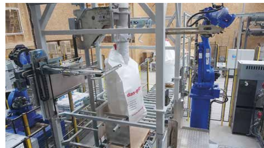
Vollautomatische Befüllung von 1-Schlaufe-Big-Bags von Rolle. Diese Variante gibt es auch für 4-Schlaufen-Big-Bags.
