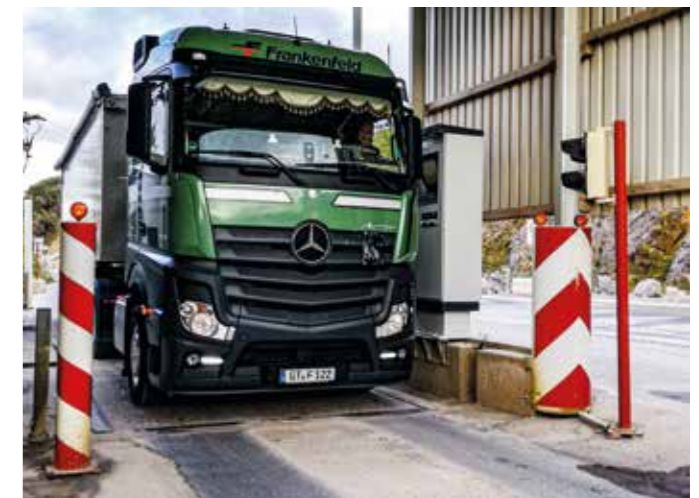
Ist die vorbestellte Menge erfolgreich beladen, fährt der LKW erneut auf die Straßenfahrzeugwaage, erhält einen Wiegeschein und verlässt das Schotterwerk
