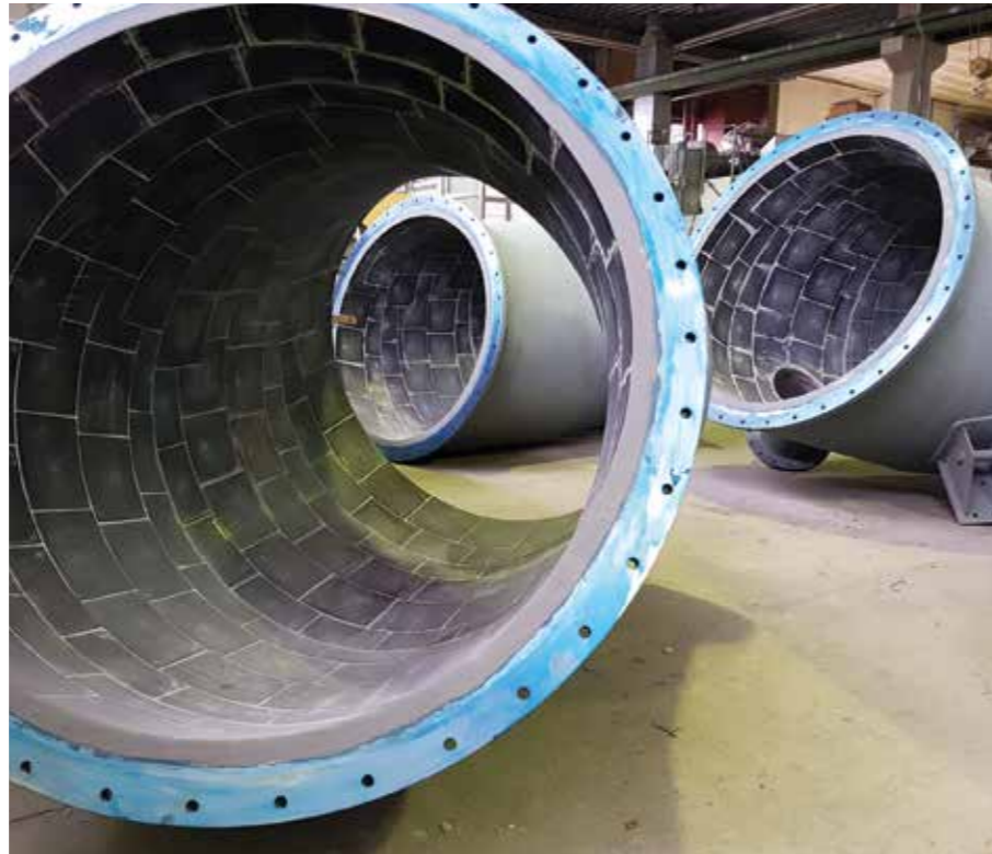
Rohrleitungsteile DN1400, ausgekleidet mit Schmelzbasaltplatten 30 mm dick. Rauchgas-/Zementstaub-Förderleitung.
