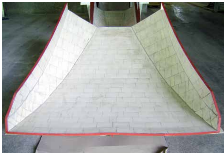
Schurre mit Aluminiumoxidkeramik-Passstückauskleidung
