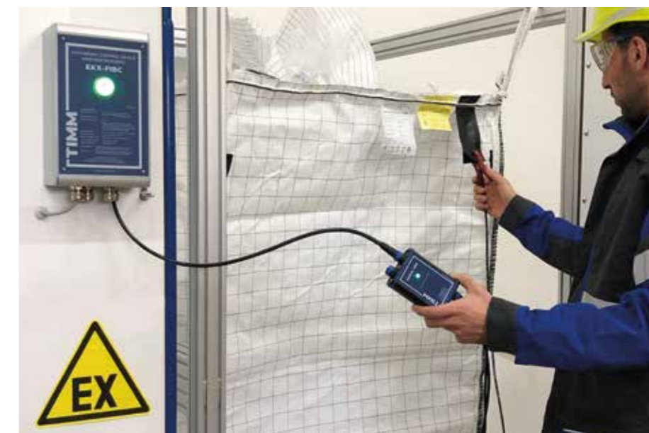
Einfache Anwendung: Beide Zangen werden vom Bediener an die Erdungspunkte des FIBC Sacks angeschlossen. Das Gerät überprüft die elektrischen Eigenschaften des Sacks und leitet die statische Aufladung über beide Zangen zum Erdpotential ab.
