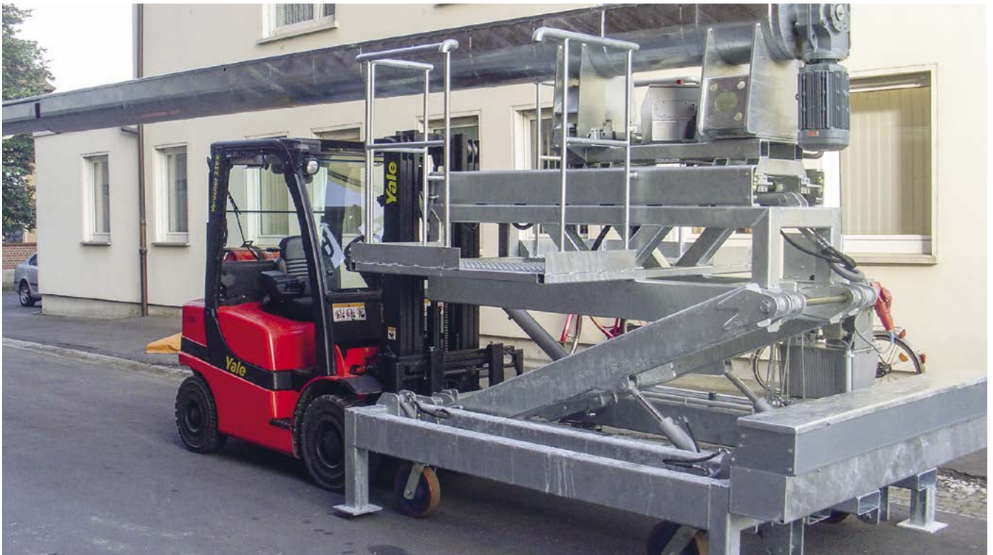
Beladeschnecke zur losen Beschickung von Fahrzeugen und Containern
