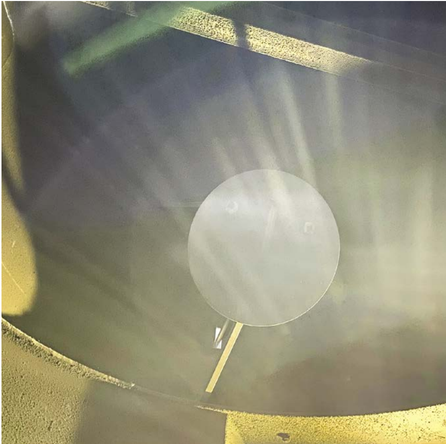
Mithilfe eines 45°-Spiegels wird die Füllhöhe im Schachtofen gemessen
