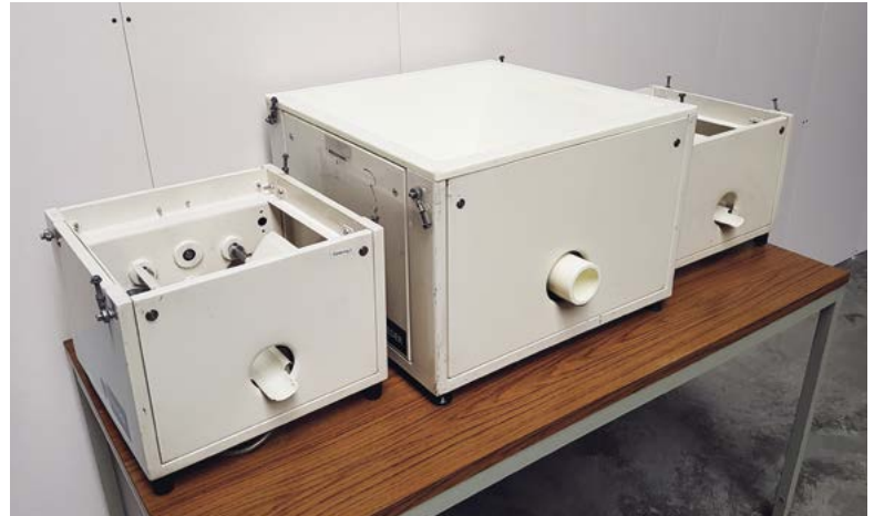
Revidierte HETHON Feeder – fertig für den erneuten Einsatz zur zuverlässigen Dosierung
