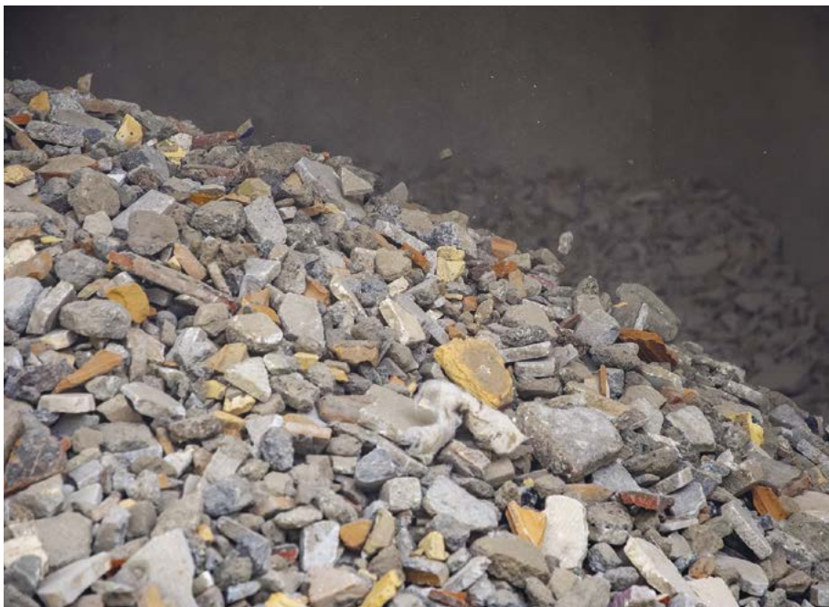
Das Ergebnis von sechs STEINERT-Sortierstufen: gipsfreie Recycling-Gesteinskörnungen für die Schweizer Betonproduktion
