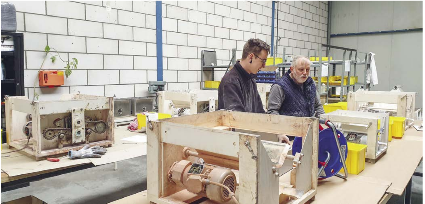
Montage und Prüfung von HETHON-Feedern in Doetinchem, Niederlande
