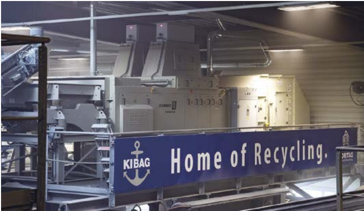
Zwei STEINERT KSS XT | CLI Kombinationsortiermaschinen in der SORTAG-Anlage in Rümlang produzieren gipsfreies Recycling-Granulat für die Betonproduktion der KIBAG-Gruppe
