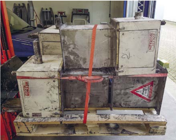
Feeder vor der Revision nach intensivem industriellem Einsatz
