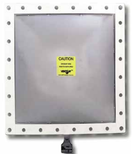
Als Sollschwachstelle gibt das Material von Explosionsschutz-Berstscheiben bei einer Zuckerstaub-Explosion kontrolliert nach und lässt den Druck nach außen entweichen
