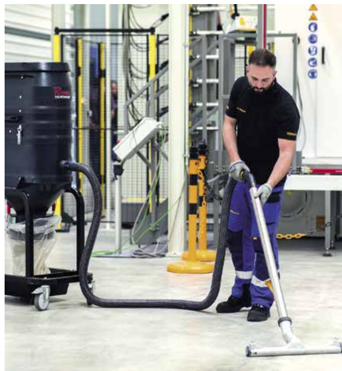
Bild 2: Industriesauger nehmen den abgelagerten Staub vom Boden auf
