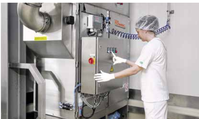
Bild 5: Anwendungsbeispiel Joghurtproduktion: Entstauber in Hygienic Design-Ausführung (Bilder: Ruwac Industriesauger GmbH)
