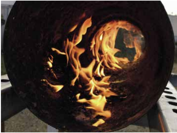
Bild 2: Links zur Verdeutlichung ein demontiertes Rohrstück mit entzündeten Ablagerungen innerhalb einer Rohrleitung auf dem Außengelände der Firma T&B. Rechts: T&B-Versuchsanlage auf dem Außengelände.
