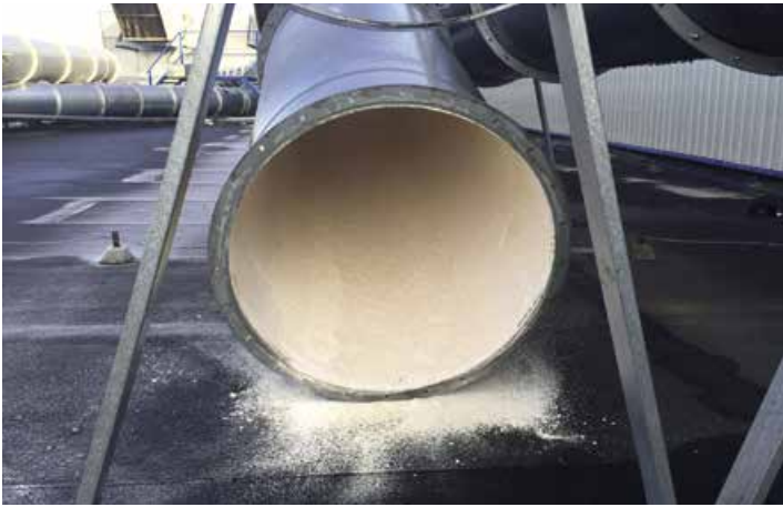
Bild 1: Typische Ablagerungen innerhalb einer Transportleitung. Deutlich ist zu erkennen, dass die Ablagerungen sich nicht nur im unteren Bereich, sondern überall an der Wandung befinden.
