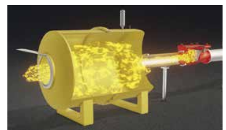
Bild 14 und Bild 15: Aus den dargestellten Tests folgte ein eindeutiges Ergebnis in der Testanalyse. Nur die Verwendung einer Explosionsberstscheibe anstelle eines offenen Anschlusses, wie dies bei allen Anwendungen der Fall ist, bei denen der Behälter durch eine Explosionsberstscheibe geschützt ist, führt dazu, dass Druck und Flammen die Rückschlagklappe realitätsnah beanspruchen.
