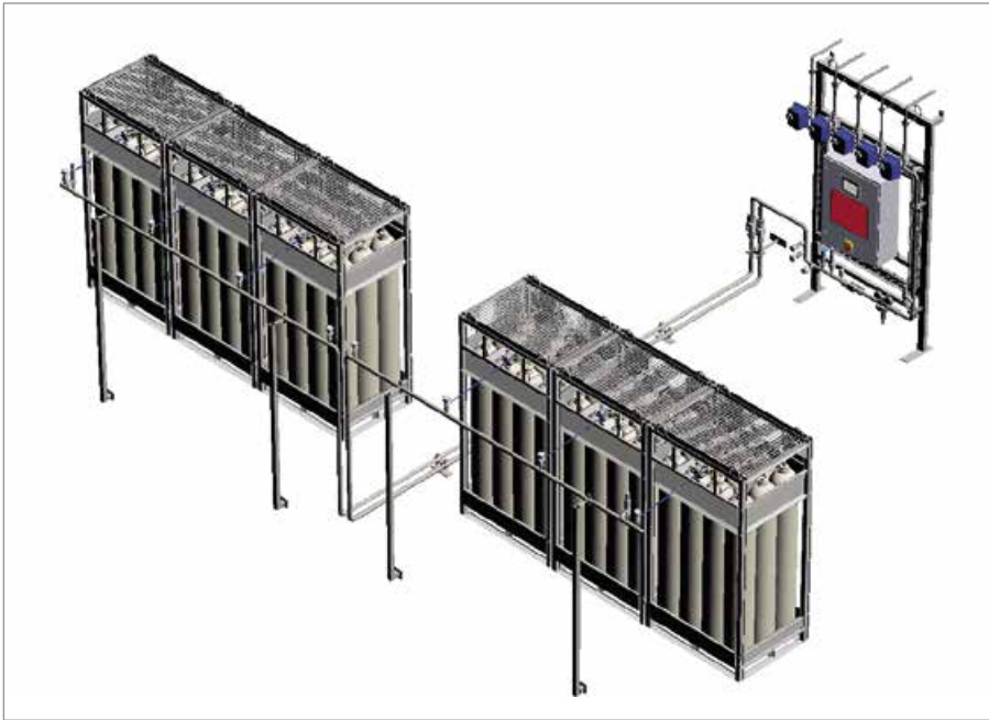
Darstellung der robeco Ventilstation verbunden mit 6 St. Stickstoff-Bündeln
