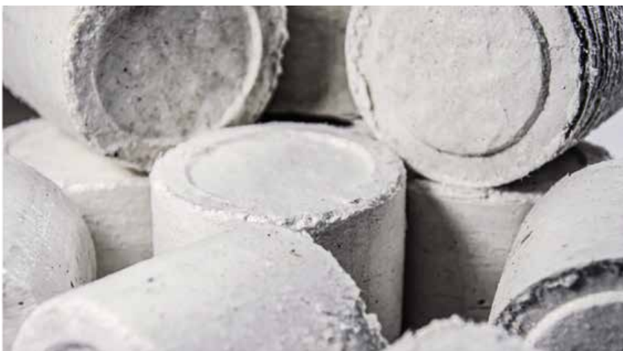
Mit der WEIMA C 150 werden aus losen Papier- und Kartongestäuben hochverdichtete, runde Briketts
