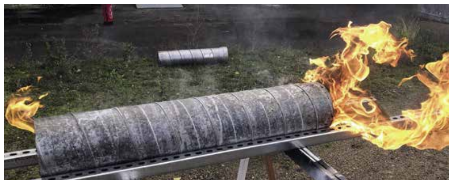
Bild 3: Ein demontiertes Rohrstück zur Verdeutlichung der Dynamik eines Rohrbrandes unter Ausnutzung der Windrichtung auf dem Außenversuchsgelände. Durch den horizontalen Luftstrom wird der Brand wie bei einem Kamineffekt angefacht. Im laufenden Prozess liefert die pneumatische Förderung diesen Luftstrom.
