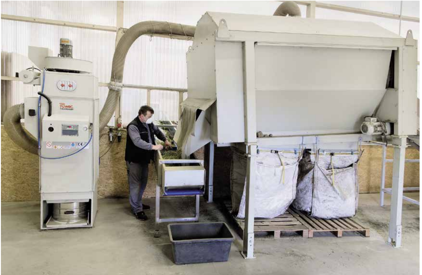
Bild 1: Die Aufgabe eines Entstaubers ist das Absaugen direkt an der Entstehungsstelle
