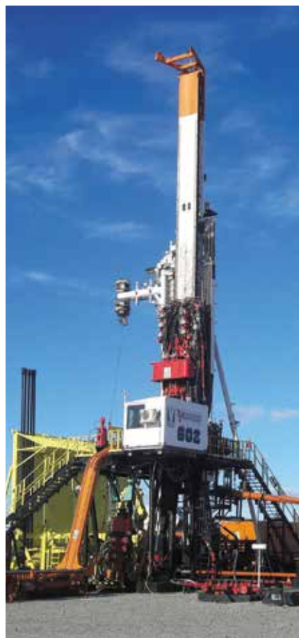
In Tiefbohranlagen von Herrenknecht sorgen explosionsgeschützte Drehgeber von Hengstler für die exakte Positionierung des Bohrantriebs und des Hebewerks (Foto: Herrenknecht Vertical GmbH)
