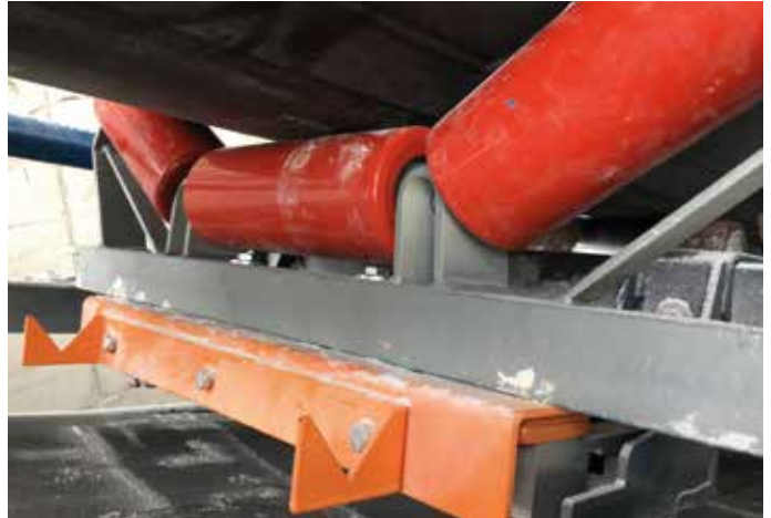
Prüfvorrichtung der Bandwaage ESW 2.2 zur statischen Abgleichkontrolle
