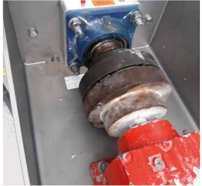
Der Motor (unten) treibt über die Kupplung und das Lager (blau) die Förderschnecke an. Das Lager ist auf der CinchSeal-Wellendichtung montiert.
