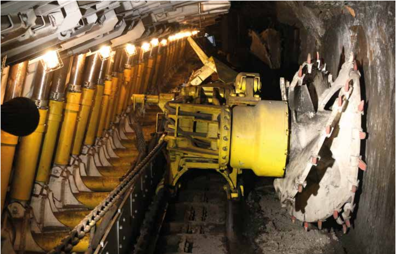
In Walzenladern im Steinkohle-Bergbau sorgen explosionsgeschützte Absolutwertgeber von Hengstler für die optimale Ausrichtung der Schneidwalzen (Foto: Tupungato/shutterstock)
