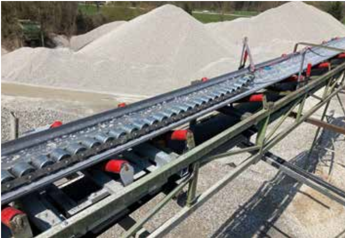
Abgleich einer Bandwaage mit Prüfkette
