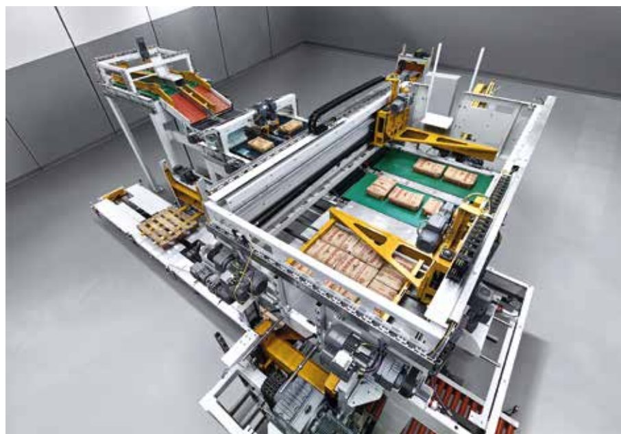
Der Hochleistungslagenpalettierer BEUMER paletpac palettiert pro Stunde bis zu 6.000 Säcke – flexibel, genau und stabil
