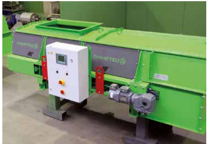
Abbildung 5 – Durchlaufwaage: (links) Schema, (rechts) ODM-GraviSCALE als Durchlaufwaage (Dosieroption ist auch verfügbar)
