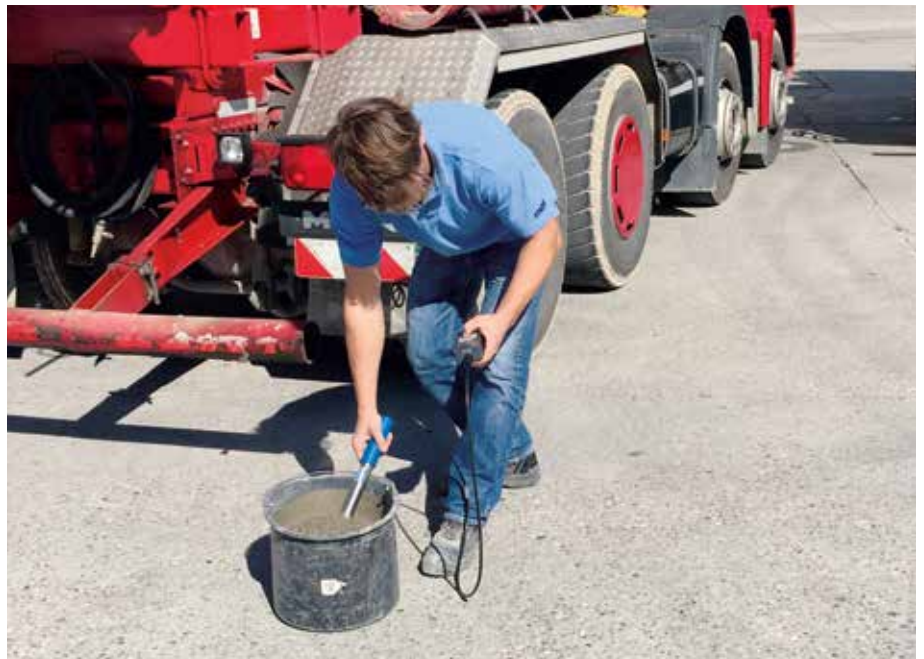
Messung von Frischbeton mit dem SONO-WZ
