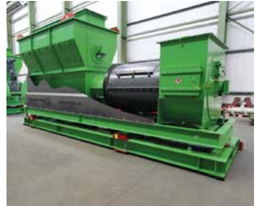
Abbildung 6 – gravimetrische Schüttgutdosierung mit der Rohrwaage – (a): Kernelemente des Systems; (b): Physischer Aufbau
