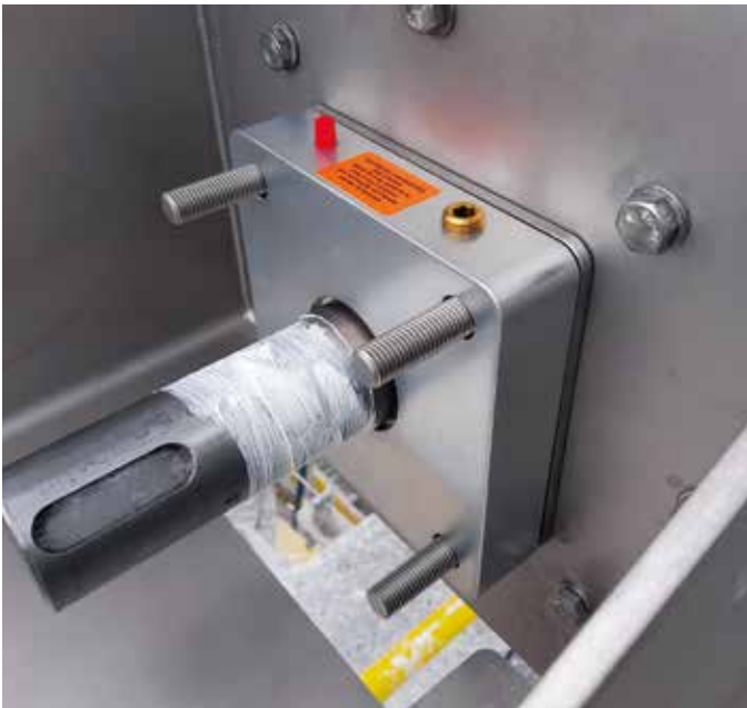
Der gefettete Achszapfen mit montiertem CinchSeal
