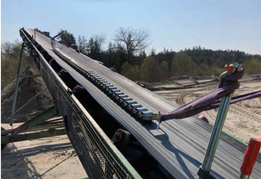
Abgleich einer Bandwaage mit Prüfkette
