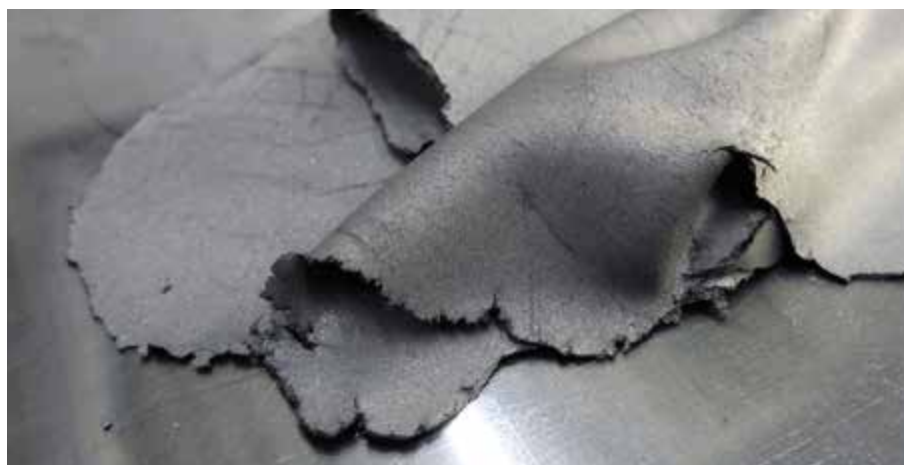
Trockener Elektrodenfilm aus strukturierter Mischung aufbereitet im Eirich-Mischer
