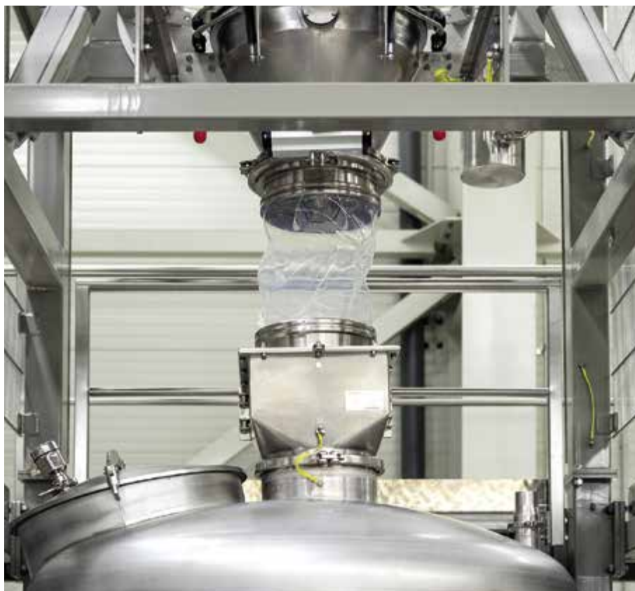
Big Bag-Entleerung mit Anschlussystem für ein leichtes, ergonomisches und vor allem sicheres Austragen von Pulvern
