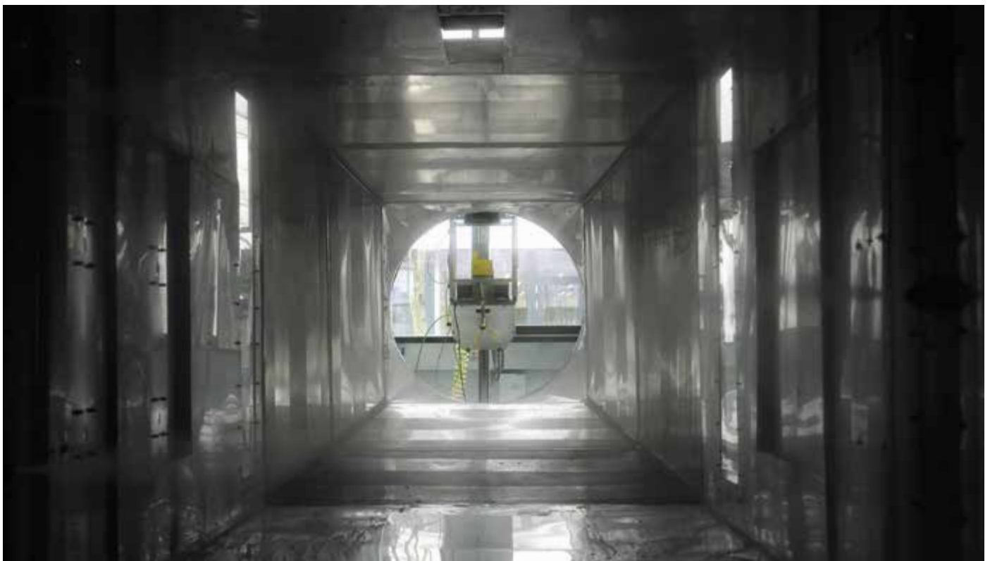
Innenansicht des Windkanals mit Staubabscheidung mittels elektrostatischen Zweistoffdüsen und Stauffreisetzung durch Druckluftdispergierung
