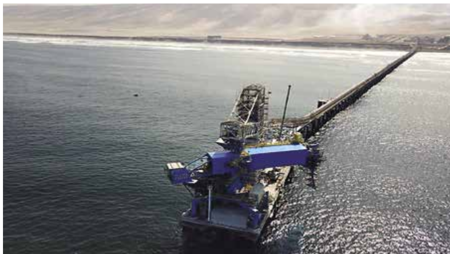
Das Kupfererz gelangt über eine Förderanlage vom Festland zum Schiffsbelader
