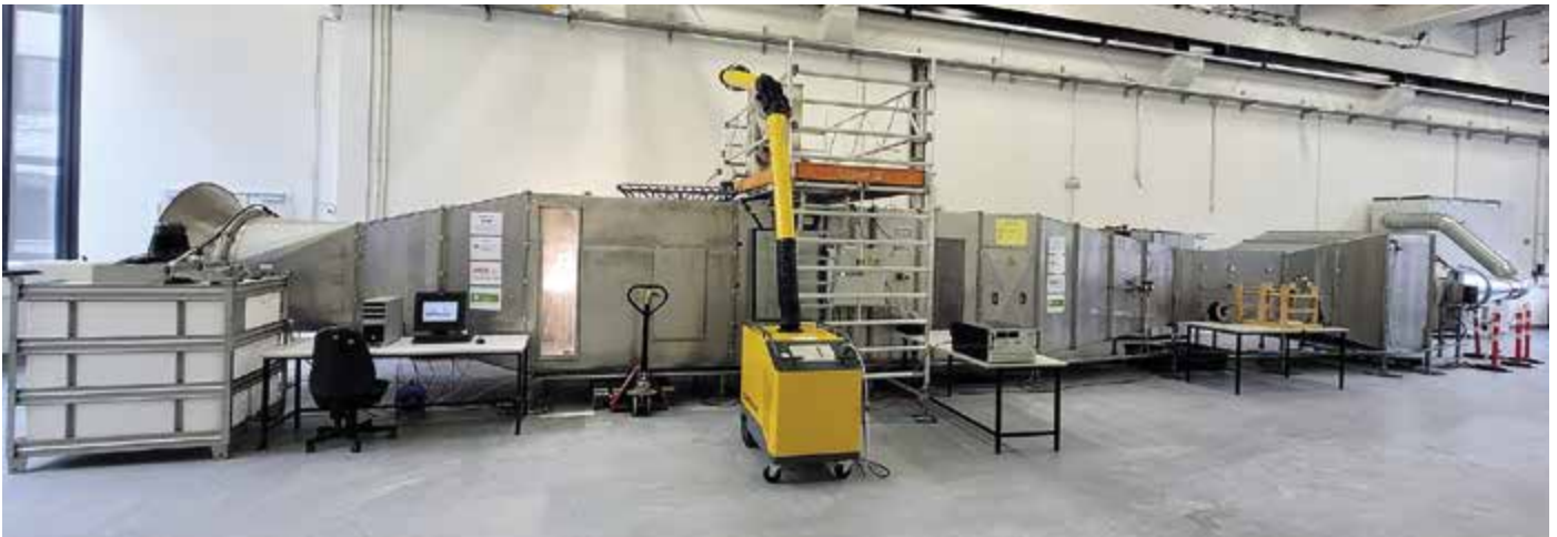
Abbildung 3: Übersicht des verwendeten Windkanalversuchsstandes an der Bergischen Universität Wuppertal
