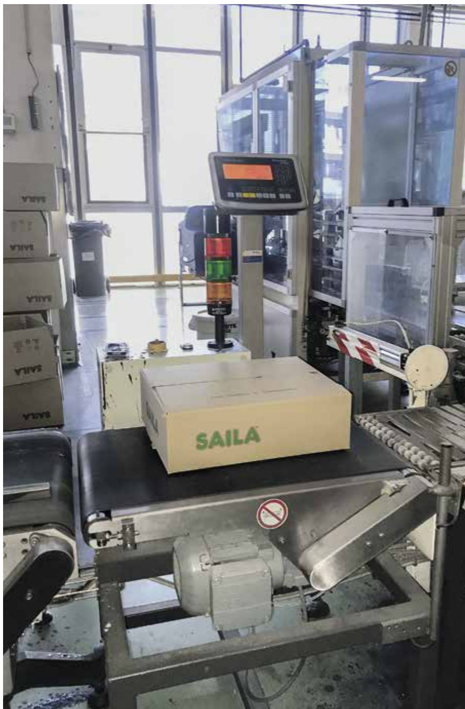
Das Wäge- und Auswahlssystem Essentus® sorgt dafür, dass alle Schachteln die richtige Anzahl an Süßwarenpackungen enthalten
