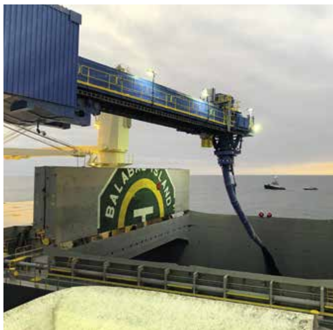
Über ein schwenkbare Teleskoprohr gleitet das Material nach unten in den Laderaum
