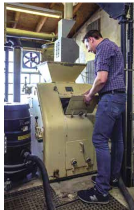
Nicht nur im Umfeld des Saugers kann gesaugt werden, sondern auch im Geschoss darunter, denn der Sauger ist über eine Rohrleitung mit einem Absaugarm am Schüttelsieb verbunden
