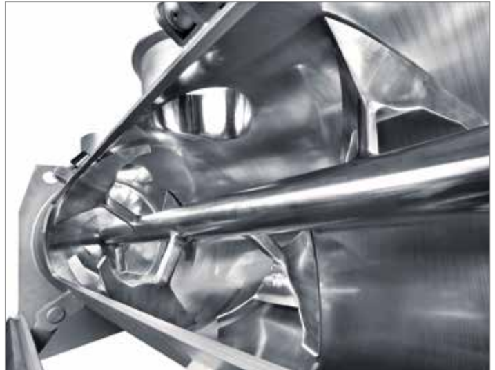
Lödige Pflugschar®-Mischer für kontinuierlichen Betrieb, Typ KM 150 zur Herstellung von Fondant
