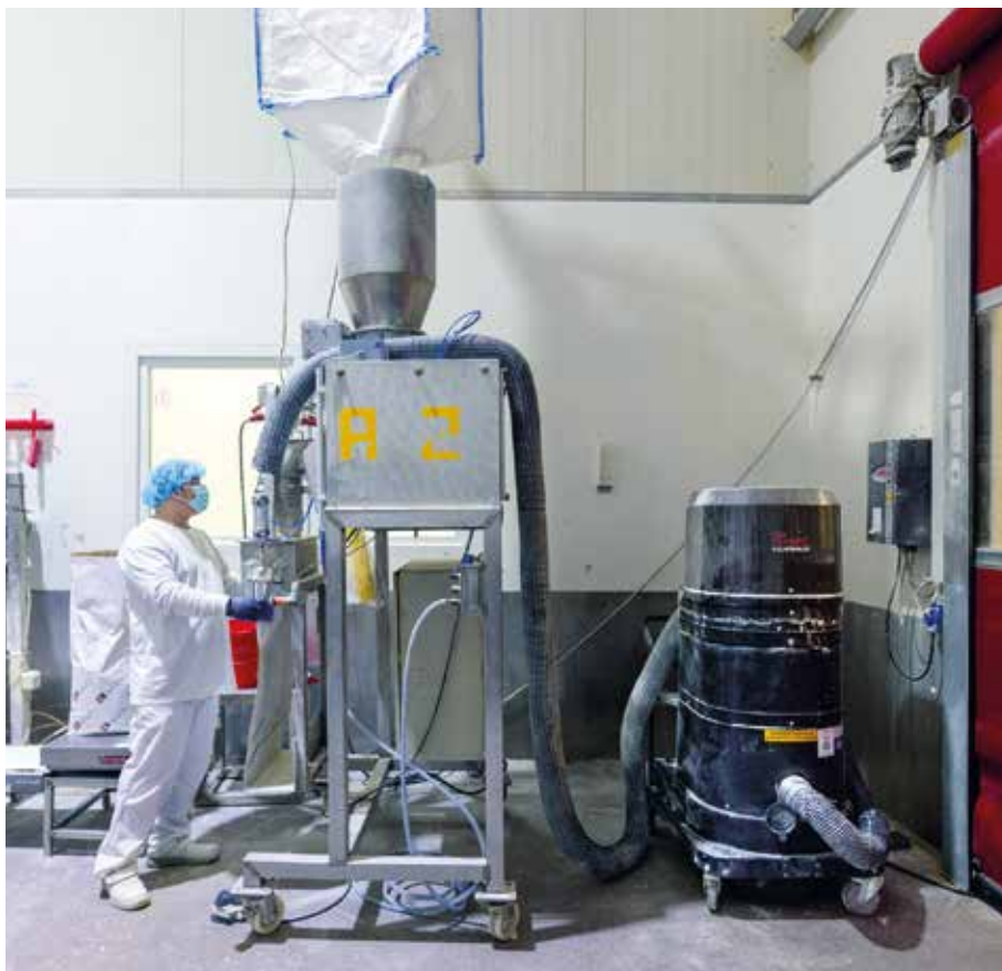
Auch an der Abfüllung, der letzten Station des Produktionsprozesses, kommt ein Ruwac-Sauger zum Einsatz
