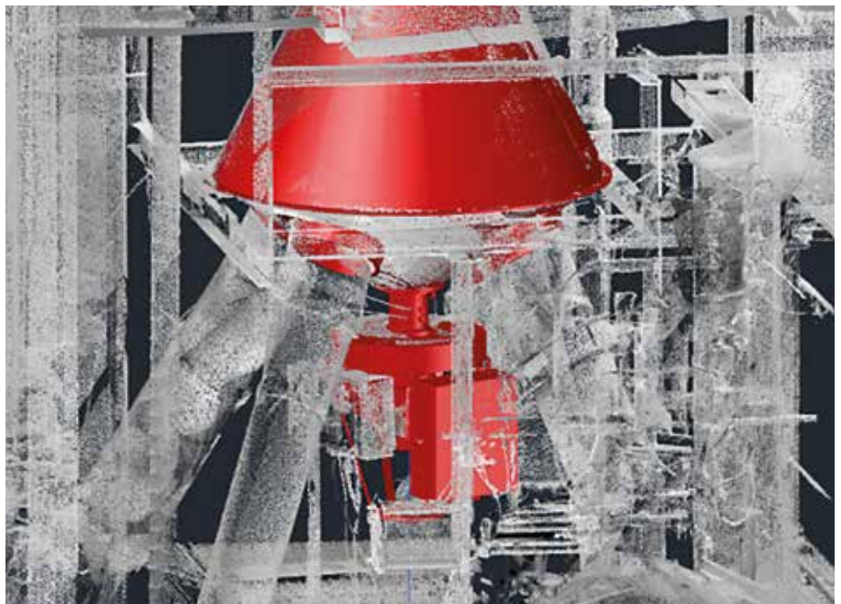
Alle Schnittstellen im Produktionsturm wurden im Millimeterbereich aufgenommen
