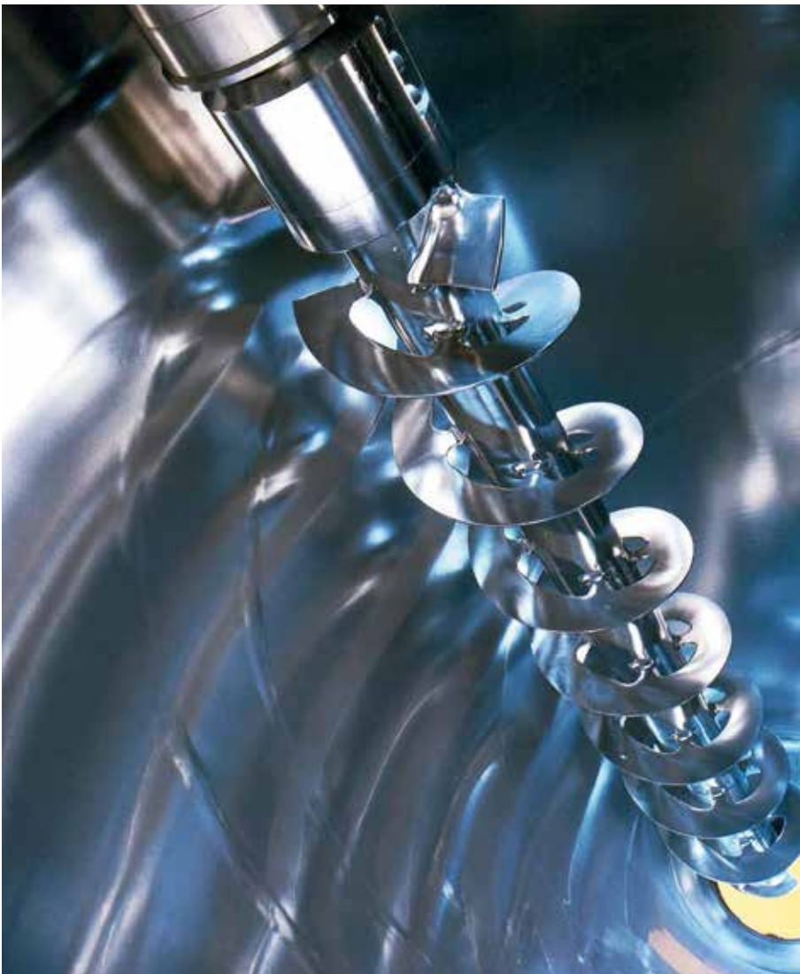
Die Mischschnecke im Konus-Schnecken-Mischer
