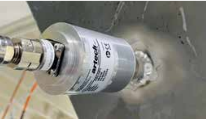
Bild 3: Ultraschallkonverter am Aluminiumtrichter
