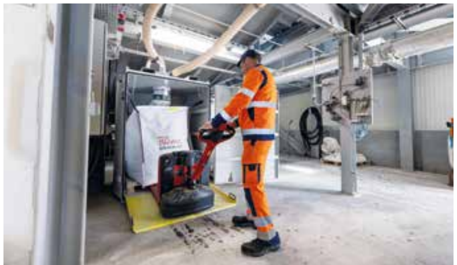
Die jetzt nachgerüstete Vakuumszelle erleichtert die Rückführung des aufgesaugten Recyclingmaterials in den Produktionsprozess
