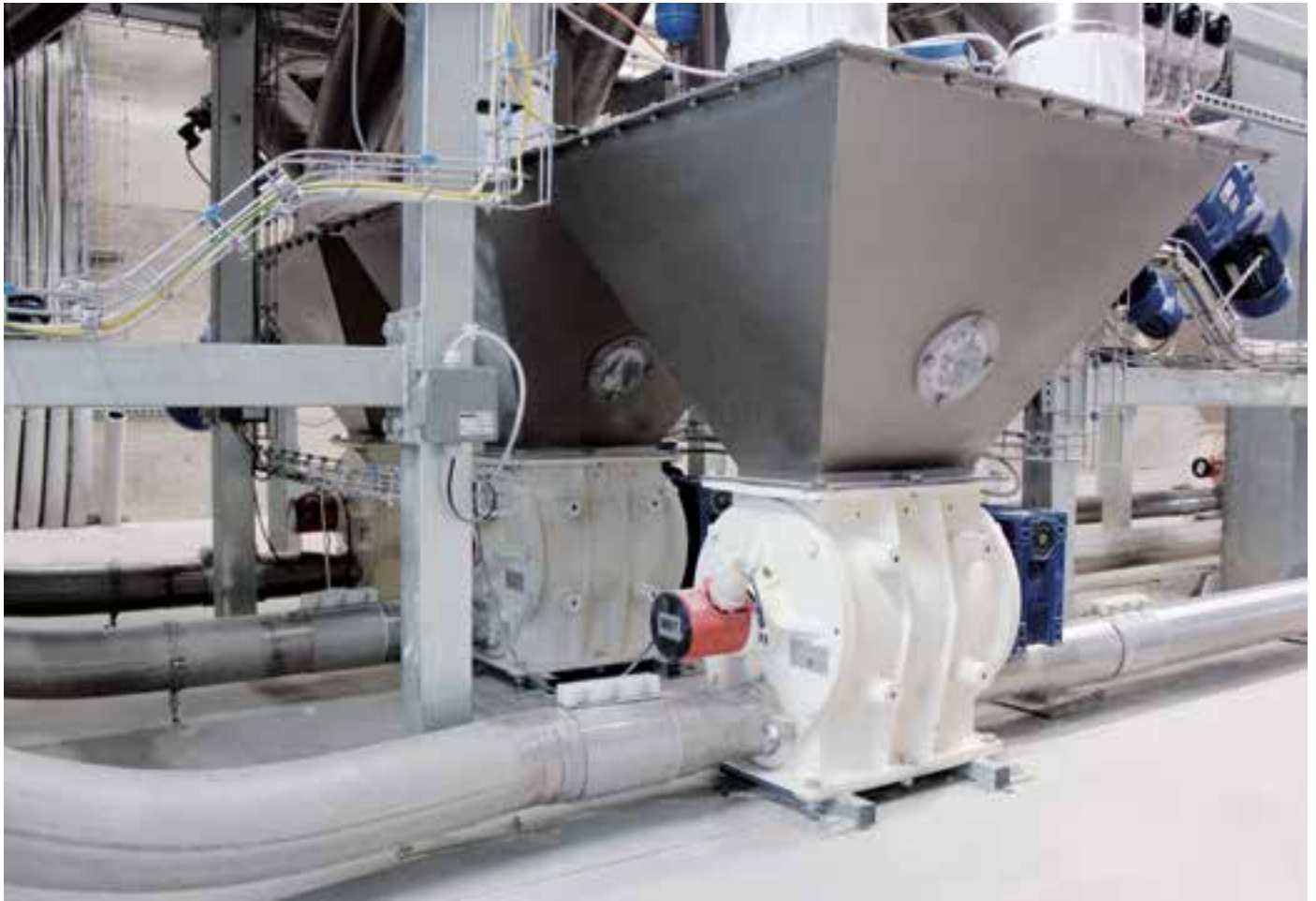
Aufgabebehälter und Zellenradschleuse in der Pasta-Fabrik Ghigi 1870 im italienischen Riccione
