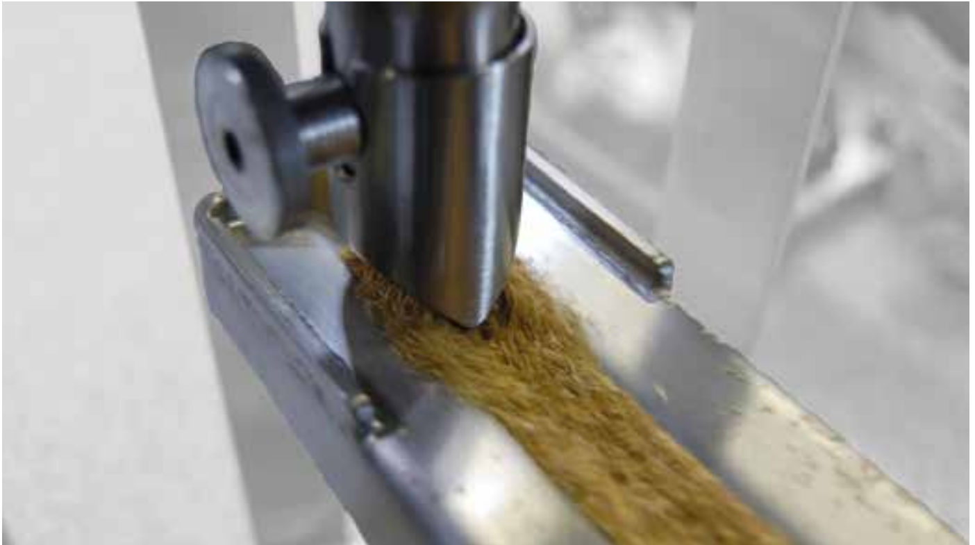
Vibrationstechnik kann Schüttgüter besonders schonend, genau und zuverlässig fördern (Bild: NetterVibration)
