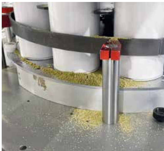
Bild 2: Unsaubere Dosierung führt zu Produktverlust (Anwendung B)
