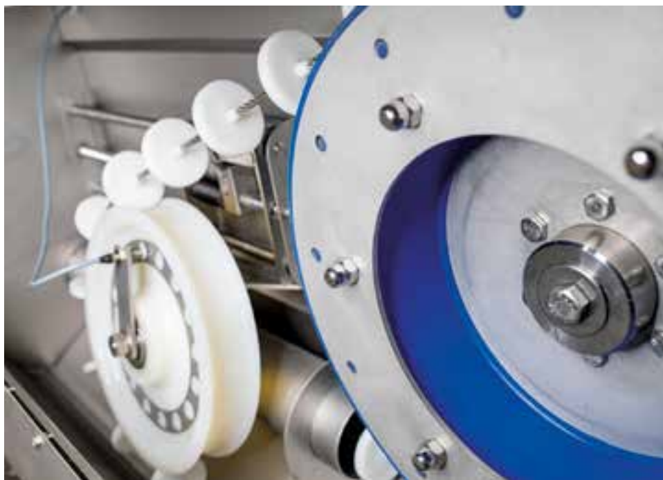
Das neue 2K-Frictionsrad besteht aus einer Edelstahl-Polyurethan-Kombination.
