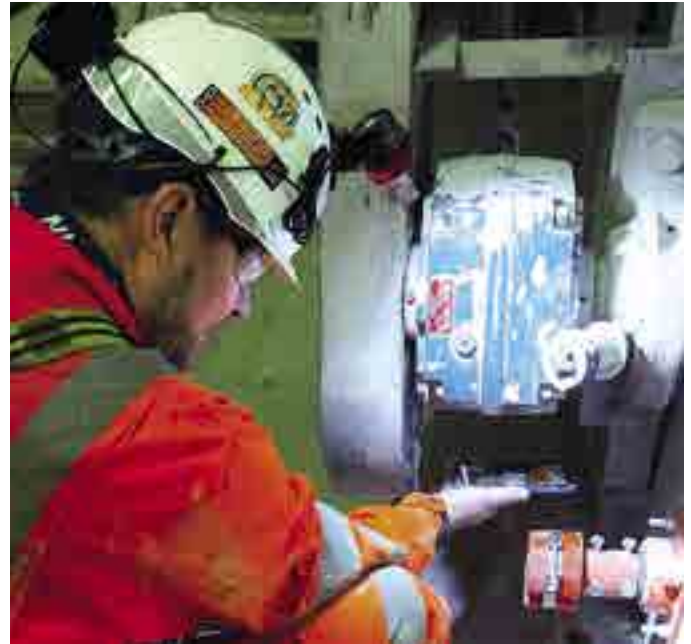
Kalibrierung eines der neu installierten N2 PI-Förderbandreiner Smart Monitoring Devices mit der Martin Mobile App
