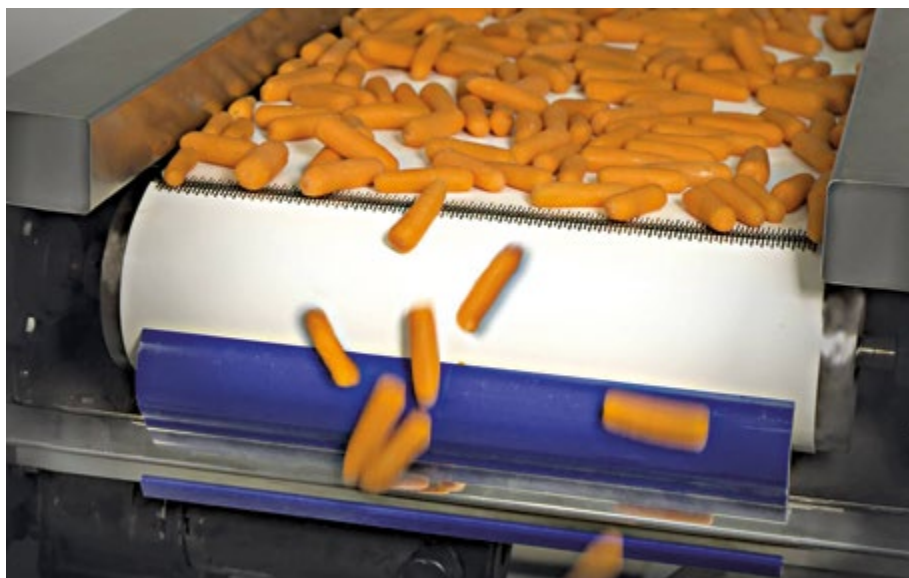
Eine Förderbandanlage für den Transport frisch geschälter Karotten
