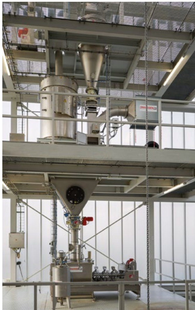
Materialfluss über mehrere Ebenen erlaubt vielfältige Testaufbauten
