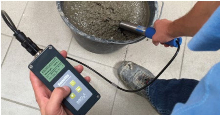
Messung einer Eimerprobe mit der SONO WZ
