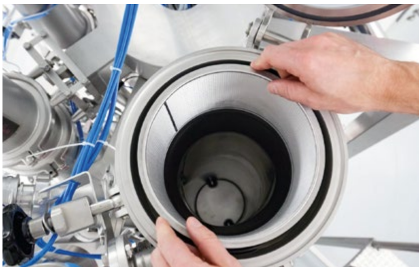
Einfacher Filterwechsel am Vakuumförderer PCC
