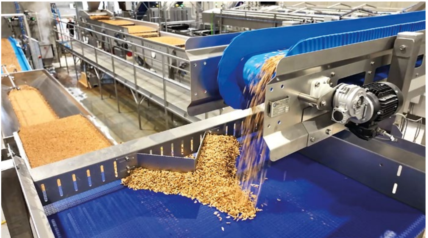
Beispiel einer End-of-Line-Installation, die 9–10 Tonnen pro Stunde gemischtes BSF-Larven und -Frass verarbeitet
