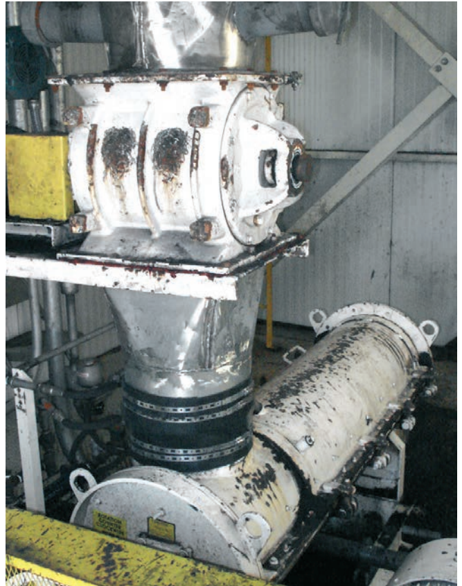
Bild 2: Je mehr gegen die Wandungen gehämmert wird, desto schlechter wird die Situation, weil die schweren Schläge nach innen gerichtete Aufwölbungen und Stege in der Wandung verursachen. In Folge nehmen die Flussprobleme zu.
