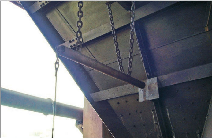
Bild 1: Die „klassische“ Lösung bei Materialflussproblemen: mit einem Rammbock, einem Hammer oder einem anderen schweren Gegenstand von außen auf die Wandung einschlagen
