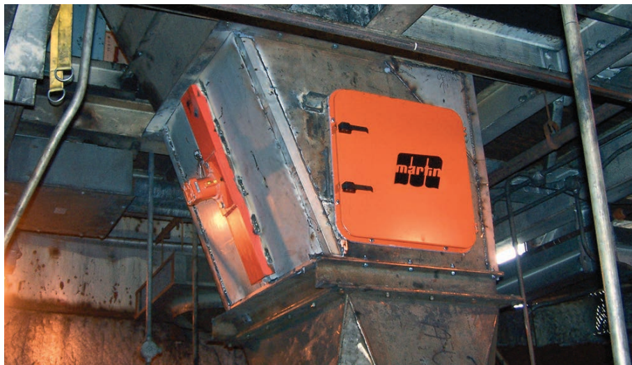
Bild 6: Ein Kolbenvibrator sollte auf einer Stahlprofilhalterung montiert werden, die auf der Schurrenaußenseite an der Stelle angebracht ist, wo der Materialaufbau vorliegt
