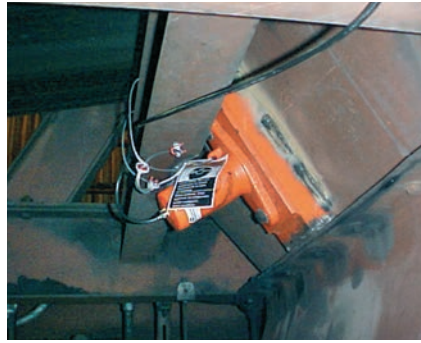
Bild 4: Der Kolbenvibrator wurde entwickelt, um diese Wirkung zu erzielen, ohne tatsächlich einen Hammer schwingen zu müssen
