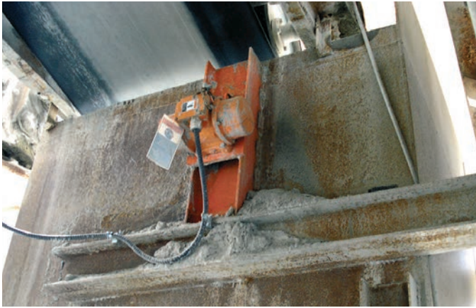
Bild 9: Rotationsvibratoren werden normalerweise auf einer Montageplatte oder einer Profillagerung montiert, die die Vibrationsenergie und das Gewicht des Geräts über eine größere Oberfläche verteilt
