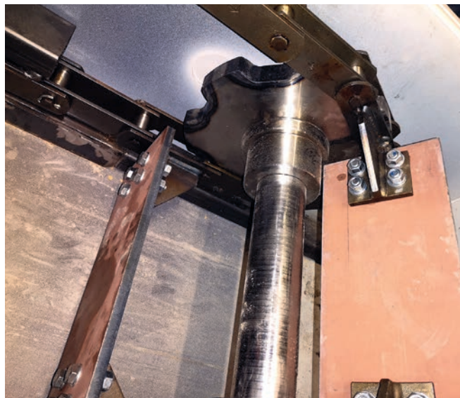
Wendbare Kettenräder mit selbstreinigenden Zahnluken
