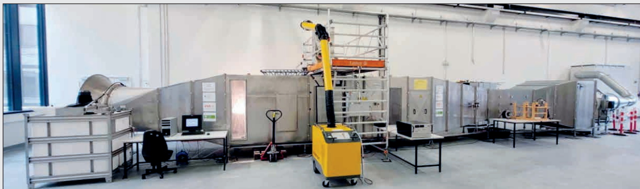
Abbildung 3: Genutzter und erweiterter Windkanal mit Aufbauten für Stauffreisetzung und Stauffabscheidung. Quelle: Abschlussbericht IGF Projekt 21821 N1.
