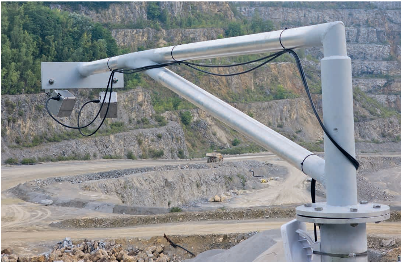
OWL EYE® Dual-Plattform im Steinbruch erfasst Halden über mehrere hundert Meter in Echtzeit Fotos: © Sachtleben Technology GmbH
