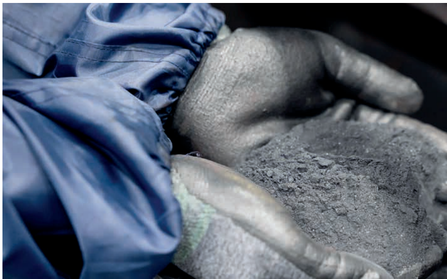
Die schwarze Masse ist das Pulver, das in der Batterieherstellung verwendet wird. Es ist ein Gemisch wertvoller Batterieminerale.
