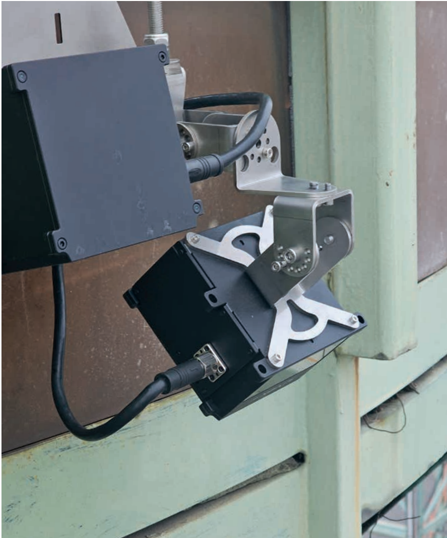
OWL EYE® Dual mit HAP-System im Stahlwerk – berührungslose Schlackevermessung trotz Hitze, Staub und großen Materialvolumina
