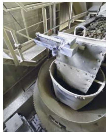
Hochdynamische Füllstandmessung bei Staubbildung und Vibration
