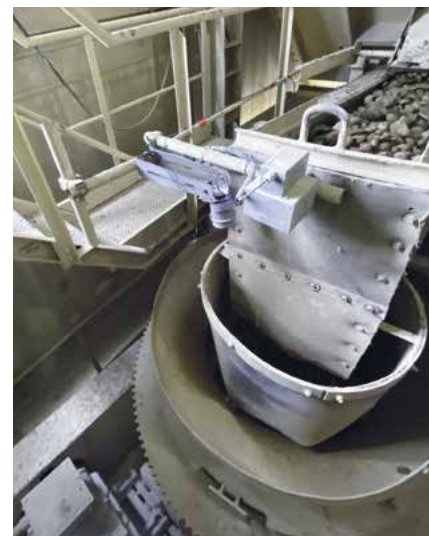
Hochdynamische Füllstandmessung bei Staubbildung und Vibration
