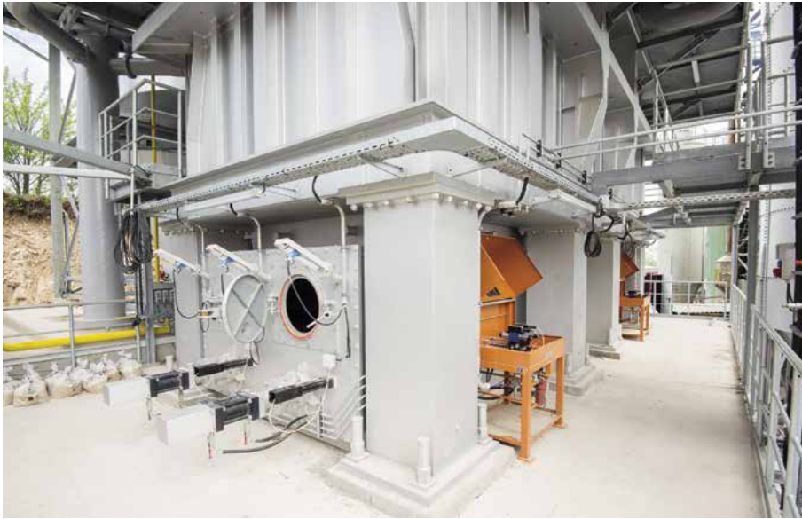
GGR-Ofen mit Zugängen zum Ofenaustrag
