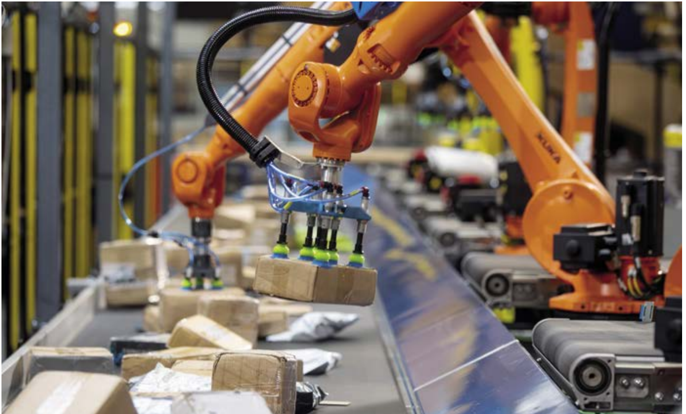
BEUMER robotpick ist ein autonomes robotisches Picking- und Vereinzelungssystem für Paket-Hubs (© BEUMER Group GmbH & Co. KG)
