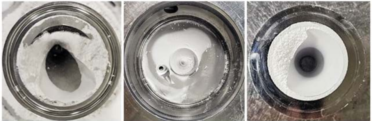
Abb. 1 Anhaftung von Laktose an unterschiedlichen Komponenten einer Laborspiralstrahlmühle. (Dibrova, S.; Breitung, S. (2026): Anhaftungsverhalten trockener feiner Pulver in fluidisierten Systemen. Jahrestreffen DECHEMA/VDI, Dresden)
