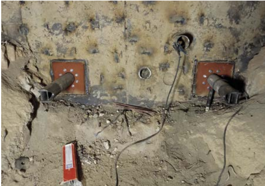
Rapid-Change-Kopf im Ofeneinlauf Zement
