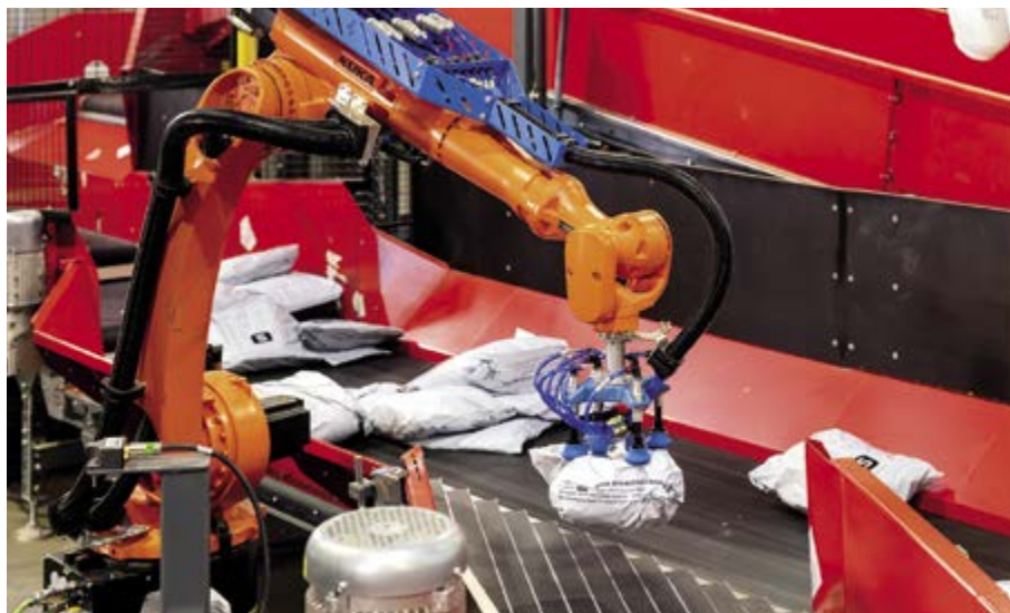
Der Roboter passt seine Bewegung und Vakuumgreifstrategie an die Päckchengröße und die Eigenschaften des Pakets an. (© BEUMER Group GmbH & Co. KG)
